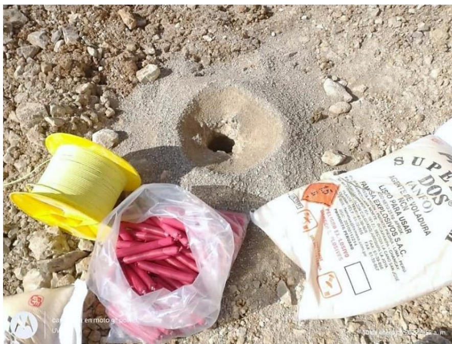
Figura 19. Cargado de Taladros
