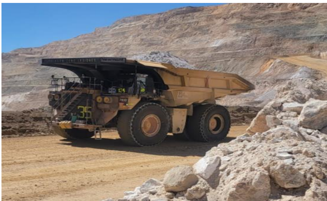
Figura 36. Acarreo de mineral con camión CAT 793
