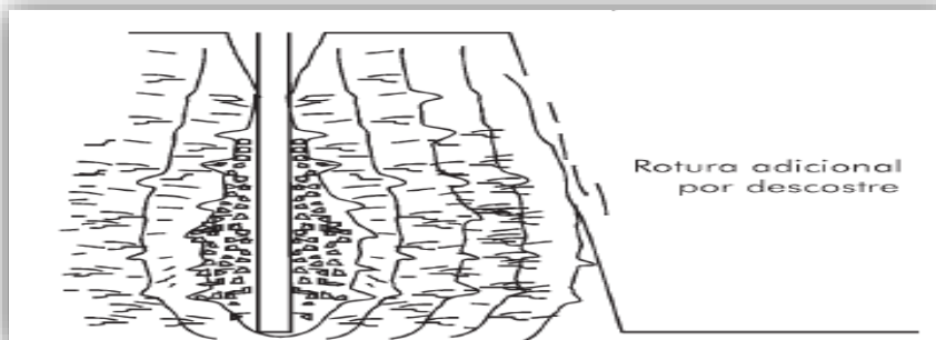
Figura 4. Fase 03 rotura de expansión.
