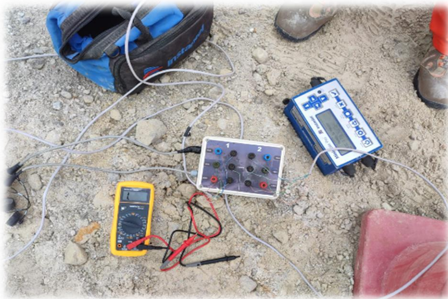
Foto 3 Instalación de sismógrafo.
