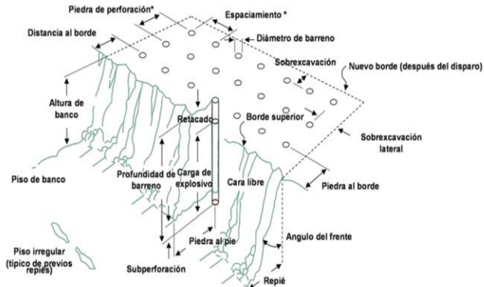
Figura. 14 Componentes de una malla de perforación.
