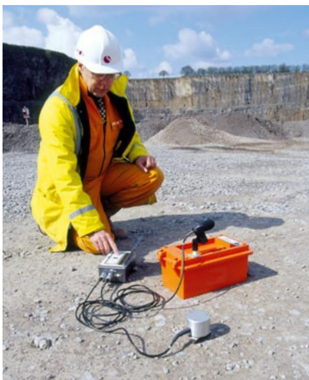
Figura 10. Sistema de iniciación eléctrica. Fuente: Bernaola, Catilla y Herrera (2013)
