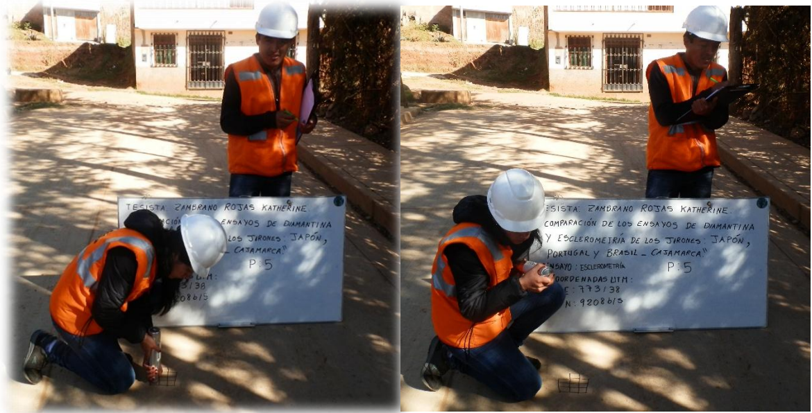
Imagen Nº 15: Ensayo de Esclerometría P-5, Cuadra 1 del Jr. Brasil.
