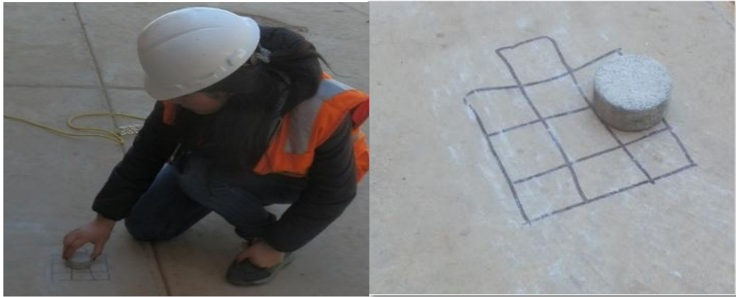
Imagen N° 12: Pulido superficial en la zona de prueba para realizar el ensayo de esclerometría - Cuadra 1 del Jr. Brasil
