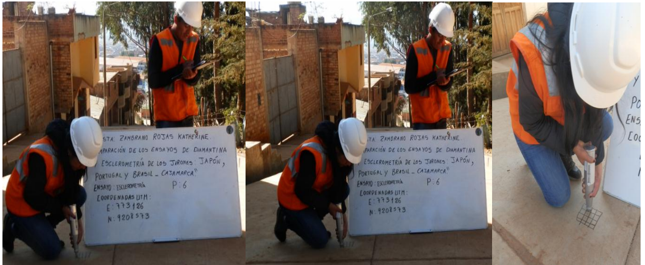
Imagen Nº 16: Ensayo de Esclerometría P-6 Cuadra 1 del Jr. Brasil.
