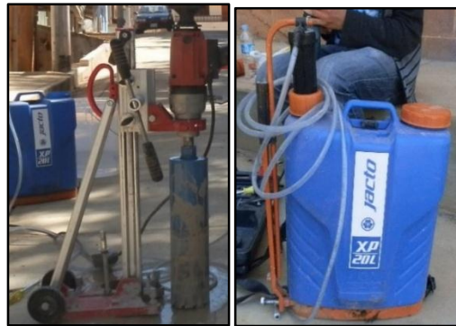
Imagen N° 7: Equipo sonda provisto de brocas diamantadas provisto de tanque de agua.
