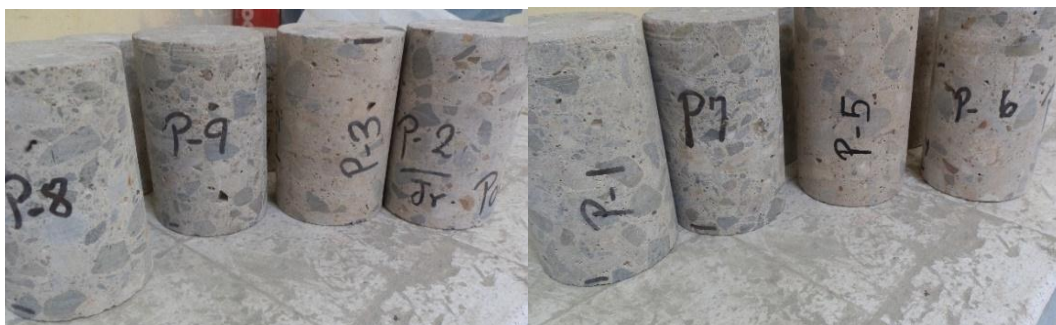
Imagen N° 22: Especímenes aserrados o esmerillados
