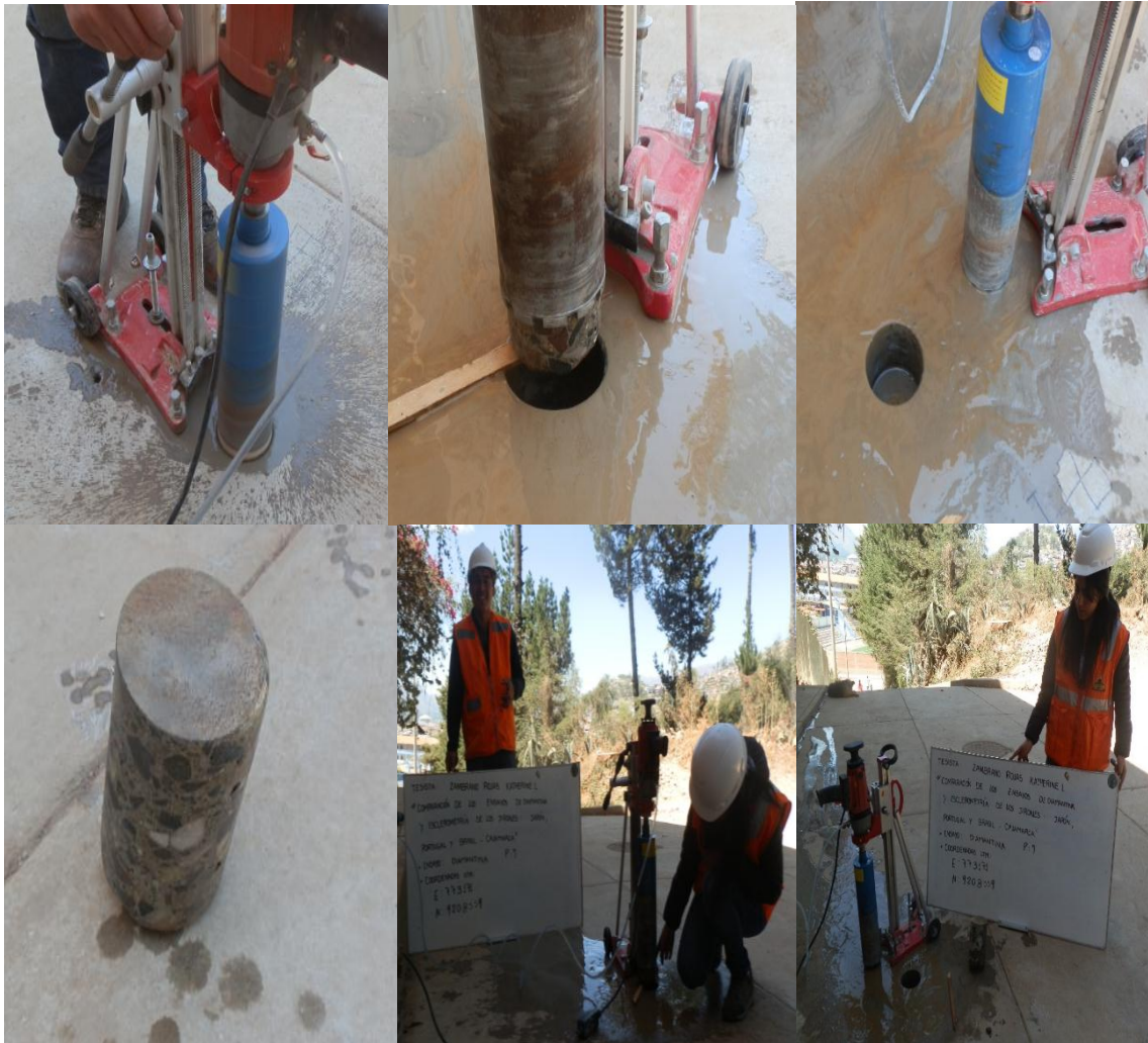
Imagen N° 19 Extracción del espécimen de Concreto P-7 - Cuadra 1 del Jr. Japón.
