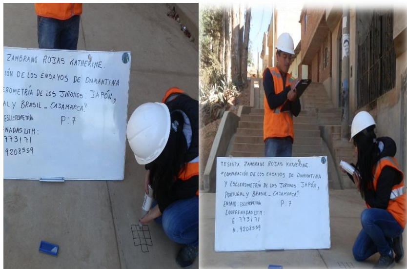
Imagen N° 17 Ensayo de Esclerometría P-7 y lectura del número de rebote en la escala al número entero más cercano- Cuadra 1 del Jr. Japón.
