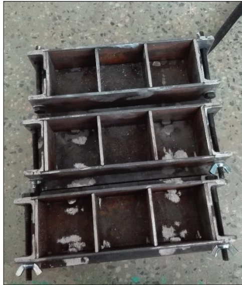
Foto 06: Moldes para probetas prismáticas cuadradas de mortero
