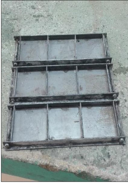
Foto 13: Moldes para probetas de mortero – ensayo autolimpiable
