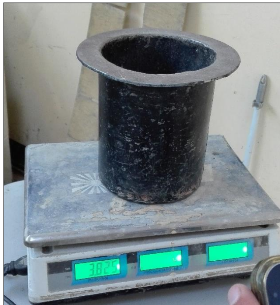
Foto 05: Peso del molde para peso unitario suelto seco y compactado del agregado
