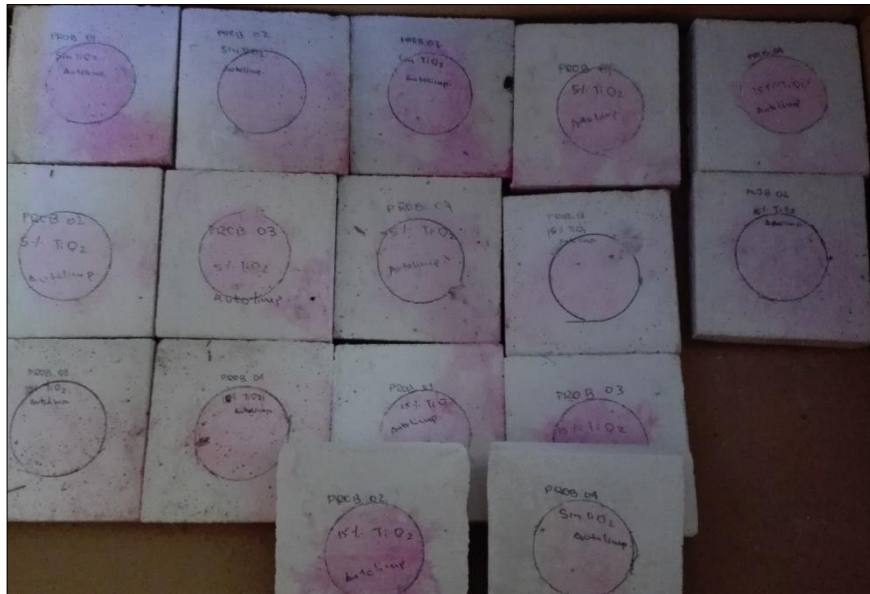
Foto 27: Probetas con Rodamina B expuestas a rayo UV por t = 4 h
