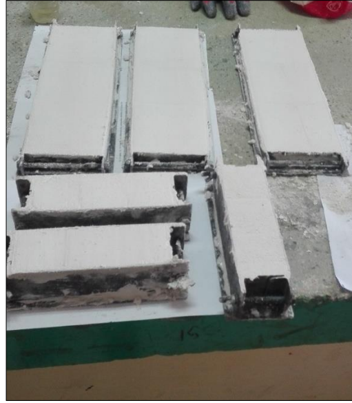
Foto 14: Probetas de mortero para ensayo a compresión y autolimpiable
