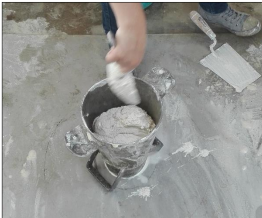
Foto 21: Colocación de mezcla en cono invertido
