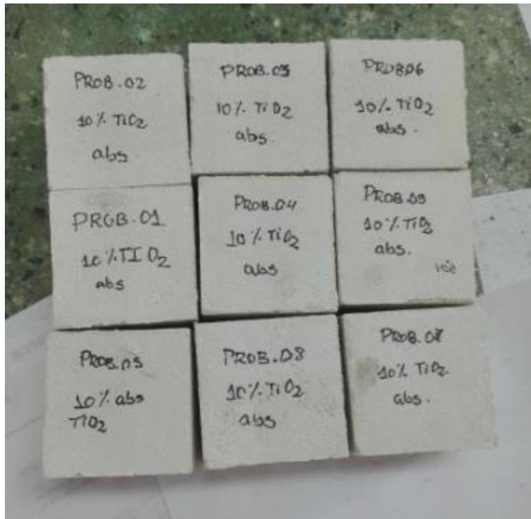
Foto 15: Probetas para ensayo de absorción con 10% de TiO 2
