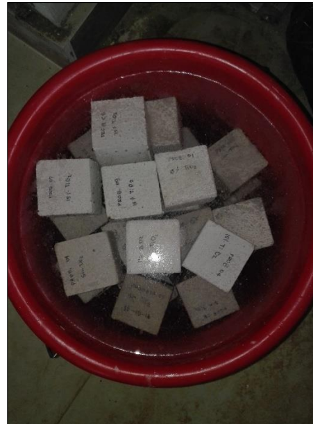
Foto 10: Curado de probetas de mortero para resistencia
