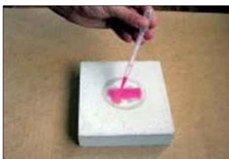
Figura 6: Aplicación de la solución de rodamina en la superficie de la muestra. (Norma UNI 11259).
