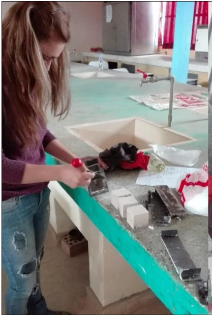
Foto 09: Desencofrado de probetas
