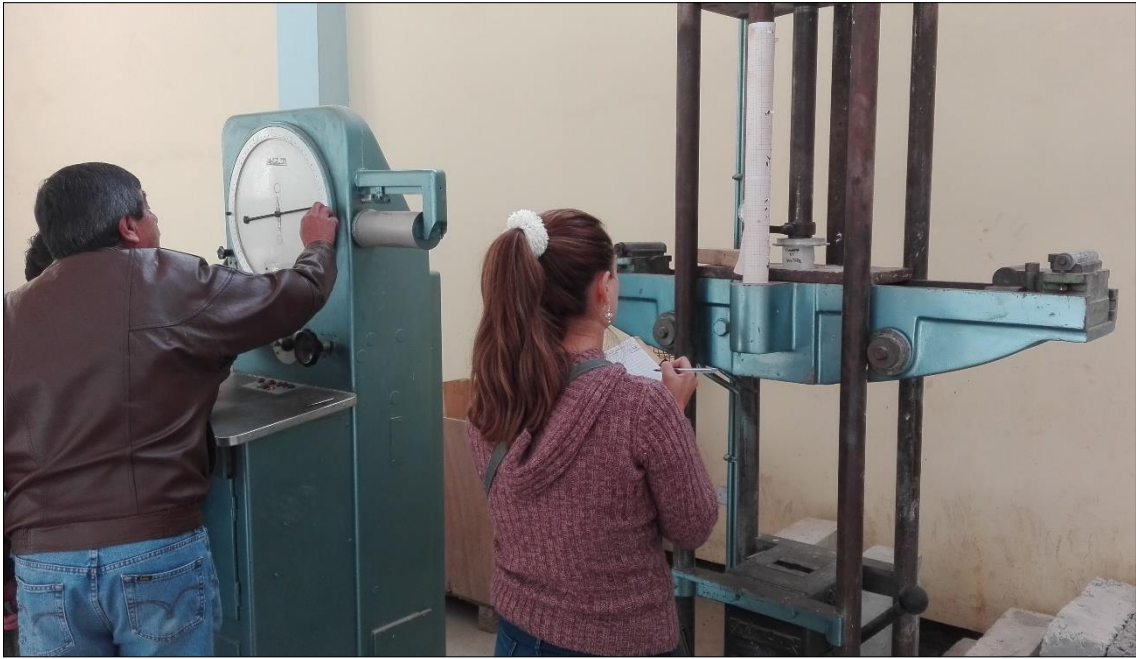
Foto 18: Anotando deformaciones totales que sufre la probeta de mortero
