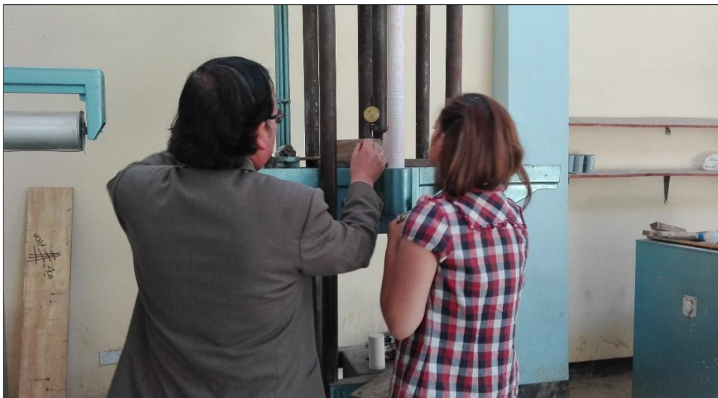
Foto 17: Colocando deformímetro en cero
