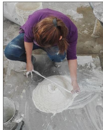
Foto 22: Medición del diámetro de la mezcla
