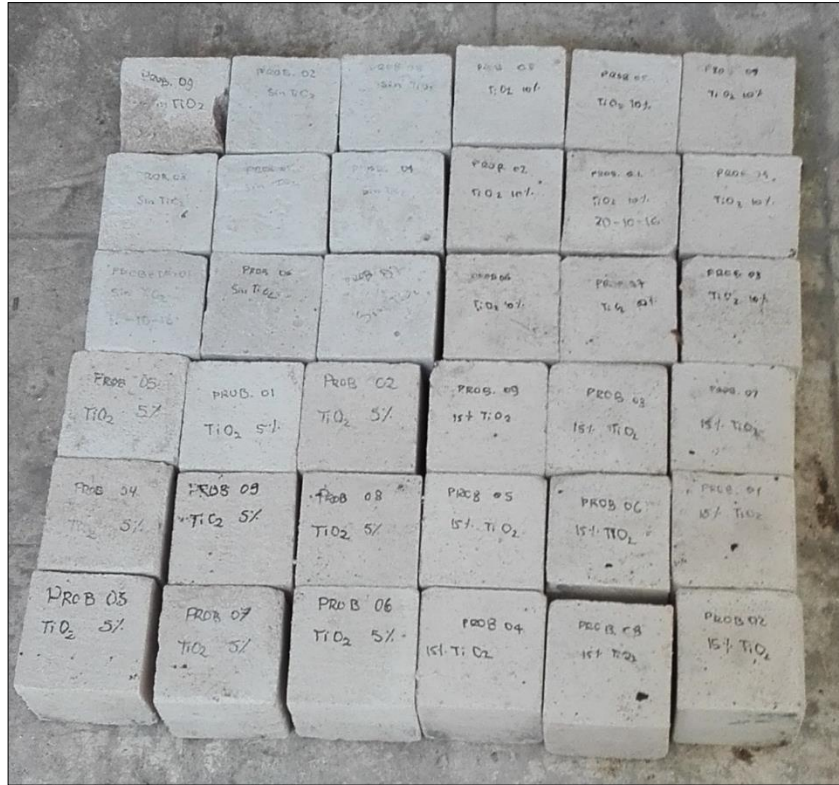
Foto 16: Probetas para ensayo de resistencia a la compresión
