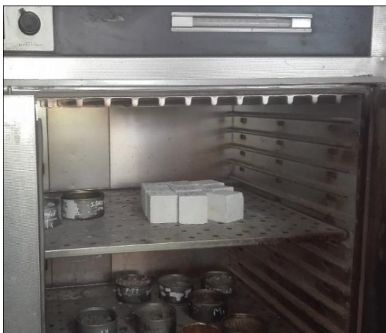
Foto 11: Colocación de probetas en el horno
