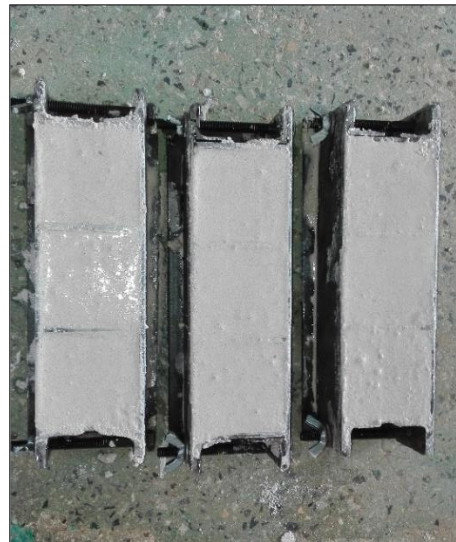
Foto 08: Llenado de probetas de mortero en estado fresco
