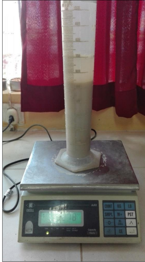
Foto 04: Determinación de los pesos específicos del agregado fino
