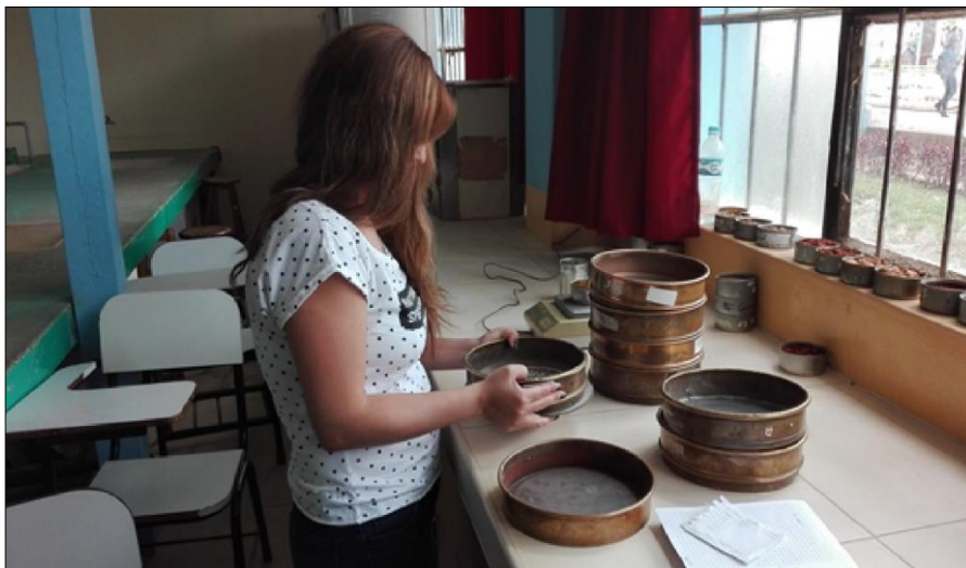
Foto 03: Granulometría de la arena con los diferentes tamices normalizados
