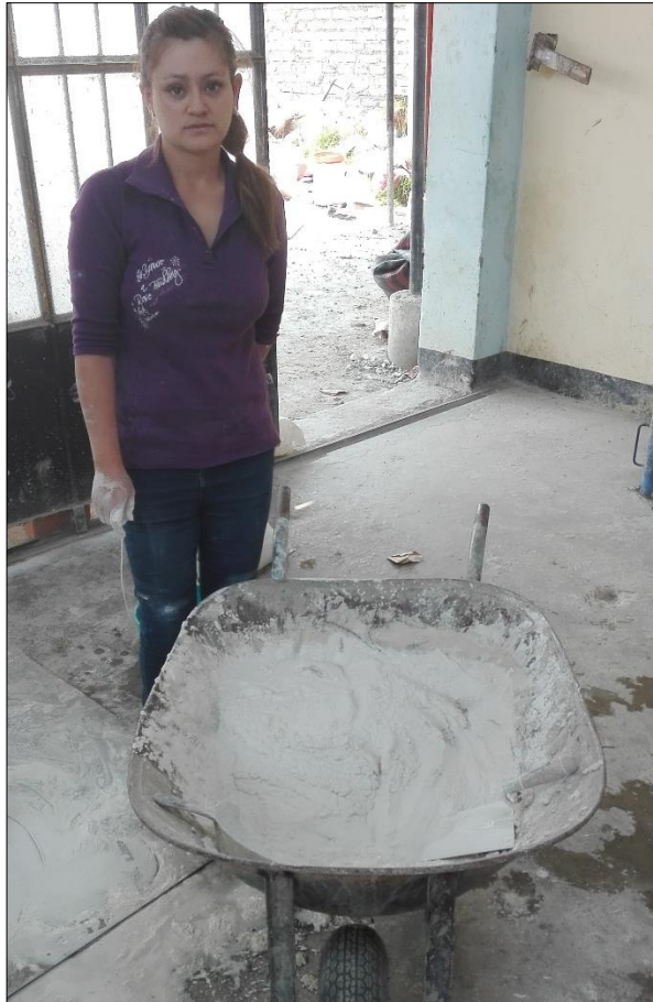
Foto 20: Mezcla de mortero para determinar la fluidez
