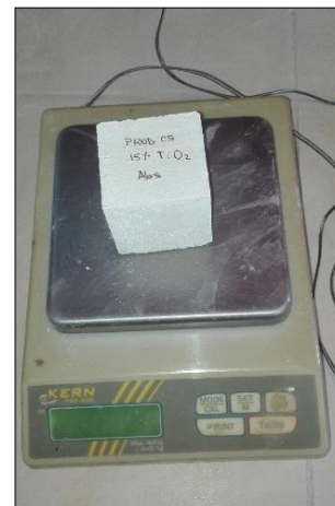
Foto 12: Peso de probeta seca
