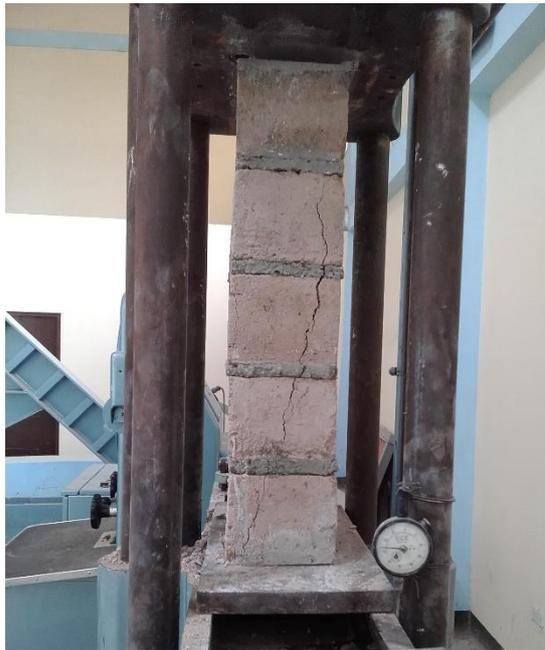
*Fig. 27 Falla ideal de una pila PLCR.*
