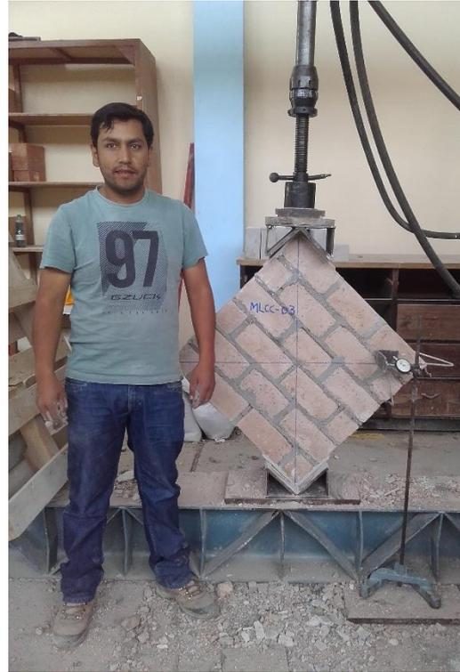
*Fig. 32 Ensayo a compresión diagonal en muretes.*
