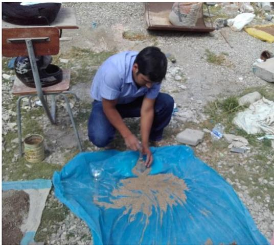
**Fig. 41** Preparación de la muestra hasta la condición superficialmente seca.
