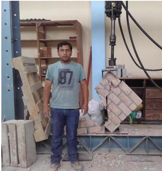
*Fig. 33 Falla mixta por corte y tracción diagonal.*
