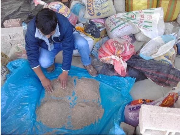
**Fig. 39** Selección de la muestra por método del cuarteo.
