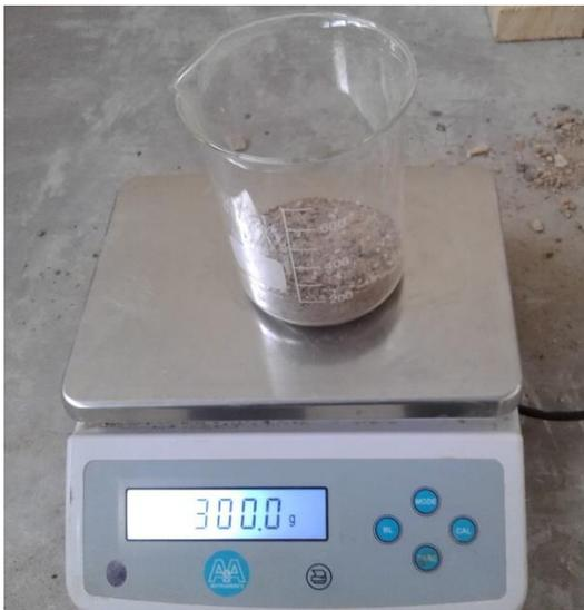
**Fig. 37** Pesado de la muestra seca (ensayo de partículas menores al tamiz N° 200).
