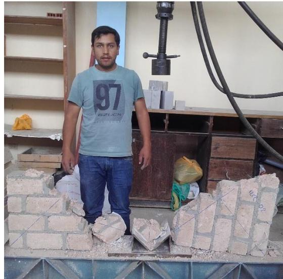
*Fig. 34 Falla mixta por tracción diagonal y corte escalonada.*
