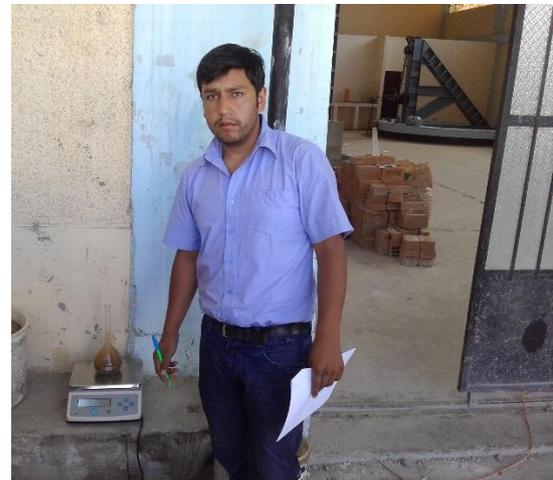
**Fig. 42** Pesado del picnómetro lleno de la muestra más el agua.
