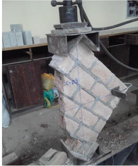
**Fig. 36** Falla mixta corte y tracción diagonal MLCC - 03.
