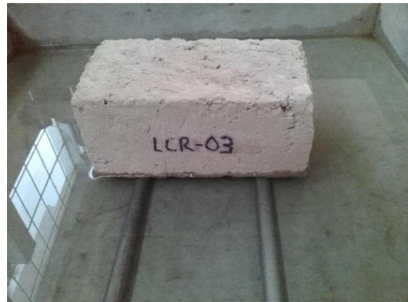
**Fig. 20** Ensayo de succión, colocación del espécimen en contacto con el agua por 1 minuto.
