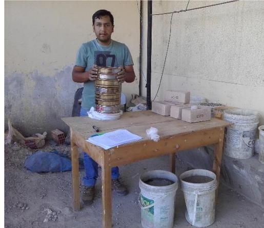
**Fig. 40** Proceso del tamizado (Análisis granulométrico).
