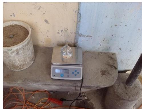
**Fig. 44** Pesado de fiola más agua, para el cálculo de peso específico del agua.
