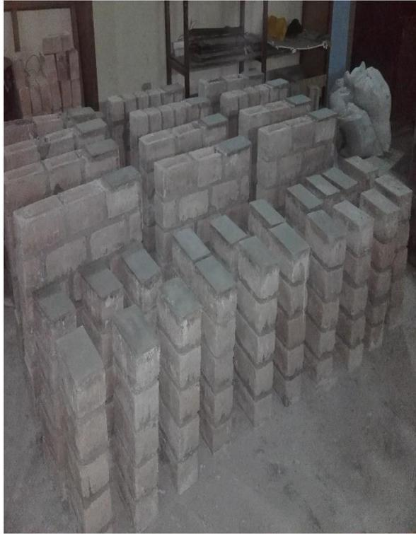
*Fig. 31 Muretes refrentados con yeso cemento.*
