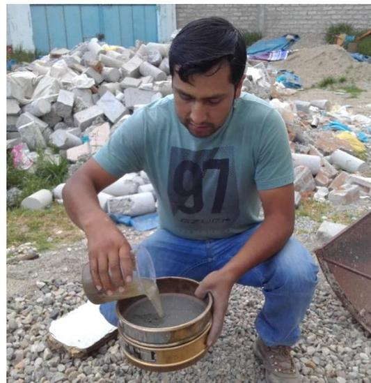
**Fig. 38** Lavado y tamizado de la muestra.
