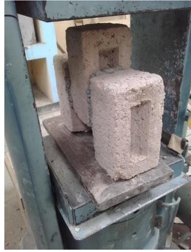
**Fig. 48** Ensayo de adherencia TLC.
