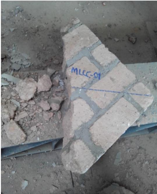
**Fig. 35** Falla por tracción diagonal.
