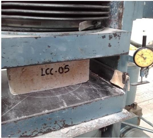
**Fig. 15** Ensayo a compresión del espécimen LCC
