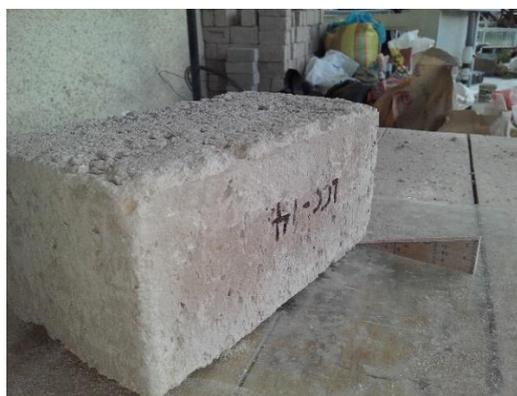
*Fig. 14 Medición del alabeo LCC - 14*
