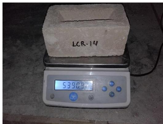
*Fig. 10 Pesado del espécimen LCR -14 y registro del peso recibido ( $W_r$ ).*
