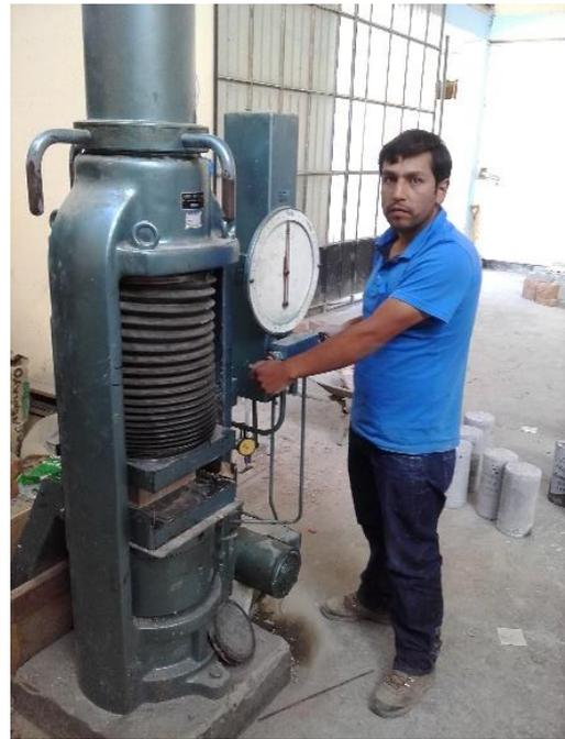
**Fig. 16** Ensayando los ladrillos a
