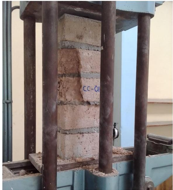
*Fig. 28 Falla por aplastamiento por pandeo.*
