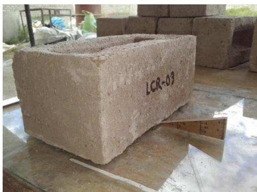
*Fig. 13 Medición del alabeo LCR - 03*
