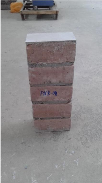
*Fig. 23 Pila refrentado para ser ensayado.*
