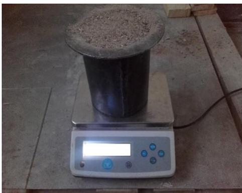
**Fig. 43** Pesado de recipiente metálico más la muestra para el cálculo del PUS.
