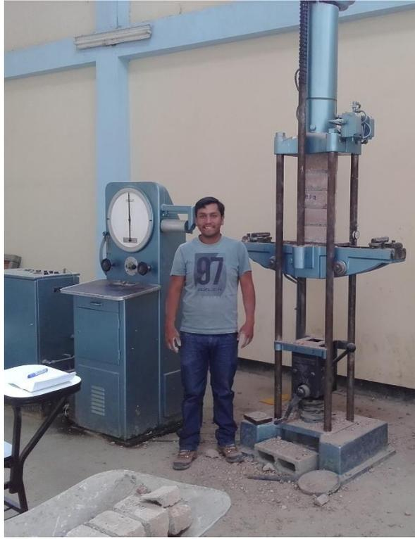
*Fig. 24 Ensayo a compresión axial en pilas.*
