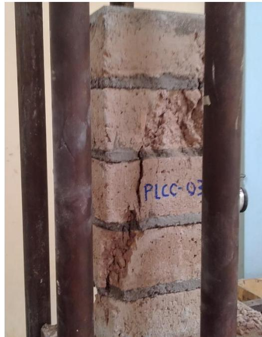
*Fig. 26 Falla aplastamiento local en pila.*
