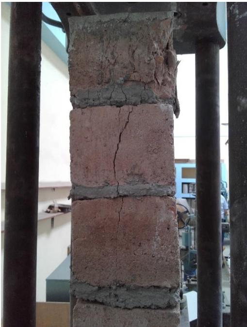
*Fig. 25 Falla ideal de una pila PLCC.*
