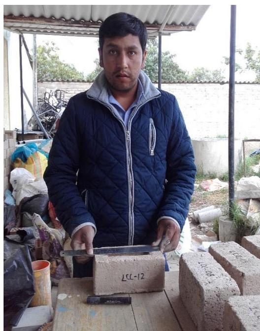
*Fig. 12 Toma de dimensiones en las unidades ladrillera El Ciprés.*
