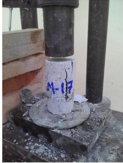
**Fig. 46** Falla de espécimen de mortero.
