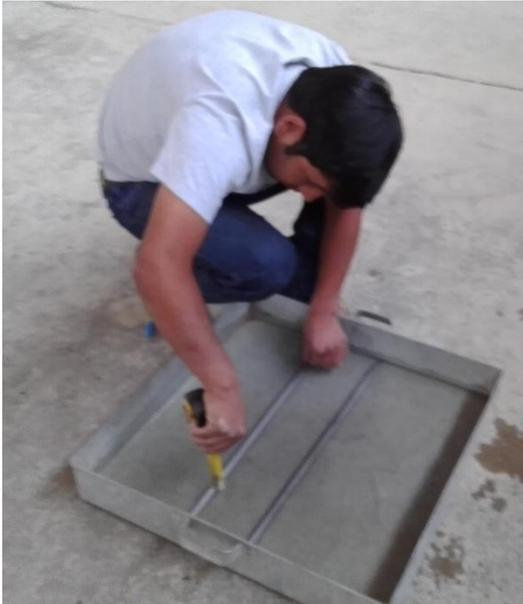
**Fig. 19** Control de la altura del agua sobre las varillas en el ensayo de succión.
