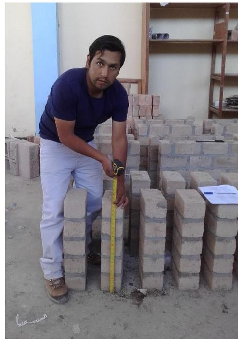
**Fig. 22** Toma de dimensiones de pilas para el cálculo de la esbeltez.
