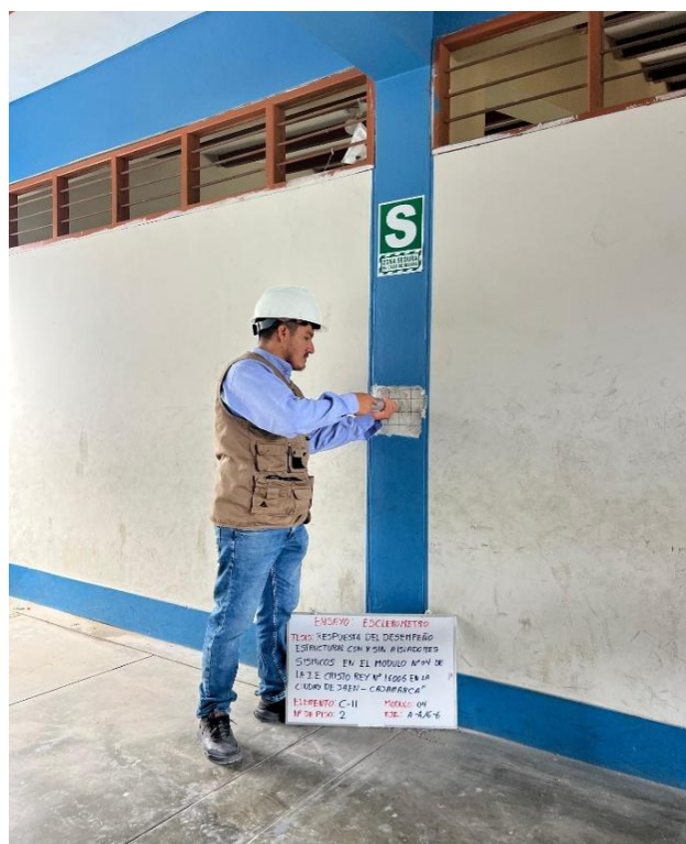
Figura 103. Se realizó el ensayo no destructivo con esclerómetro, en columnas
