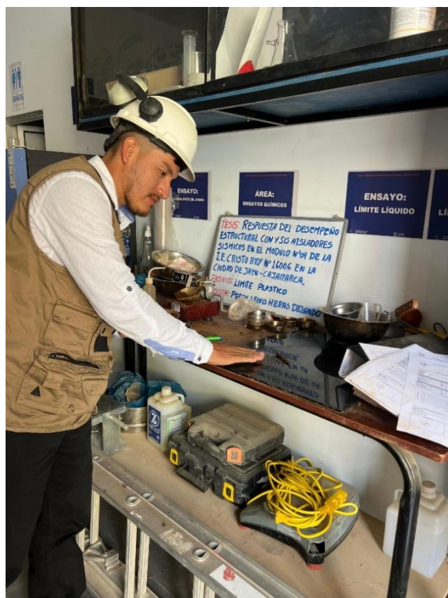
Figura 101. Elaboración del ensayo de Limites de Atterberg
