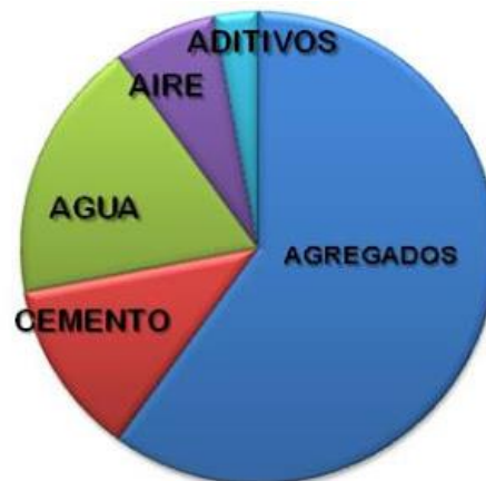
Figura N° 2. Componentes del concreto.
