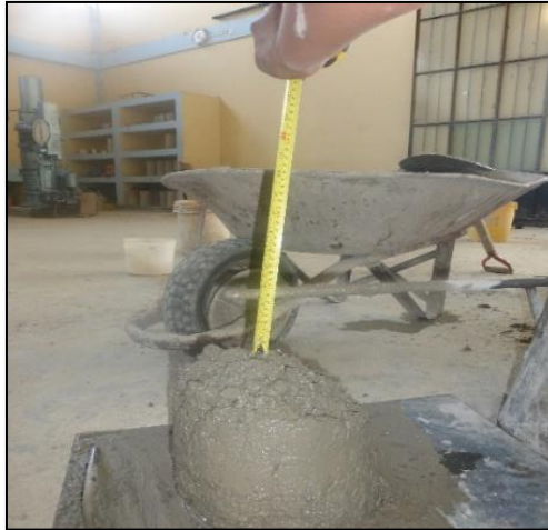
Fotografía 13. Medición del Asentamiento o Slump.
