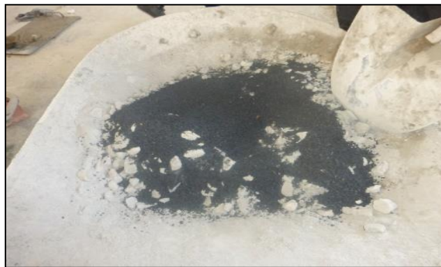
Fotografía 11. Mezcla de las partículas de caucho reciclado con los materiales de mezcla.
