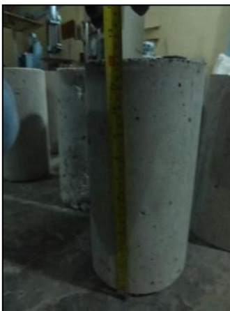
Fotografía 15. Medición de altura y diámetro de probetas.
