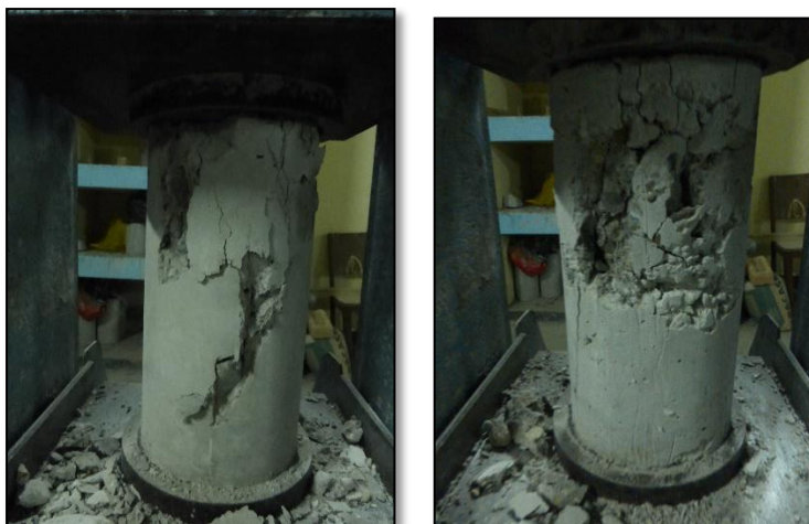
Fotografía 18. Falla de los especímenes ensayados.
