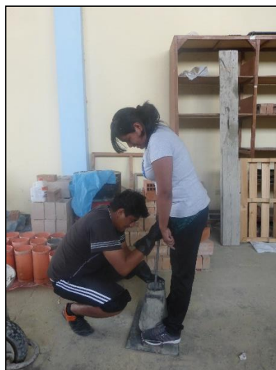
Fotografía 12. Ensayo del Cono de Abrams
