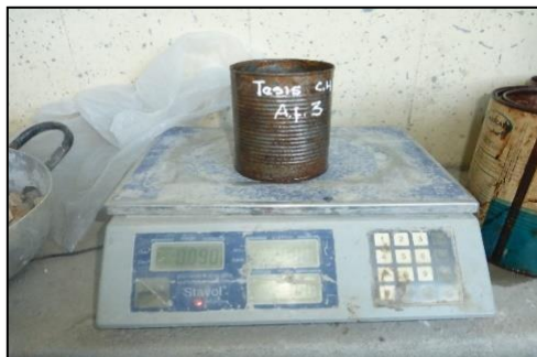
Fotografía 8. Peso de muestras para determinar el contenido de humedad del agregado fino.
