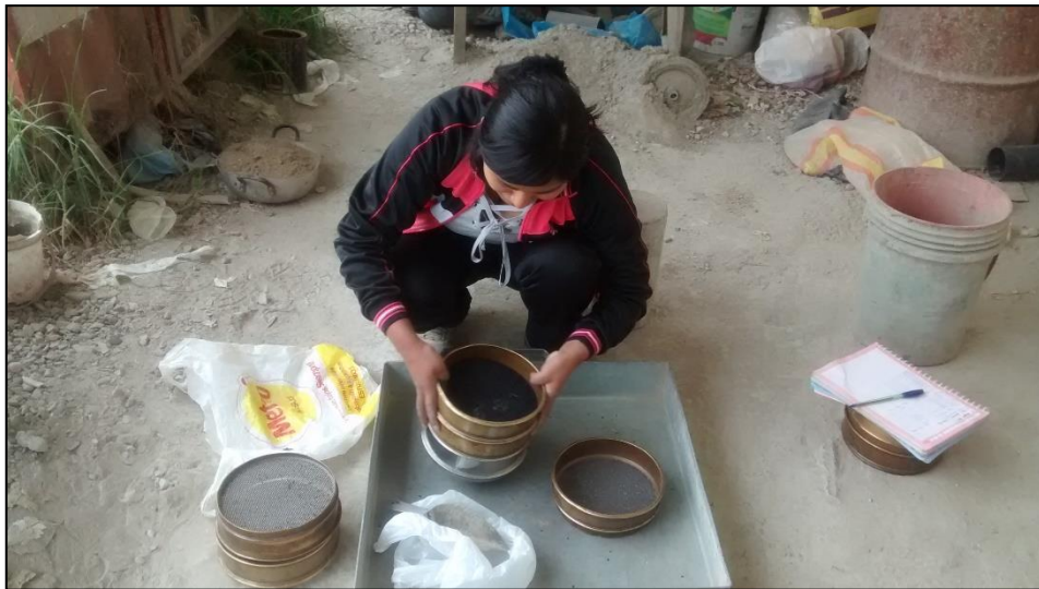
Fotografía 7. Ensayo de granulometría para las Partículas de Caucho Reciclado.
