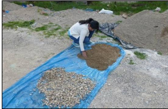
Fotografía 1. Selección del agregado grueso y fino para determinar el peso específico.
