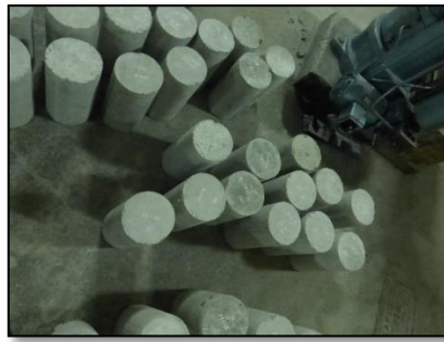
Fotografía 16. Probetas listas para el ensayo a compresión.
