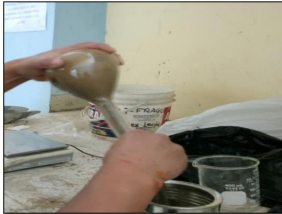
Fotografía 2. Material usado para la determinación del peso específico del agregado fino.
