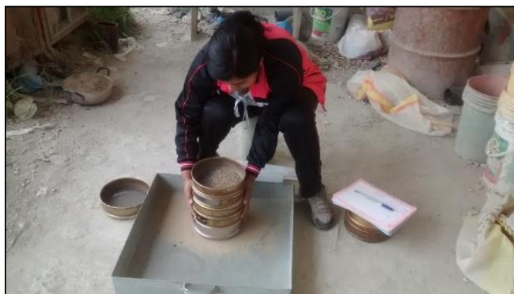
Fotografía 6. Ensayo de granulometría para el Agregado Fino.
