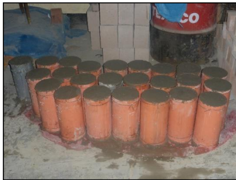
Fotografía 14. Encofrado de probetas.
