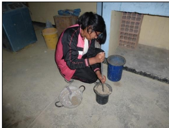
Fotografía 3. Ensayo Peso Unitario Seco Compactado del Agregado Grueso
