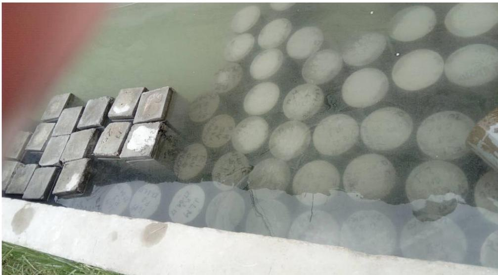
*Imagen N° 10: Fotografía de los especímenes curados en la posa para el tratamiento de curado por inmersión*
