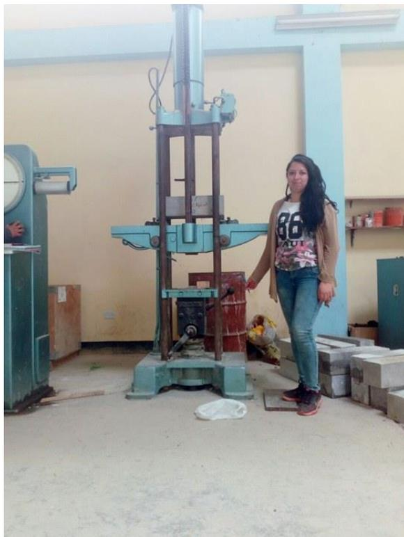
*Imagen N° 16: Fotografía de la máquina de ensayo a flexión*
