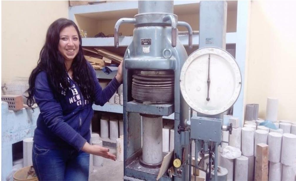
*Imagen N° 9: Fotografía de la máquina de ensayo de resistencia a compresión*
