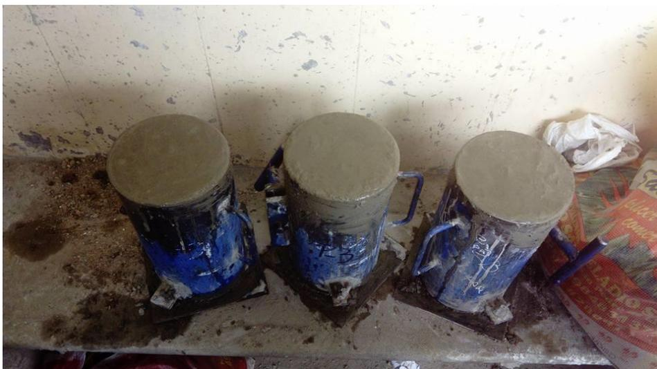
*Imagen N° 3: Fotografía de las muestras de prueba de concreto patrón*
