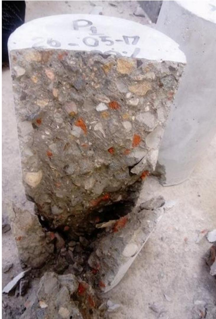
*Imagen N° 17: Fotografía de la distribución del ladrillo en la probeta ensayada*
