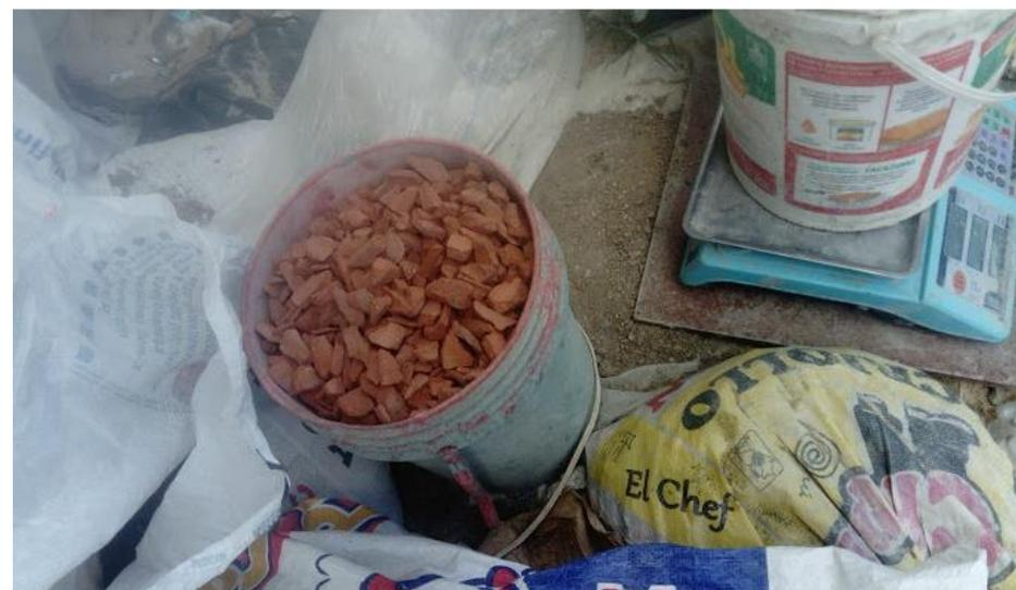
*Imagen N° 8: Fotografía del ladrillo triturado para el tratamiento de curado interno.*
