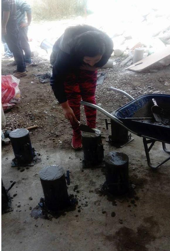
*Imagen N° 11: Fotografía de la realización de probetas*
