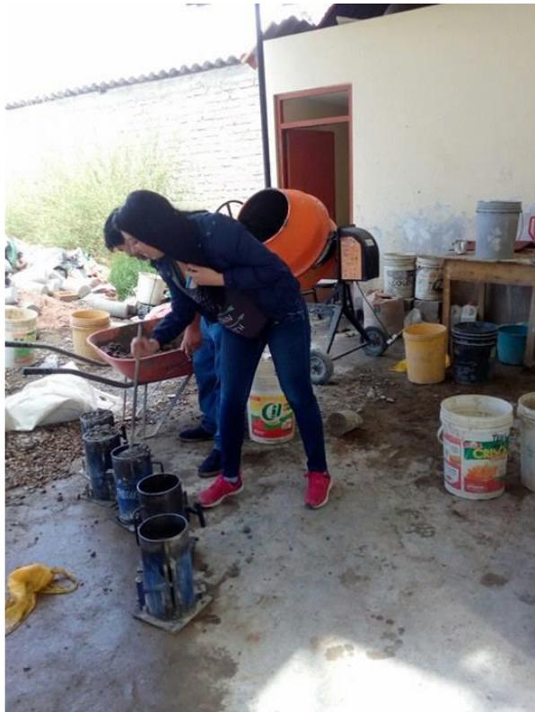
*Imagen N° 12: Fotografía de la realización de las probetas*
