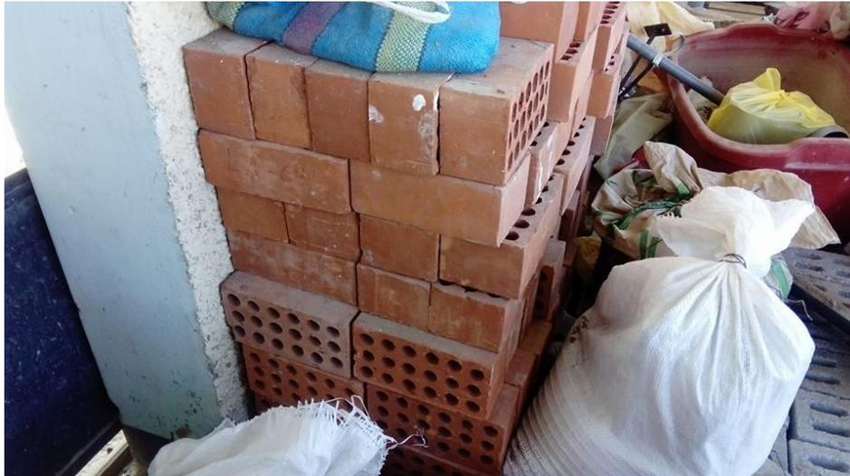
*Imagen N° 6: Fotografía del ladrillo empleado para el curado interno*
