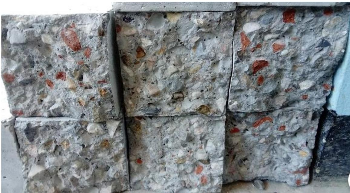
*Imagen N° 18: : Fotografía de la distribución del ladrillo en la probeta ensayada a flexión*
