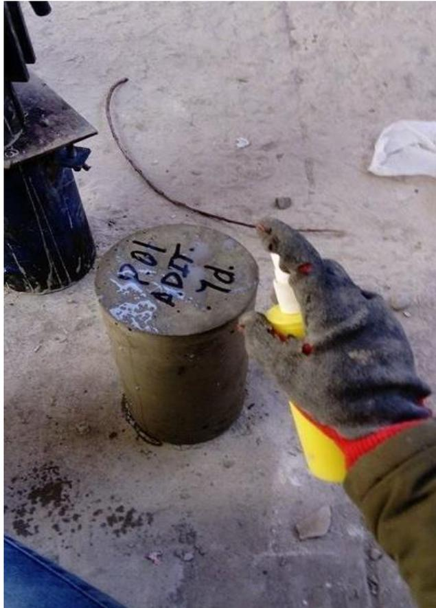
*Imagen N° 13: Fotografía de la aplicación del aditivo curador Membranil*
