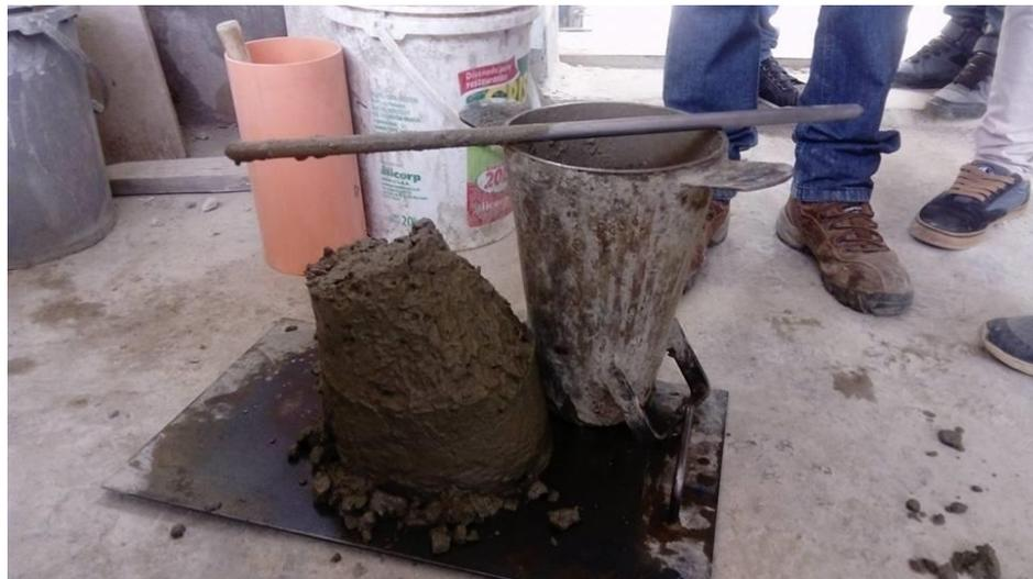
*Imagen N° 7: Fotografía de la prueba de abran para el concreto fresco*
