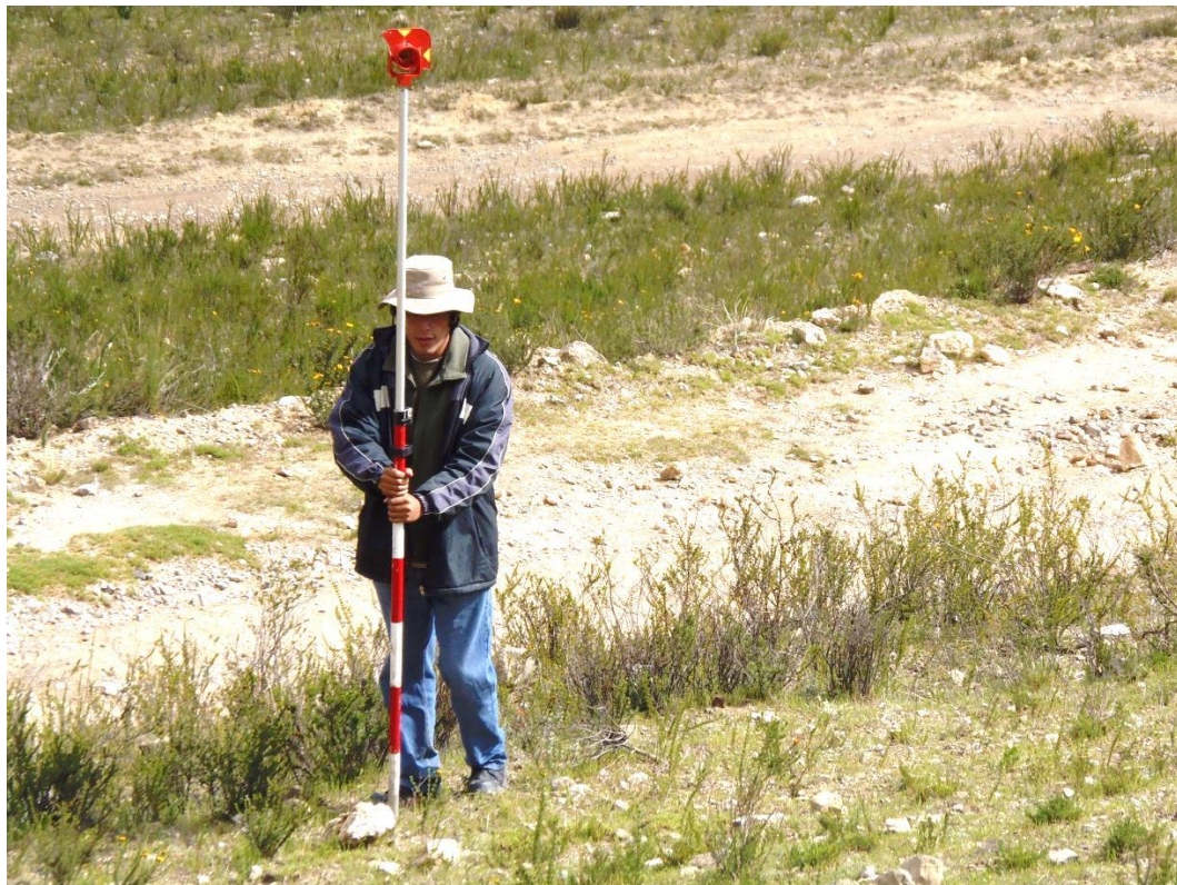
Fotografía N°04 Posicionamiento de prisma para toma de datos
