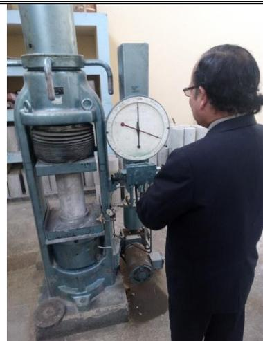
**Imagen N°20.-** Ensayo para evaluar la resistencia a compresión.
