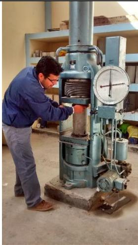
**Imagen N°21.-** Ensayo para evaluar la resistencia a compresión.
