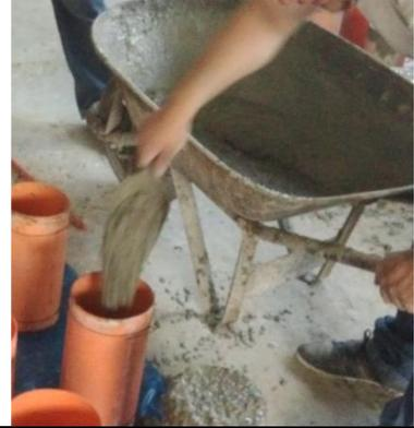
**Imagen N°16.-** Llenado de especímenes de concreto.
