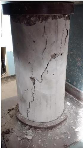
**Imagen N°23.-** Fallas típicas del espécimen ensayado.
