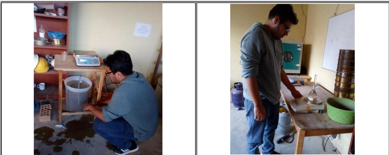
**Imagen N°07.-** Peso específico del agregado grueso.
