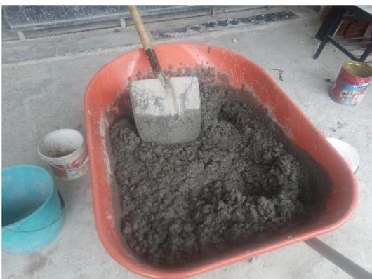
**Imagen N°13.-** Apariencia del concreto elaborado con ceniza.
