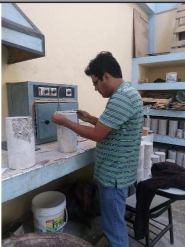
**Imagen N°19.-** Medición del diámetro de los especímenes de concreto.
