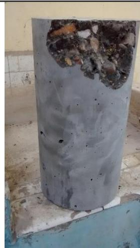
**Imagen N°24.-** Fallas típicas del espécimen ensayado.
