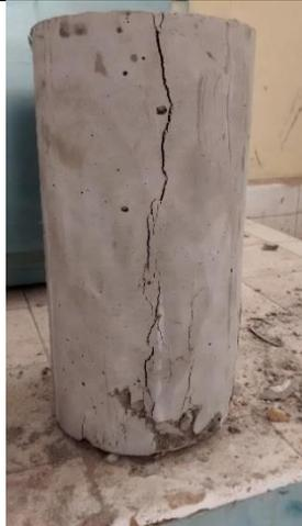
**Imagen N°25.-** Fallas típicas del espécimen ensayado.
