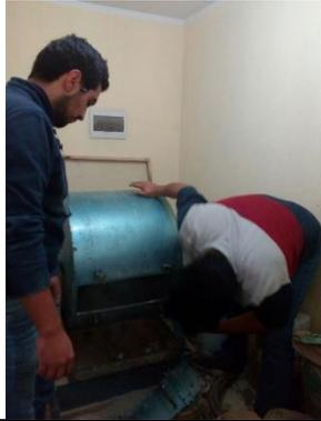
**Imagen N°09.-** Ensayo de abrasión en la máquina de los ángeles.
