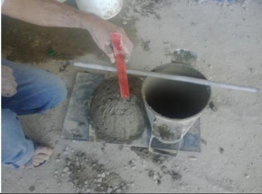
**Imagen N°15.-** Realizando el test de Slump del concreto elaborado con ceniza.
