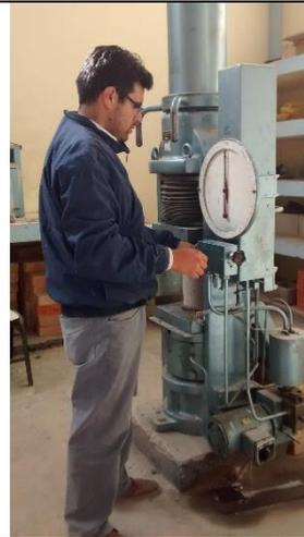
**Imagen N°22.-** Ensayo para evaluar la resistencia a compresión.
