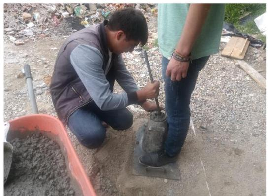
**Imagen N°14.-** Realizando el test de Slump del concreto elaborado con ceniza.
