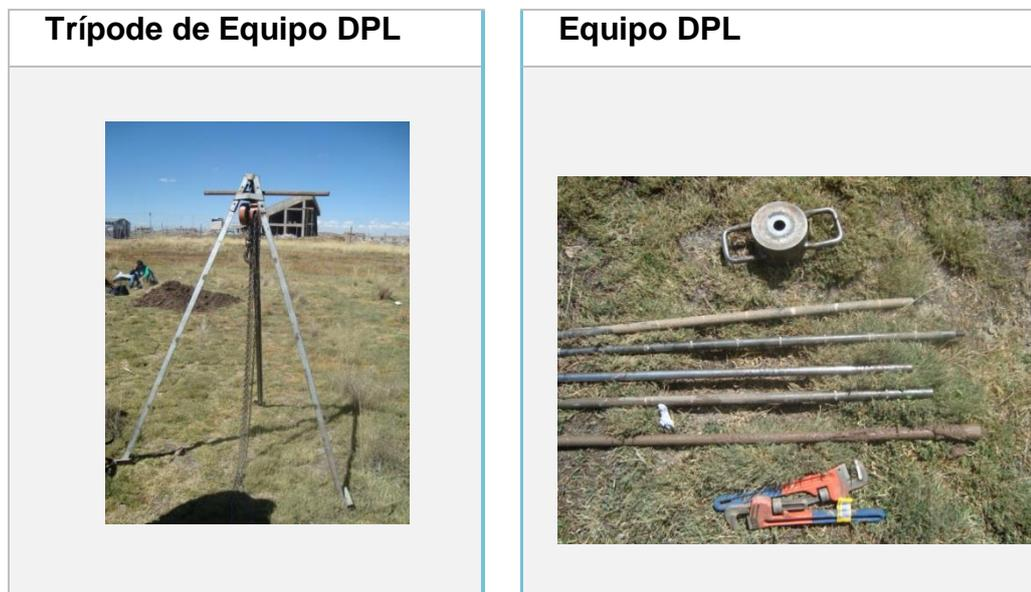
Fig.2 partes que conforma el DPL.
