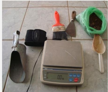
Fig.5 equipo para contenido de humedad de muestras.
