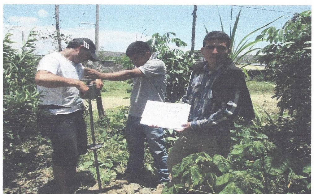
Vista del ensayo de penetración Dinámica ligera en el punto DPL-5.
