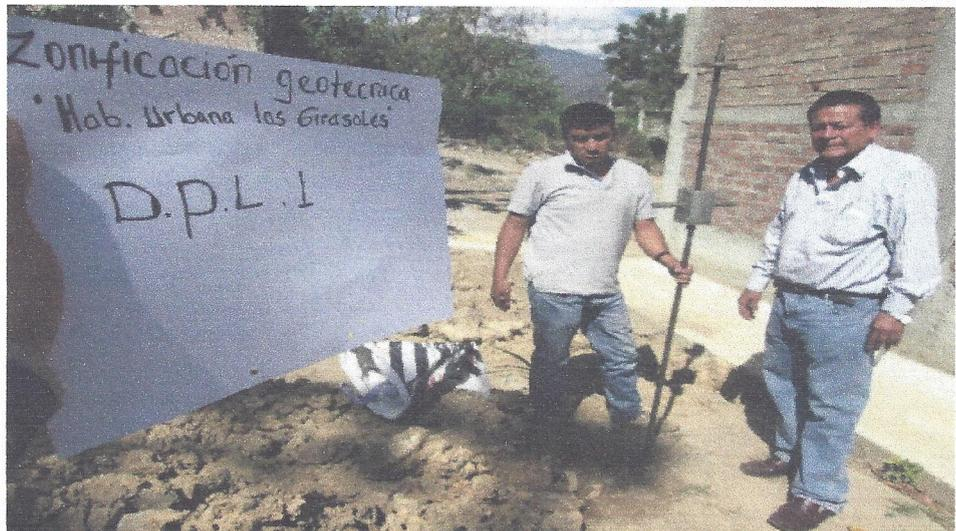
Vista del ensayo de penetración Dinámica ligera en el punto DPL-1.
