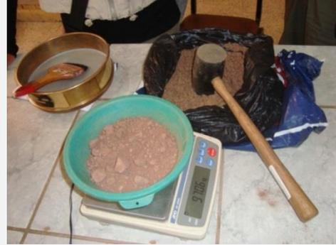
Fig.6 equipo para análisis granulométrico
