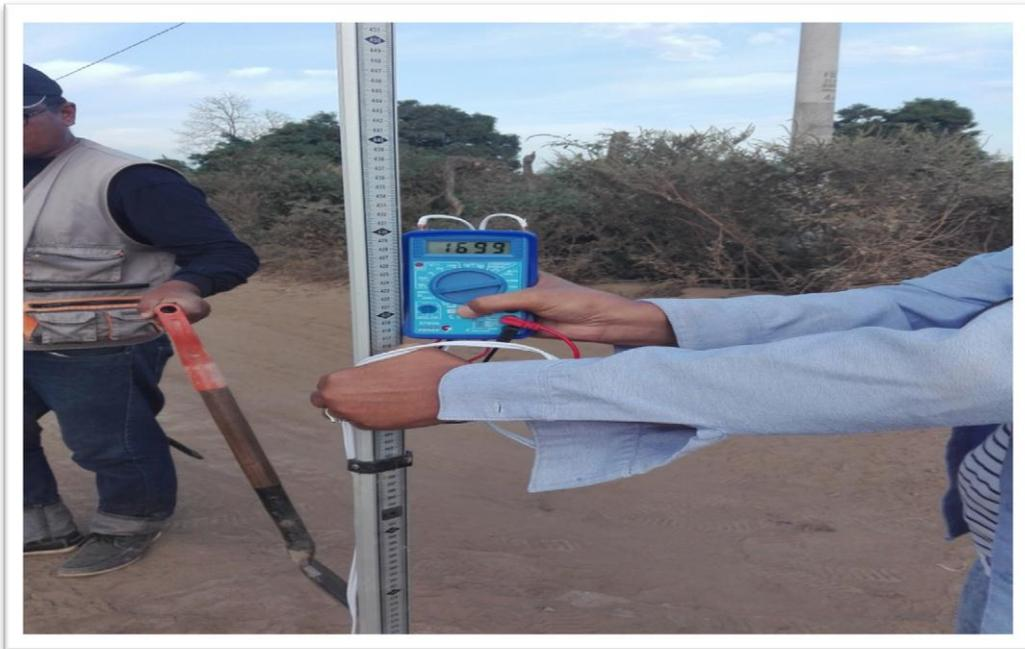
En ésta vista se observa al multímetro activado, significa que ya hicieron contacto los cables con el agua.
