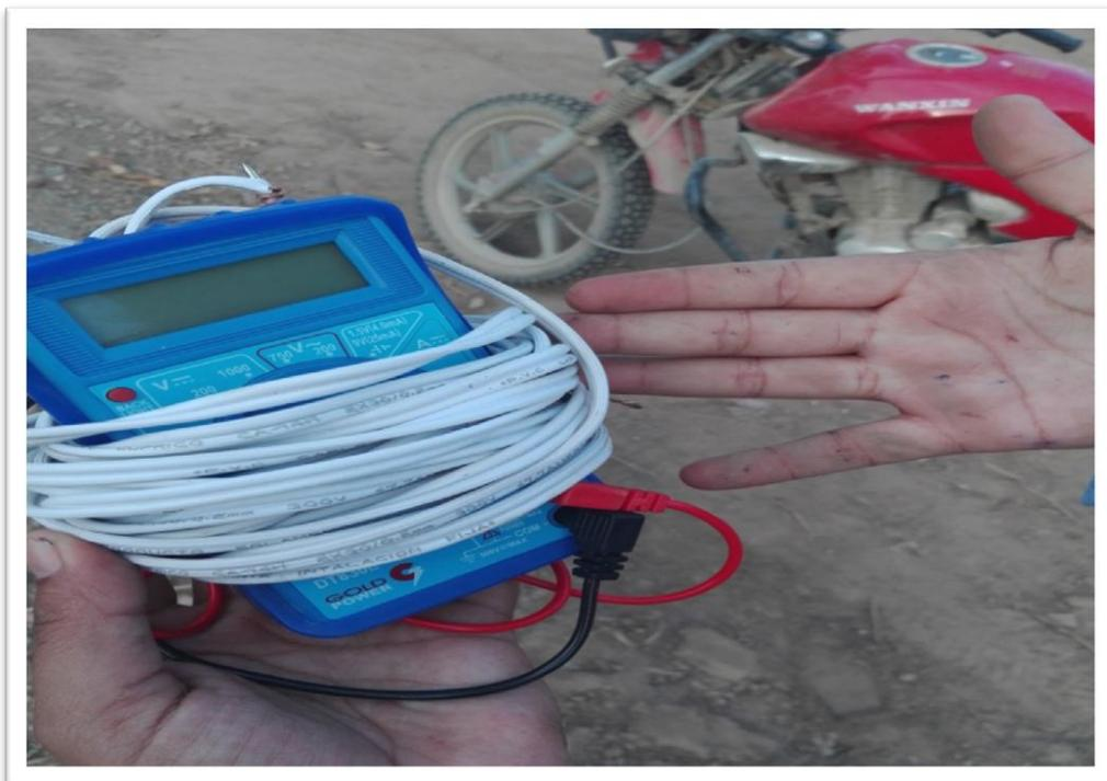
En ésta vista se observa el multímetro utilizado para el aforo del tirante hidráulico.
