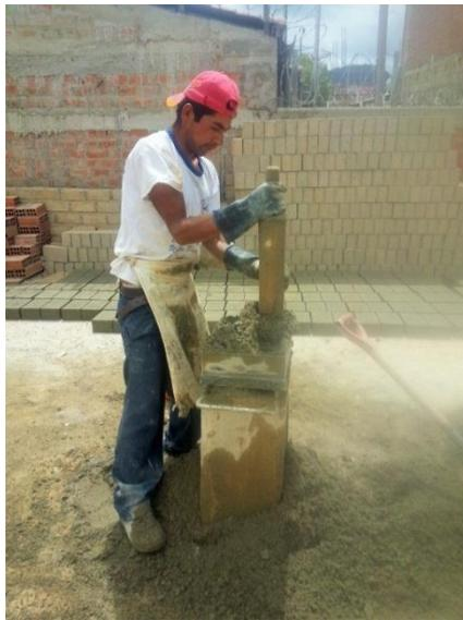
Figura 14. Fabricación del ladrillo de concreto de María Pérez.
