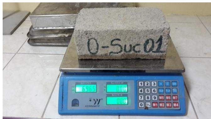
Figura 32. Peso del espécimen después de 1 min sumergido
