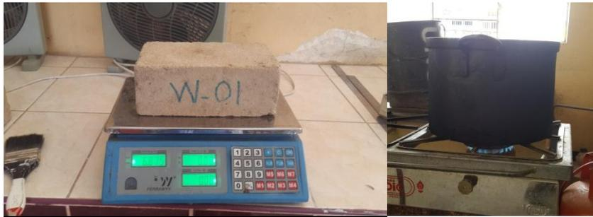
Figura 24. Peso y 3 horas de ebullición de muestras
