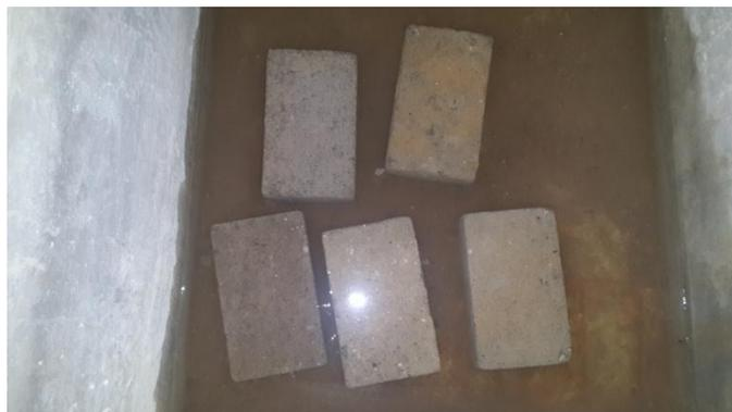
Figura 20. Ladrillos introducidos en agua 24horas
