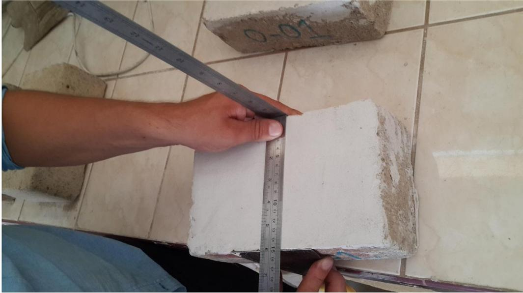
Figura 60. Medición de la unidad para ensayo a la compresión
