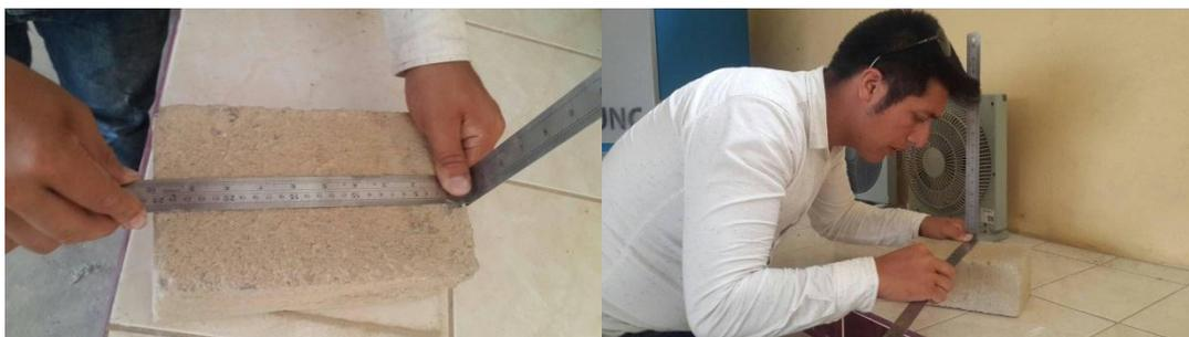
Figura 16. Medición de ladrillos para variación dimensional
