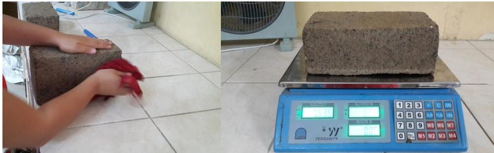
Figura 26. Secado superficial y peso después de sumersión
