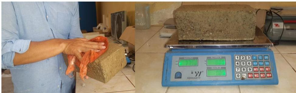
Figura 23. Secado superficial y peso después de ebullición
