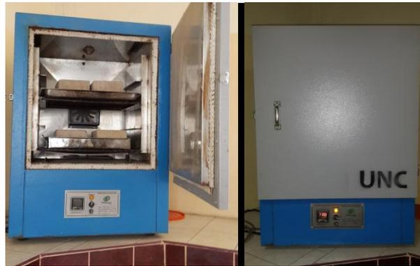
Figura 18. Secado de las muestras en horno
