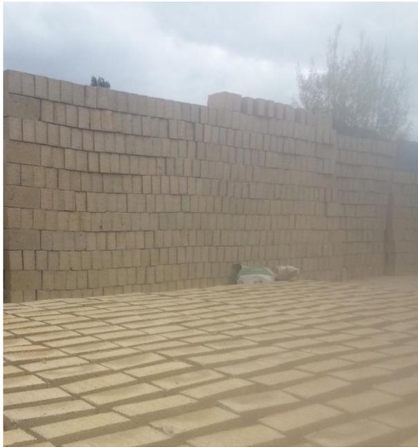
Figura 10. Almacenamiento de ladrillos de concreto
