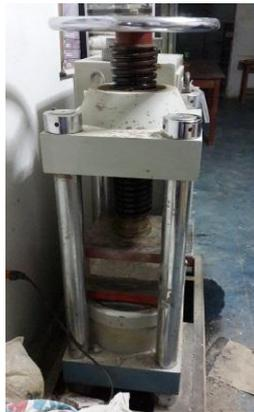
Figura 29. Especimen en la máquina de compresión
