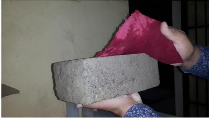
Figura 21. Secado superficial con franela
