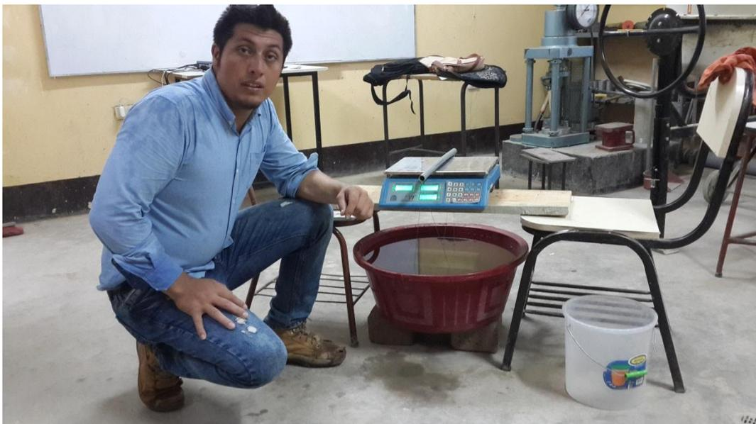
Figura 61. Obtención de peso sumergido
