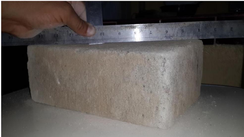
Figura 53. Obtención de datos para el alabeo
