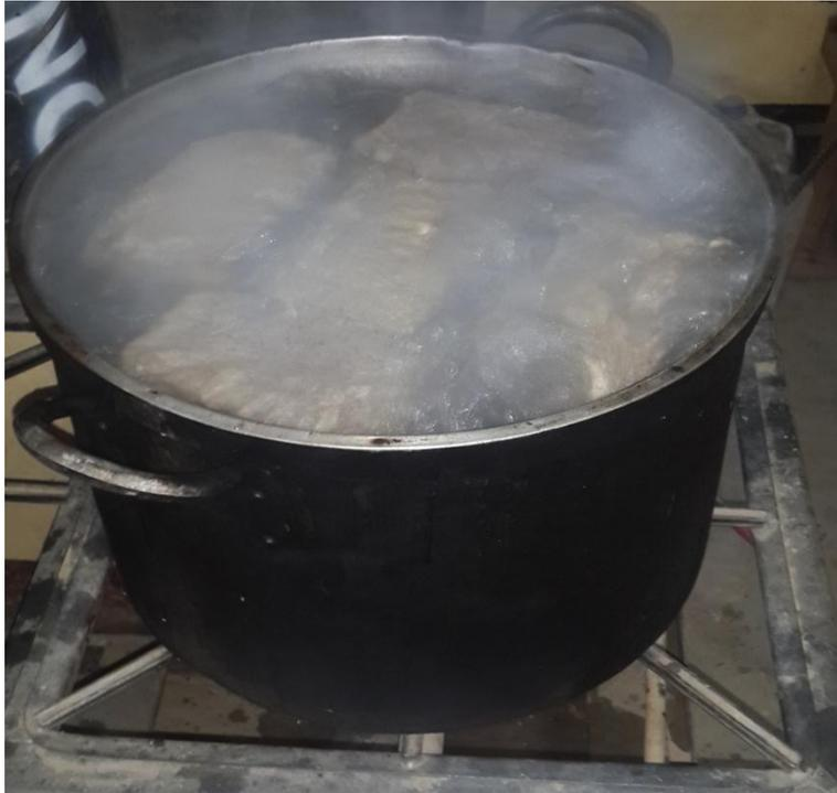
Figura 58. Muestras de ladrillos en ebullición
