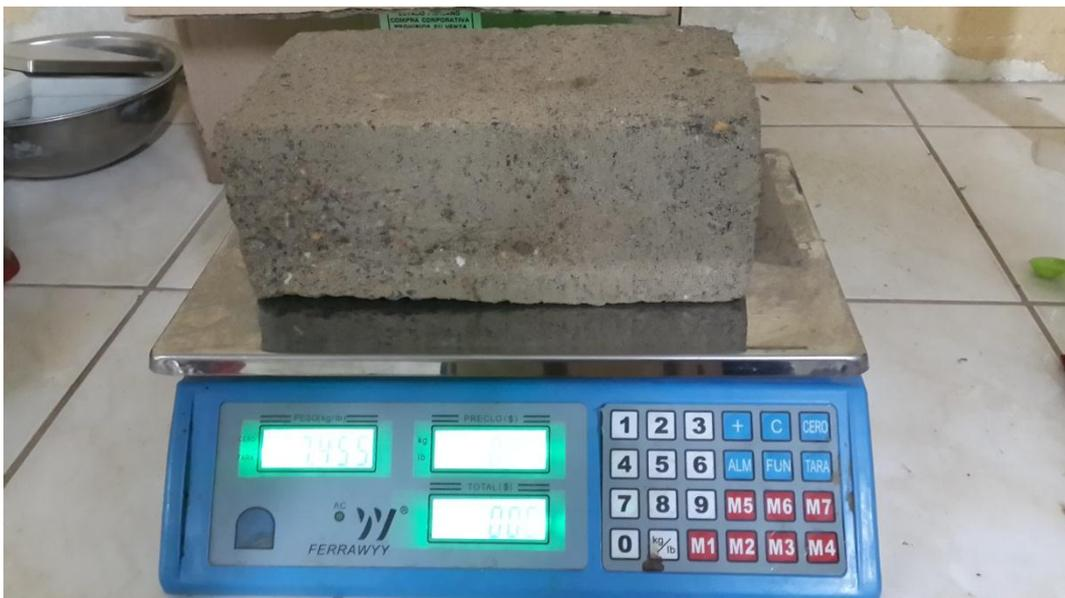
Figura 57. Peso de ladrillo saturado para el ensayo de absorción
