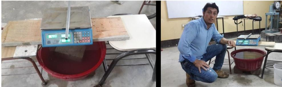
Figura 25. Peso de espécimen sumergido en suspensión
