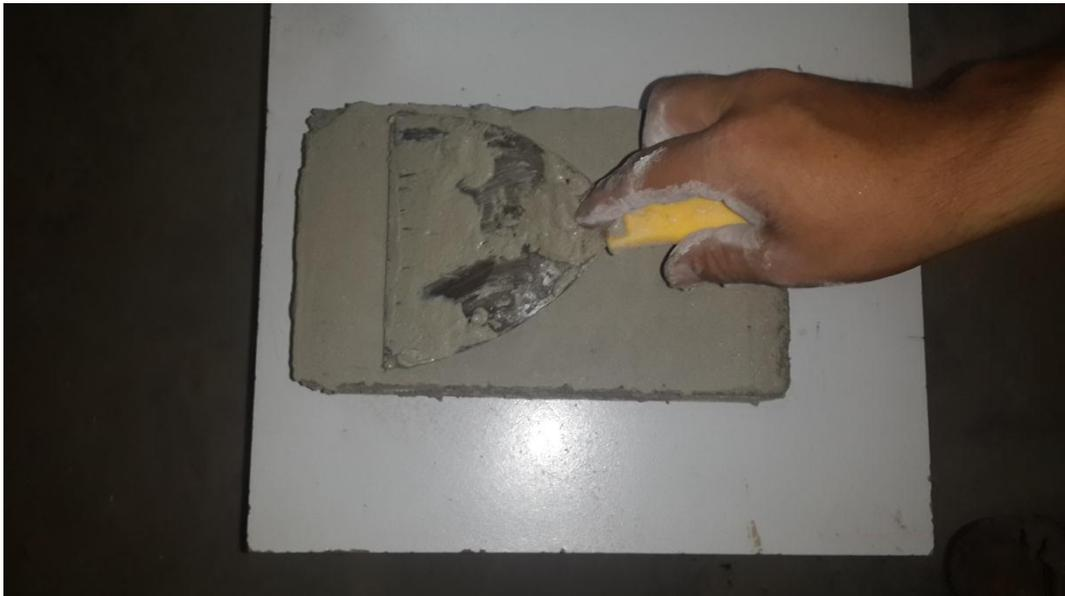
Figura 59. Refrentado con yeso para el ensayo a la compresión
