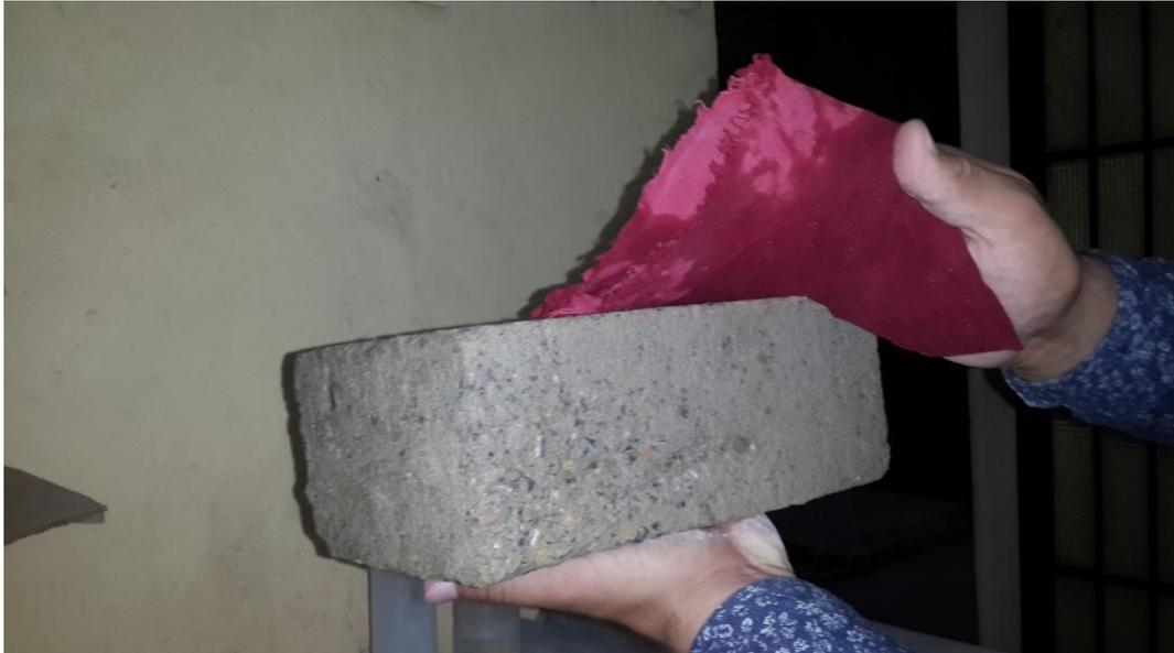
Figura 56. Secado superficial del ladrillo
