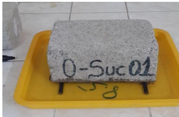
Figura 31. Parte del ladrillo en contacto con el agua
