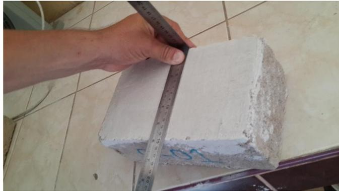
Figura 28. Medida del espécimen para el ensayo a la compresión
