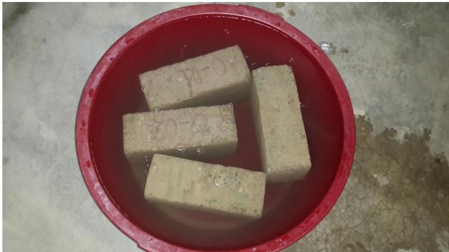
Figura 55. Muestras saturadas para el ensayo a la absorción
