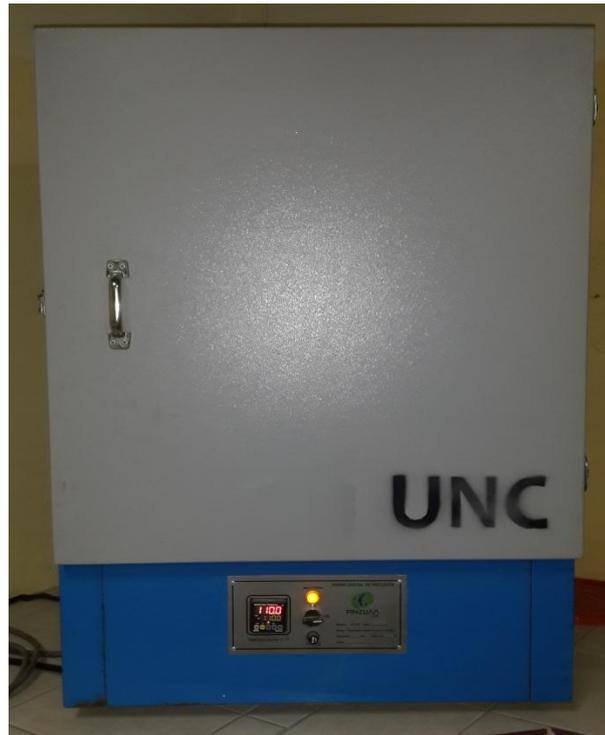
Figura54. Secado de muestras a 110°C por 24 horas
