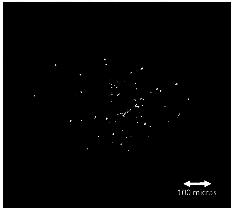
Figura 38: (100X LPX). Intercrecimiento de maclas de yeso de baja birrefringencia, con un color de interferencia gris claro de primer orden.
