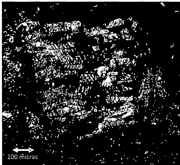
Figura 62: (100X LPX). Intercrecimiento de macls de yeso de baja birrefringencia vista con analizador, muestra variados colores de interferencia de primer orden.
