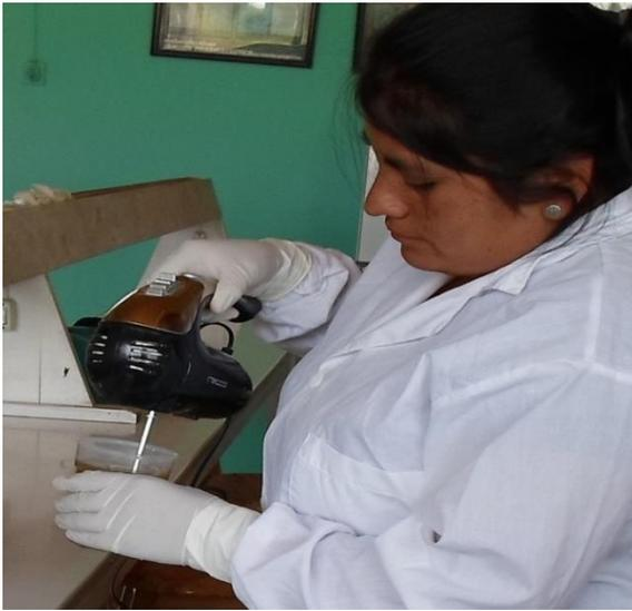
**Fig. 10.** Homogenizando la muestra con Batidora eléctrica.
