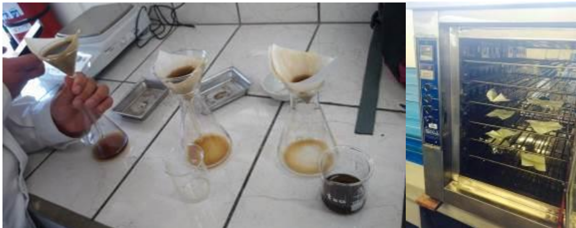
Figura 8. Filtrado y secado de muestras para el análisis de Sólidos Suspendedos Totales.
