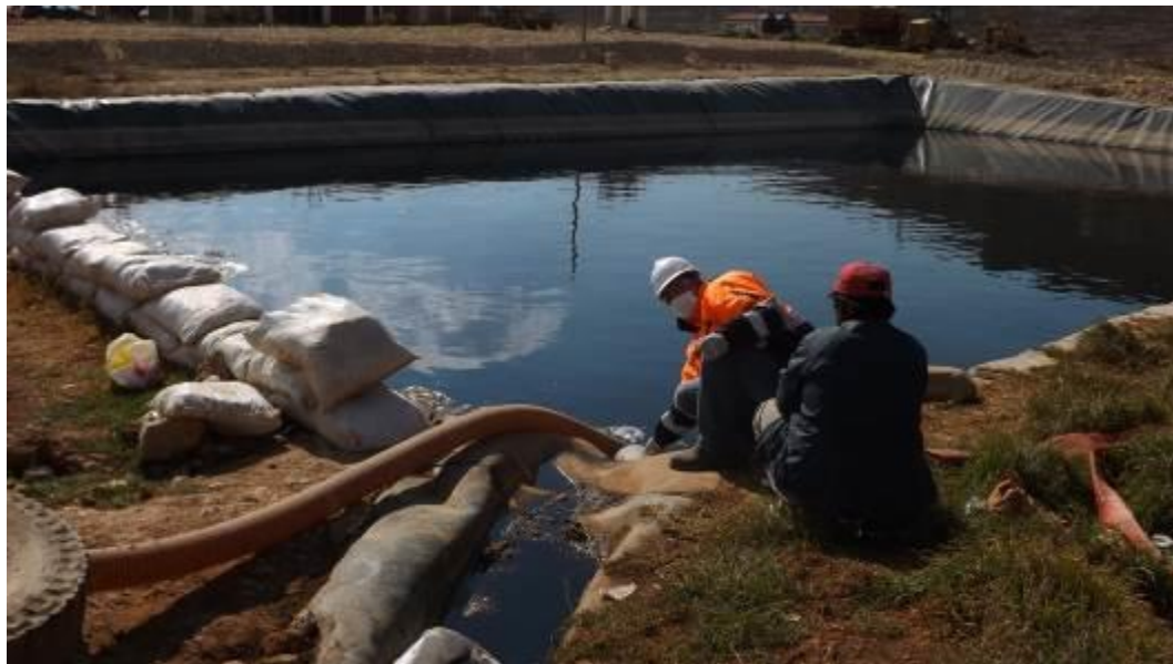
Figura 2. Obtención de las muestras de lixiviado del Relleno Sanitario Municipal de Cajamarca.
