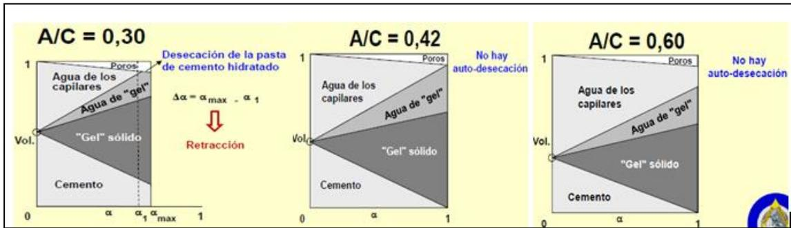
Figura 8. Análisis del desarrollo de la hidratación ( $\alpha$ ) de una pasta de cemento expuesta a un sistema cerrado según Powers y colaboradores.
