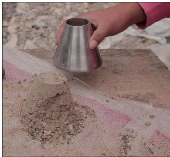
*Figura 50. Fotografía del Ensayo Cono De Absorción De Arenas.*
