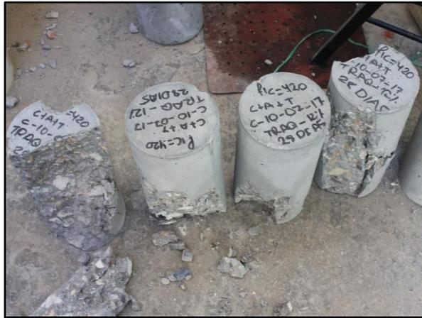
*Figura 57. Fotografía de la Falla de las Probetas.*
