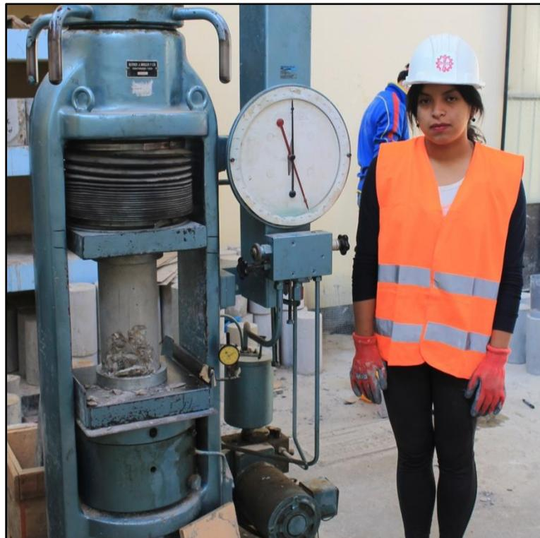
*Figura 56. Fotografía de la Máquina de Ensayo de Resistencia a Compresión.*
