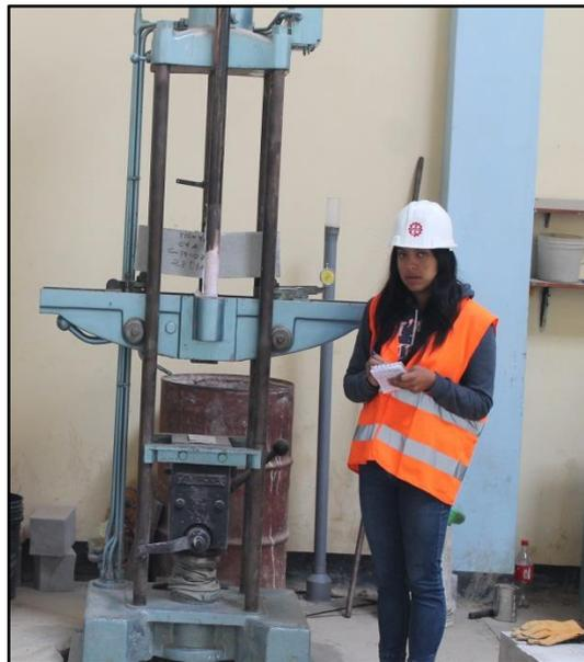
*Figura 58. Fotografía de la Máquina de Ensayo a Flexión.*
