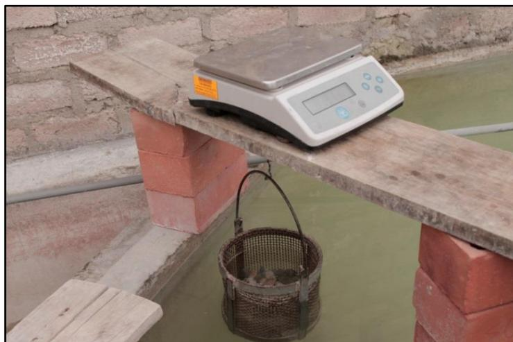
*Figura 48. Fotografía del Ensayo Peso Específico del Agregado Grueso.*
