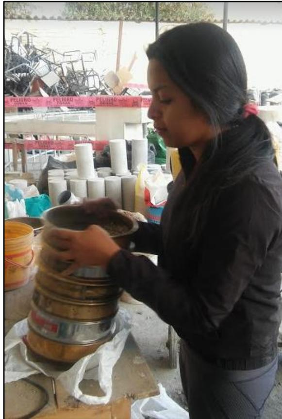
*Figura 47. Fotografía del Ensayo Análisis Granulométrico.*
