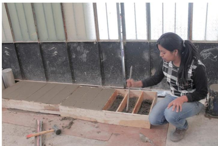
*Figura 54. Fotografía de los especímenes prismáticos*
