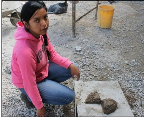
*Figura 49. Fotografía de la Reducción de muestras por el método del cuarteo.*
