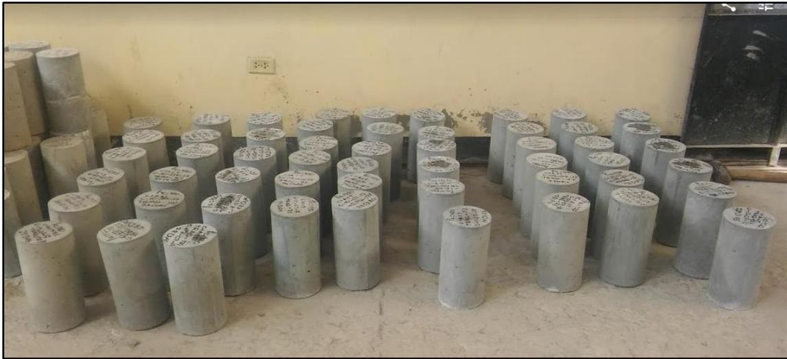
*Figura 55. Fotografía del Curado Interno de las Probetas de Concreto con % de Traquita.*
