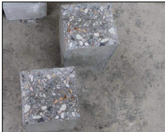
*Figura 59. Fotografía de la Distribución de la Traquita en la Probeta Ensayada a Flexión.*
