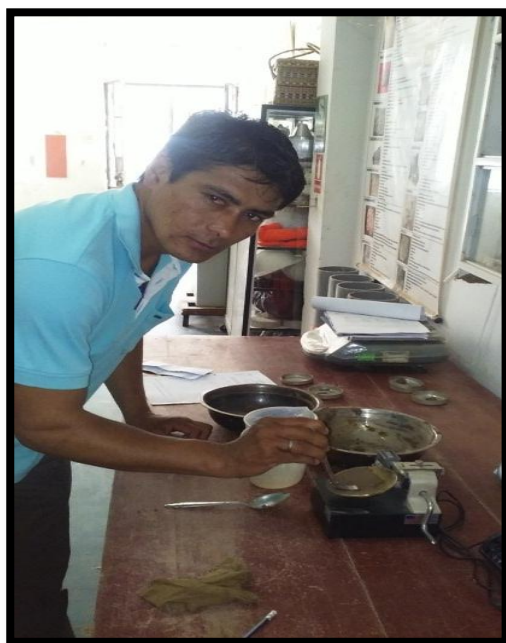
FIGURA 17: EN EL LABORATORIO REALIZANDO LA MUESTRA PARA EL ENSAYO DE LOS ÍNDICES DE PLASTICIDAD.
