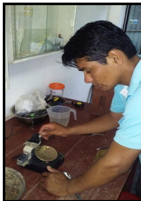
FIGURA 17: EN EL LABORATORIO REALIZANDO LA MUESTRA PARA EL ENSAYO DE LOS ÍNDICES DE PLASTICIDAD.
