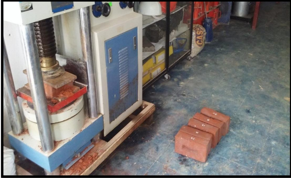
FIGURA 22: MUESTRA DE LADRILLO SUFRE ROTURA.
