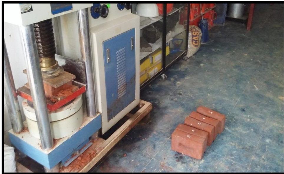
FIGURA 23: MUESTRA DE LADRILLO SUFRE ROTURA.
