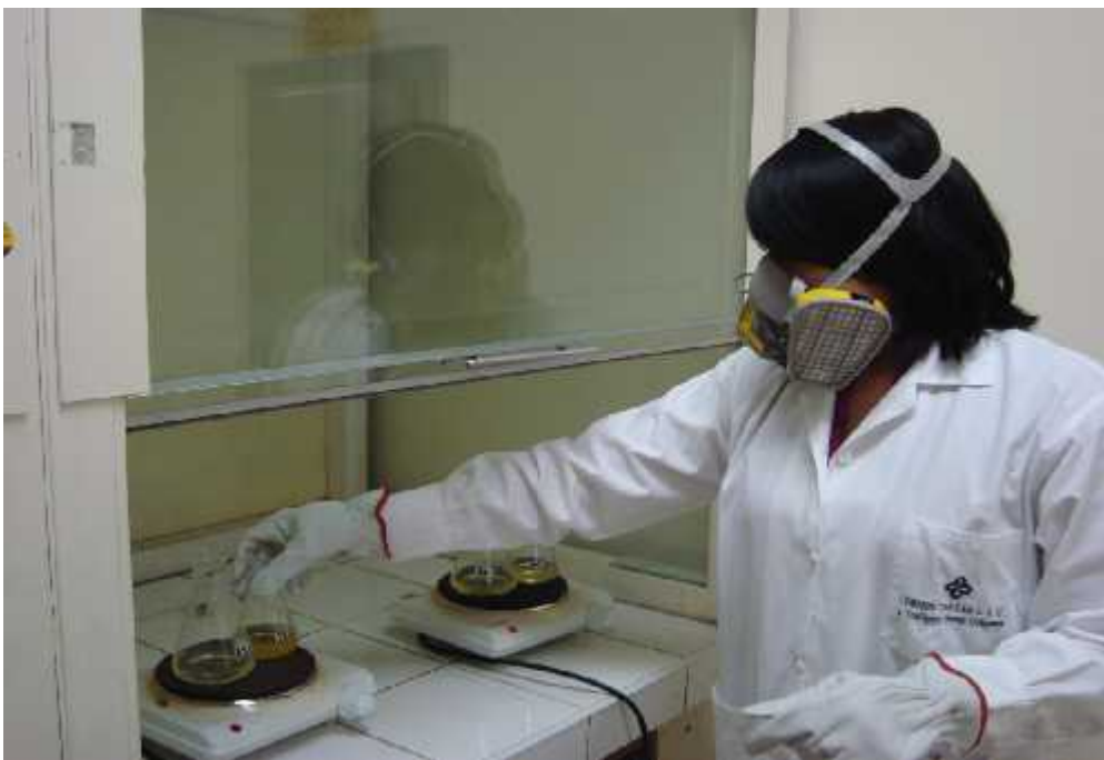
Foto 12: Realizando el análisis de hierro y cobre en el drenaje ácido de mina
