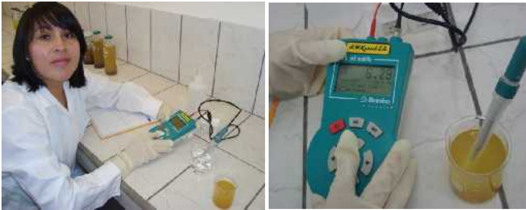
Foto 11: Izquierda: calibrando el pHmetro; Derecha: registrando el pH.
