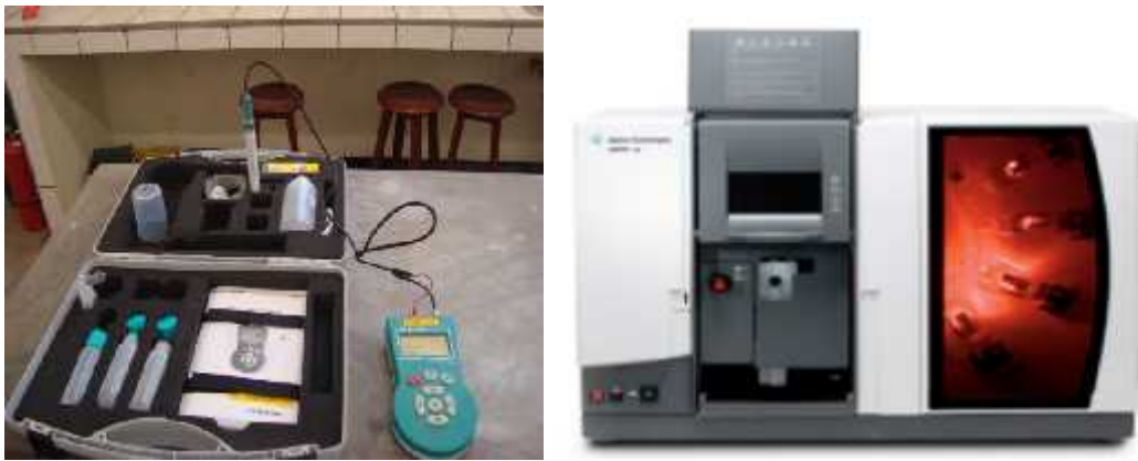
Foto 9: Izquierda: potenciómetro portátil; derecha: Espectrofotómetro Agilent Technologies 240-F
