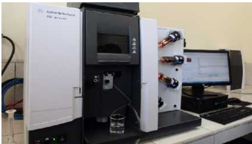
Foto 12: Realizando el análisis de hierro y cobre en el drenaje ácido de mina
