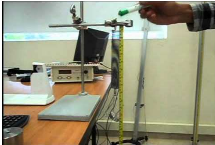
Fotografía N°12: Realizando el ensayo recuperación elástica por torsión
