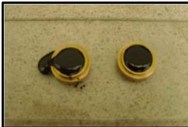
Fotografía N°19: Punto de Reblandecimiento (Método “Anillo y Bola”).
