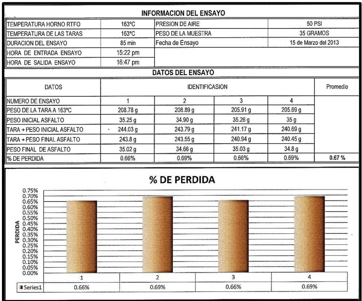
Gráfico N°7: Pérdida de masa por calentamiento Fuente: Reporte del ensayo Laboratorio INGGEOS SAC
