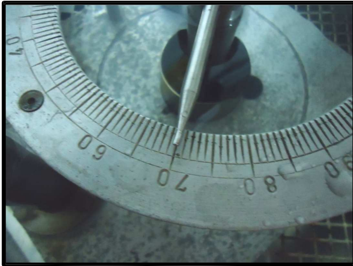
Fotografía N°8: Ensayo de recuperación elástica por torsión
