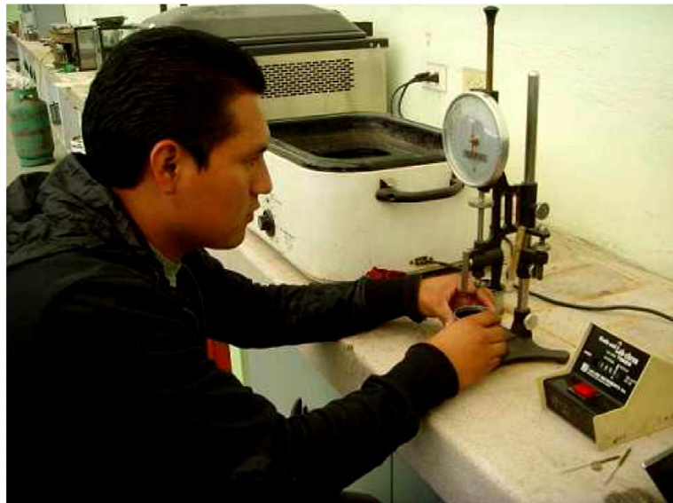
Fotografía N° 10: Realizando la penetración en las Muestras.
