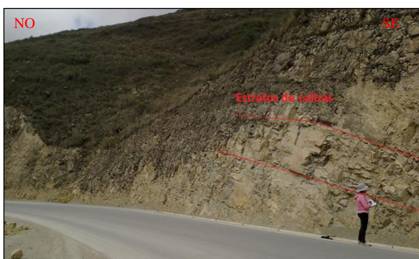
Figura 10: Calizas wackestone de la Formación Yumagual, en estratos de 1.5m aproximadamente; en zona de alta fracturación en el Km 41+100.
