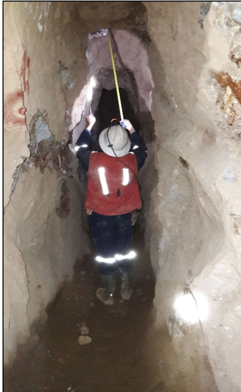
Foto 3.3: Marcado de ancho de veta para control de dilución (Sn074 SE – Veta Angélica).
