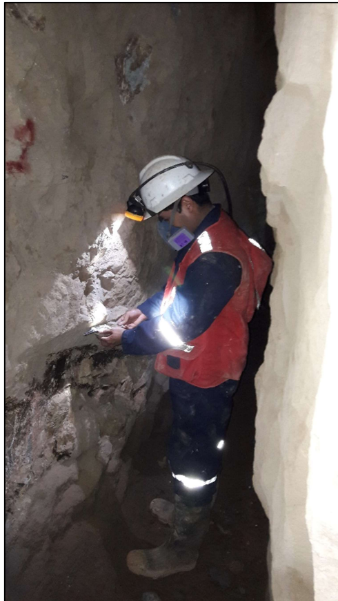
Foto 3.2: Cartografiado geológico de estructuras mineralizadas (Sn074 SE – Veta Angélica).
