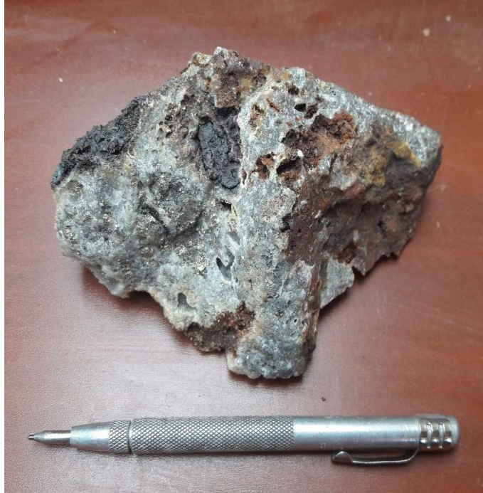
Foto N° 4.5: Muestra 04, Ch032-1 - Veta Diana - Matriz cuarzosa gris verdosa, cuarzo gris masivo, presencia de óxidos de hierro y manganeso recubriendo cavidades.
