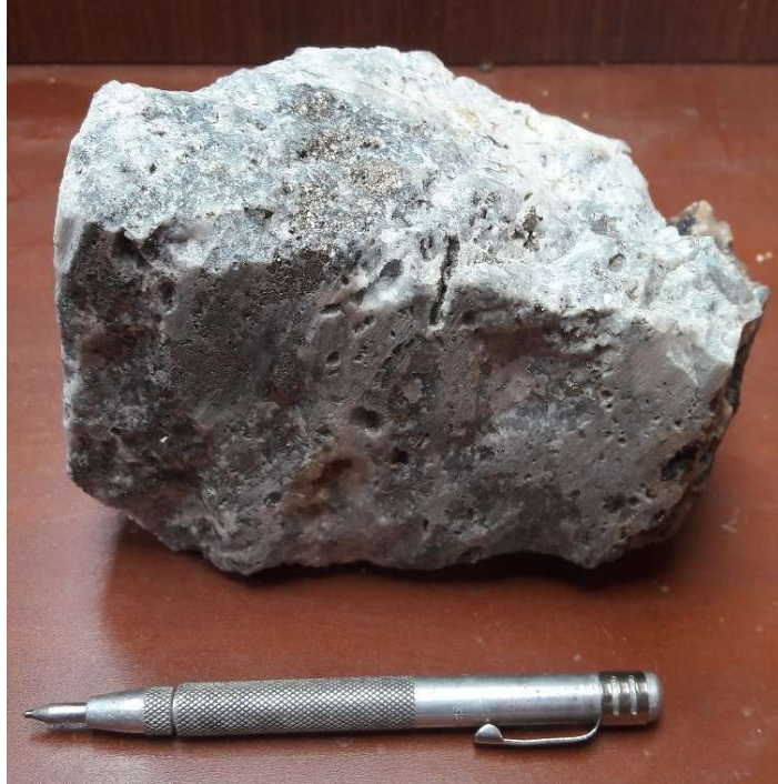
Foto N° 4.3: Muestra 02, tomada de Sn074 NW – Veta Angélica, presencia de matriz cuarzosa, cuarzo gris masivo, rodeando pirita diseminada.
