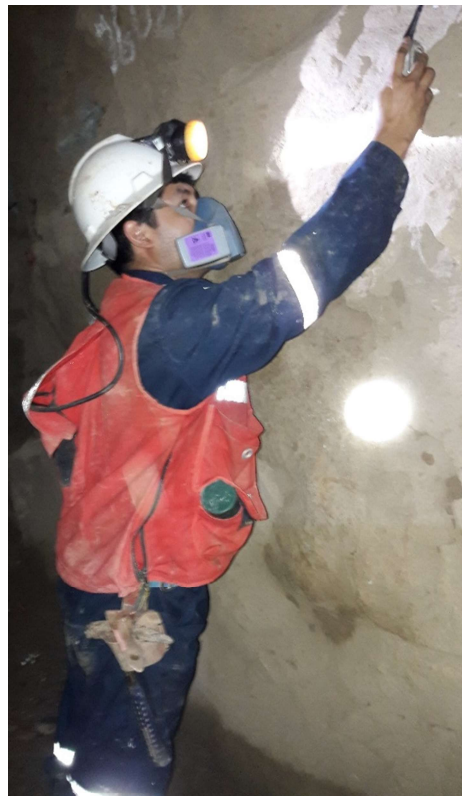
Foto 3.4 Medida de azimut y buzamiento de estructuras mineralizadas.
