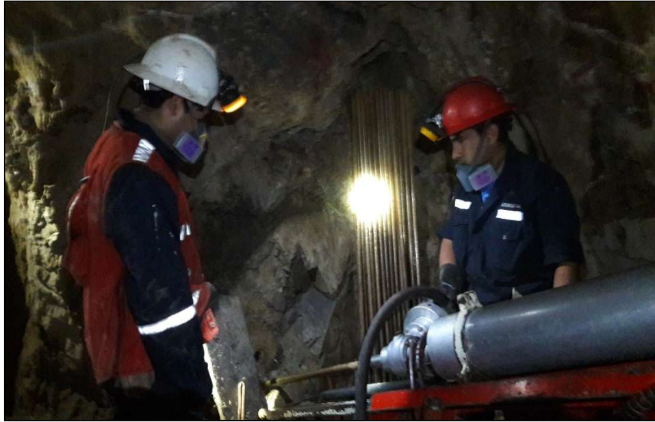
Foto 3.6: Supervisión de taladros de exploración, realizados por máquina neumática PackSack-L50.
