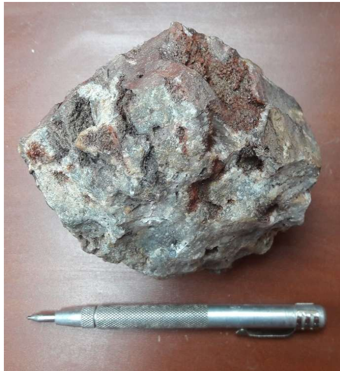
Foto N° 4.4: Muestra 03, Sn032 SE - Veta Diana - Matriz cuarzosa gris verdosa, cuarzo gris masivo, presencia de óxidos de hierro y manganeso relleno de cavidades.
