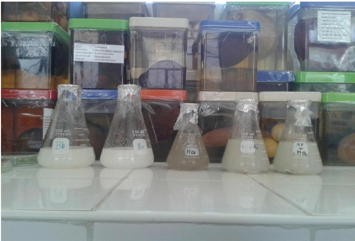
**Figura 13.** Preparación de caldo entomopatógeno: Hidratación de esporas.
