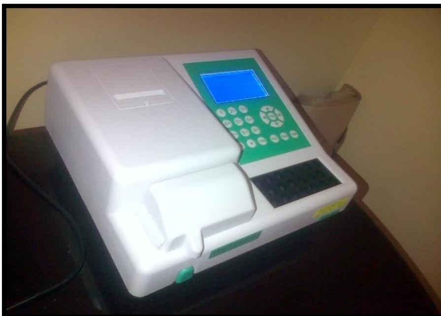
**Foto 12. Medición en el espectrofotómetro**
