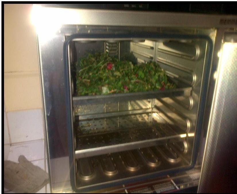
**Foto 08. Secado de la muestra de poda en la estufa**
