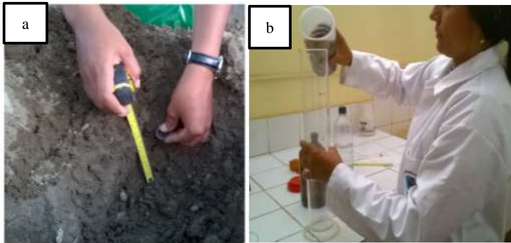
Foto 11. Determinación de la textura de suelo- Método Bouyoucos
