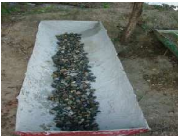
Foto 05: Primera capa de grava en la unidad experimental.
