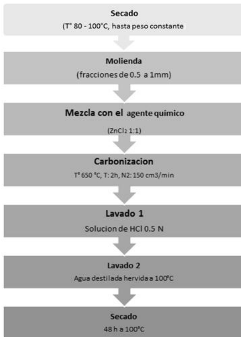
Figura 7: Diagrama de flujo de producción de carbón activado utilizando ZnCl 2 como agente químico de activación
