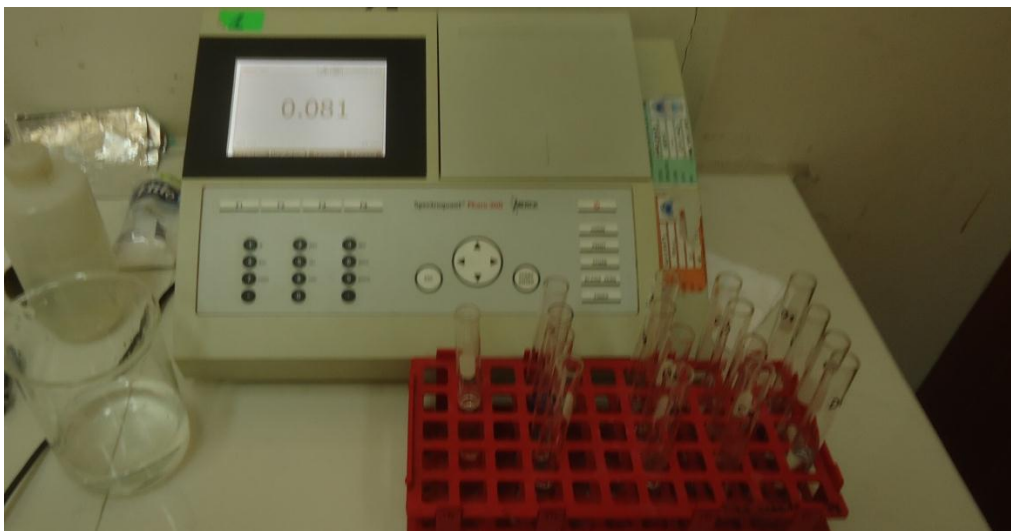
Figura 53: Medición de la concentración final de azul de metileno en el espectrofotómetro
