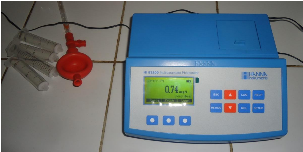
Figura 65: Medición del cloro libre residual en el agua potable del PM 06
