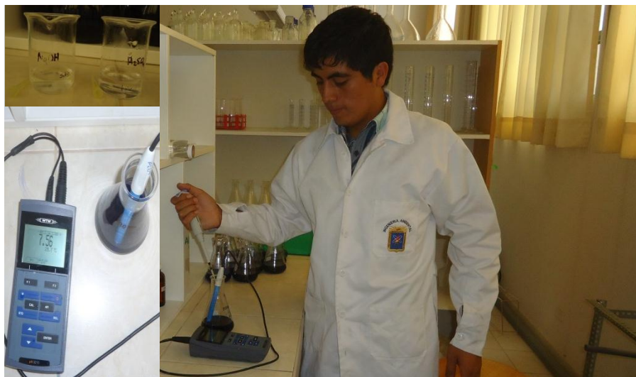
Figura 44: Modificación del pH a valores de 3; 4.5; 6 y 7.5 para cada una de las concentraciones, con H_2SO_4 y NaOH
