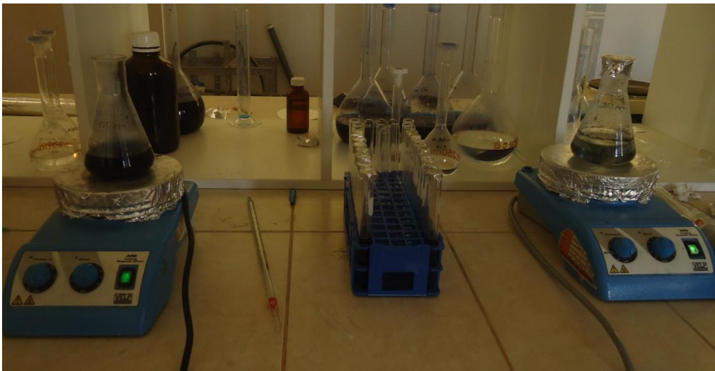
Figura 55: Pruebas de cinética de adsorción con azul de metileno a cc iniciales de 80 y 120 ppm
