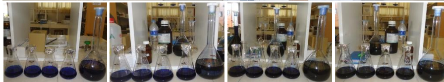
Figura 43: Distribución de concentraciones de 40, 60, 80 y 120 ppm en matraces de 250 ml
