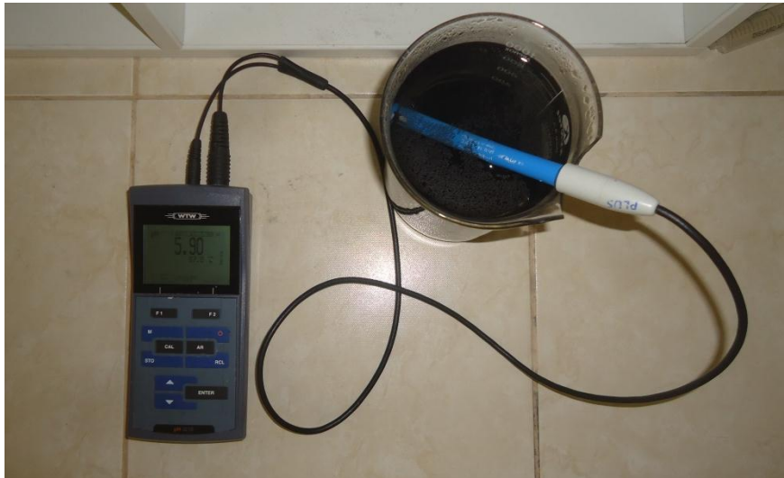
Figura 39: Medición del pH del carbón activado
