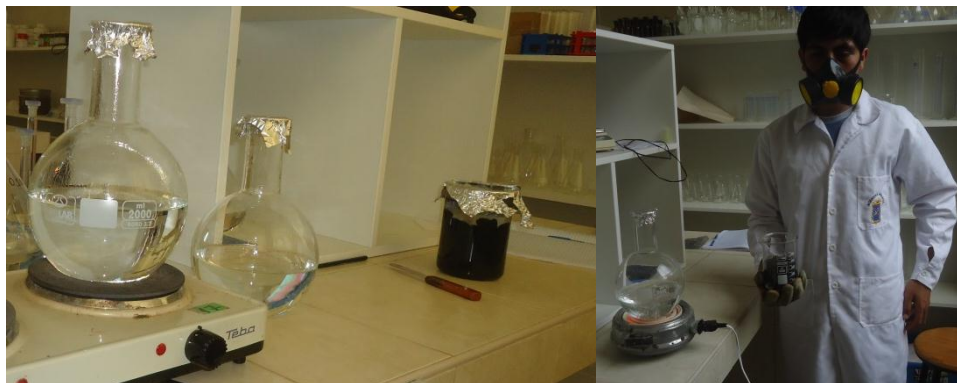
Figura 15: Lavado del carbón activado con agua destilada hervida
