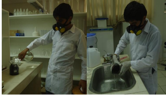
Figura 14: Lavado del carbón activado con HCl 0.5N
