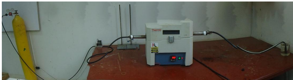
Figura 11: Sistema de producción de carbón activado (Balón de nitrógeno gas + Dispensador de nitrógeno + Horno horizontal + Recipiente para recuperación del agente activante)
