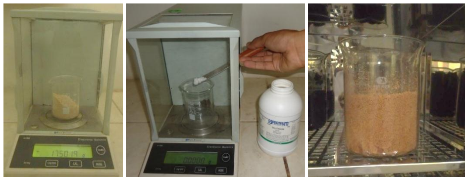
Figura 10: Mezclado del material precursor con el agente activante
