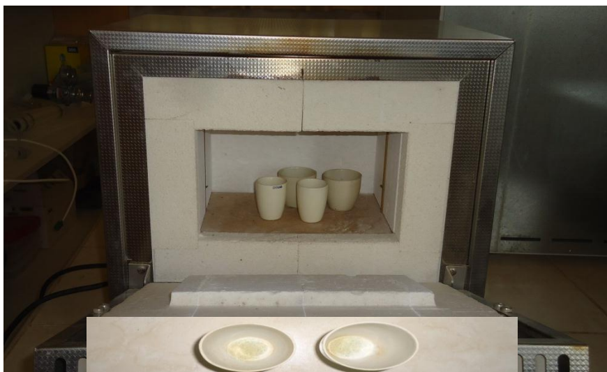
Figura 41: Incineración de una muestra de CA para determinar el contenido de ceniza
