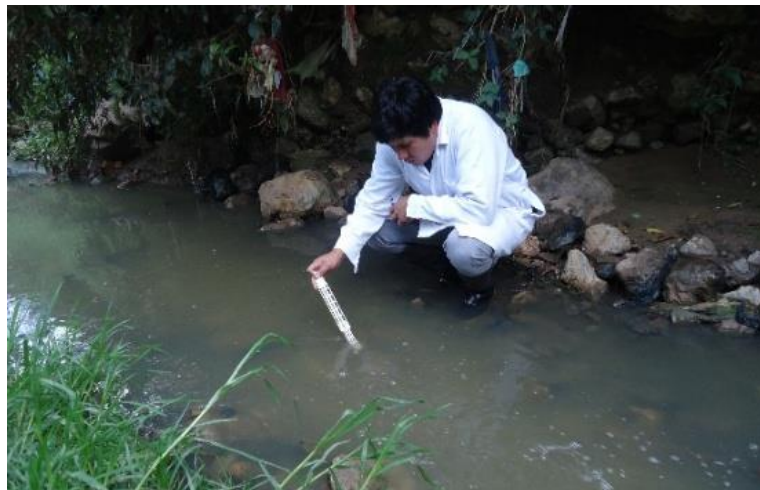
Fig. 9 Medición de la temperatura del agua
