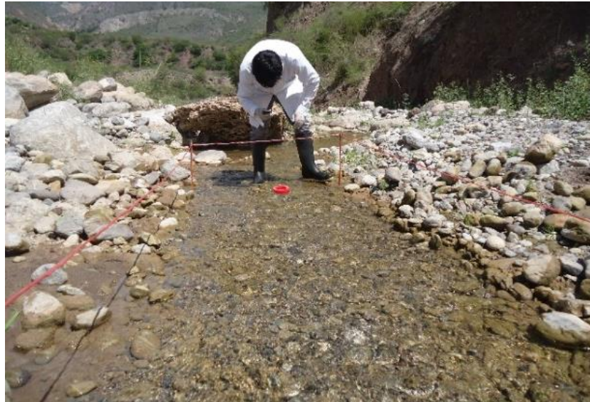
Fig.6 Calculando el tiempo de recorrido del flotador
