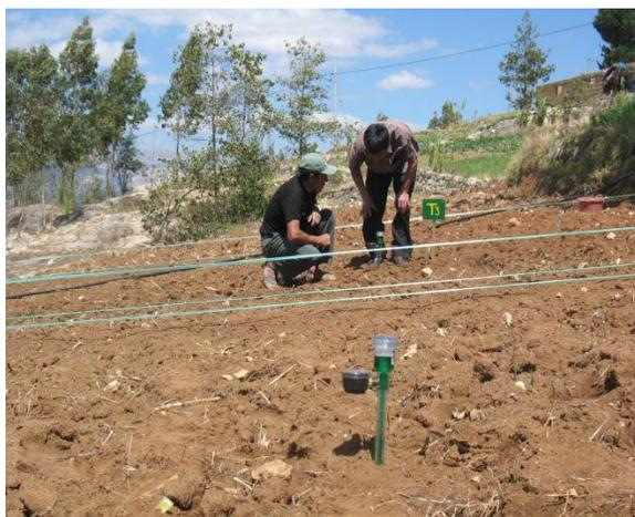
f. Calibración de tensiómetros.
