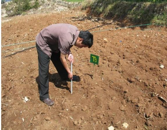
e. Instalación de tensiómetros en parcela experimental
