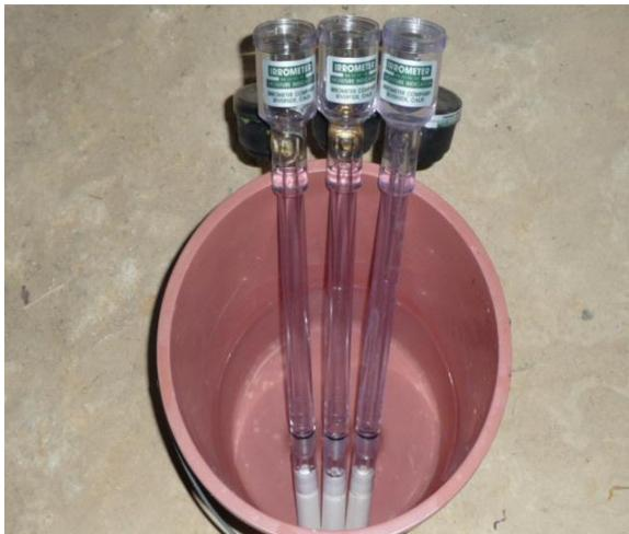
d. Llenado de tensiómetros con líquido HIRROMETER y preparación de hoyo
