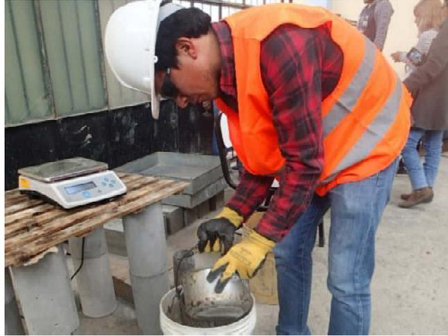
Foto 12. Ensayo de densidad relativa del agregado grueso.
