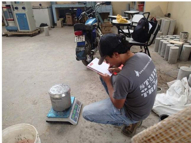
Foto 16. Determinación de la densidad del concreto fresco.
