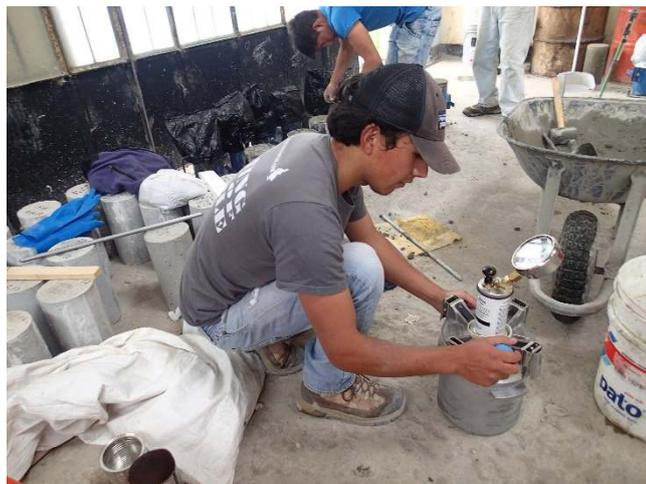
Foto 17. Ensayo del contenido de aire del concreto fresco por el método de presión.
