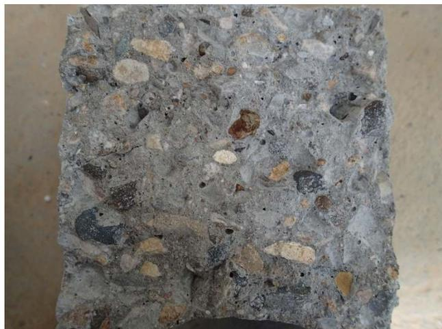
Foto 23. Sección transversal típica de un espécimen prismático.
