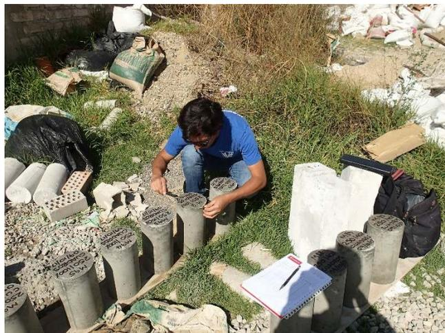
Foto 19. Identificación y medición de los testigos cilíndricos.
