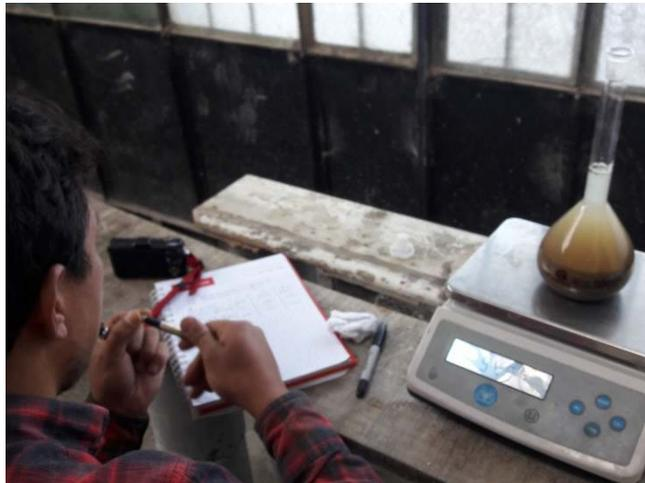
Foto 13. Ensayo de densidad relativa del AFN.
