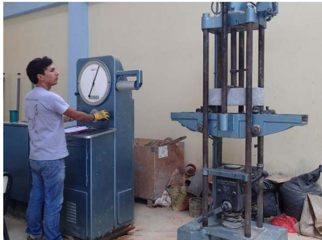
Foto 22. Rotura a flexión de especímenes prismáticos.
