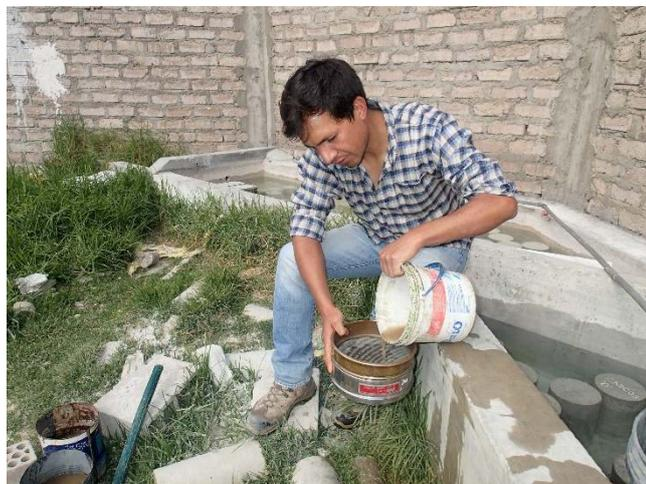
Foto 11. Lavado de AFN para determinar material  $< 75 \mu\text{m}$ .
