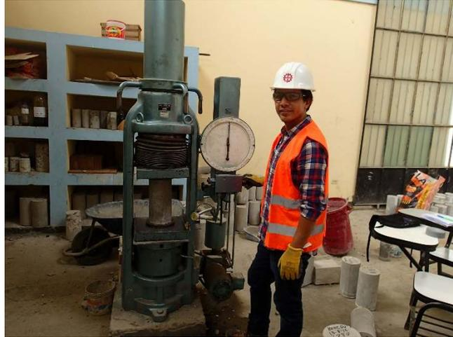
Foto 21. Rotura a compresión de especímenes cilíndricos.
