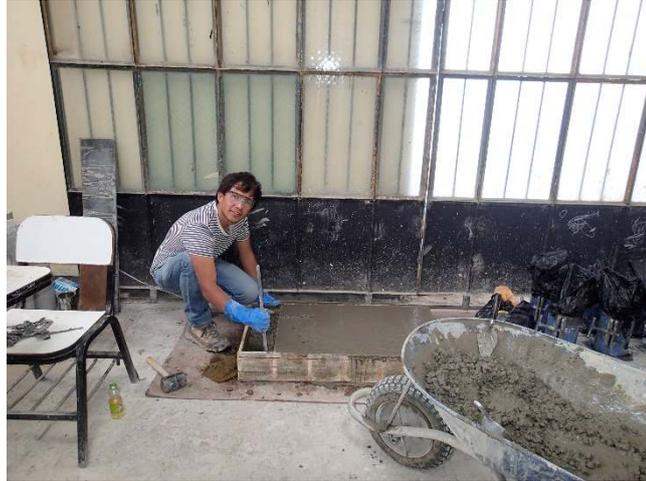
Foto 18. Moldeo de los especímenes prismáticos del concreto de control.
