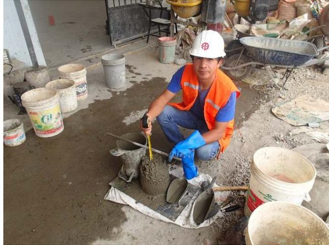
Foto 15. Ensayo de asentamiento del concreto fresco.
