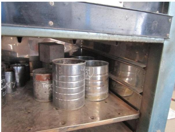
*Figura N° 39: muestras de agregado para hallar el contenido de humedad*
