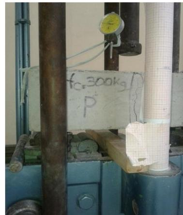
**Figura N° 66:** deformimetro- ensayo a flexión
