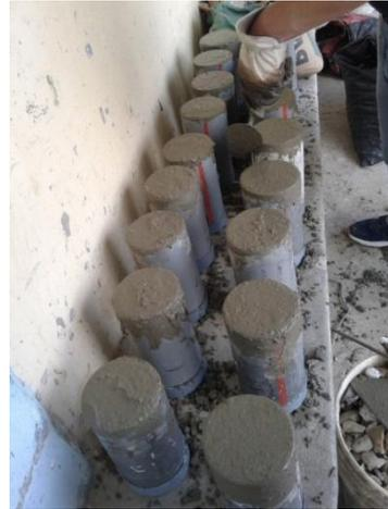
**Figura N° 57:** probetas llenas de concreto aucompactante
