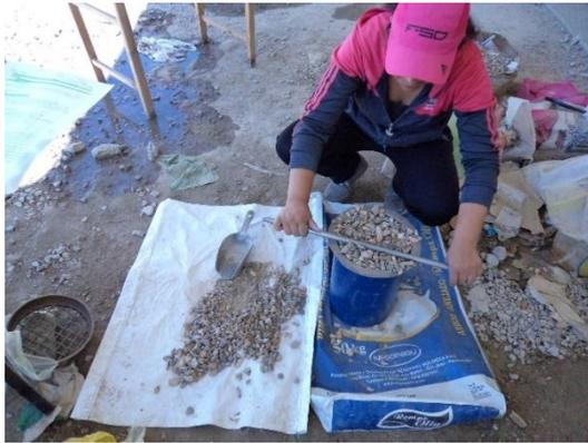
**Figura N° 44:** Ensayo de peso unitario suelto seco de los agregados fino y grueso.
