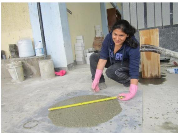
**Figura N° 49:** Ensayo de extensión de flujo - dosificación 2
