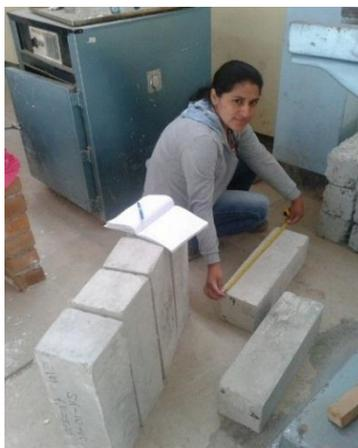
**Figura N° 67:** toma de medidas de los lados y aristas de las probetas prismáticas para el ensayo a flexión
