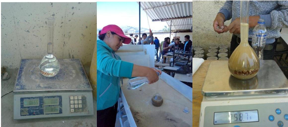
**Figura N° 43.** Ensayo de peso específico del agregado fino.
