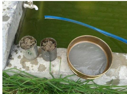
**Figura N° 41:** saya de lavado del agregado para determinar las partículas que pasan el tamiz N° 200
