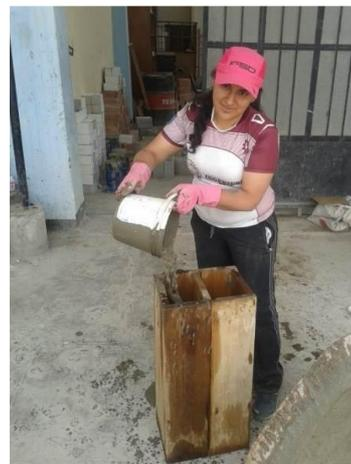
**Figura N° 55:** ensayo caja U
