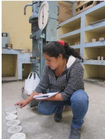
**Figura N° 62:** medición de las dimensiones de los probetas haciendo uso del vernier para hallar el diámetro y altura promedio
