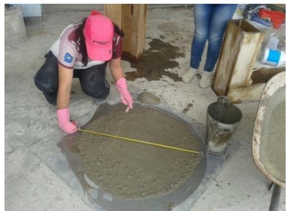
**Figura N° 48:** Ensayo de extensión de flujo - dosificación 3
