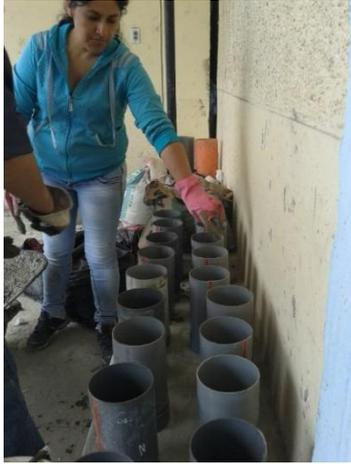
**Figura N° 56:** llenado de probetas cilíndricas para el ensayo a compresión
