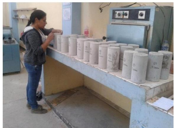
**Figura N° 61:** mitad de probetas para en el ensayo a compresión
