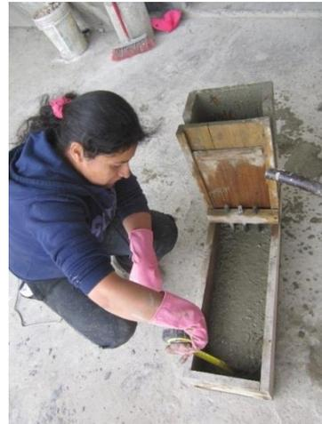
**Figura N° 52:** medida de alturas en el ensayo caja L
