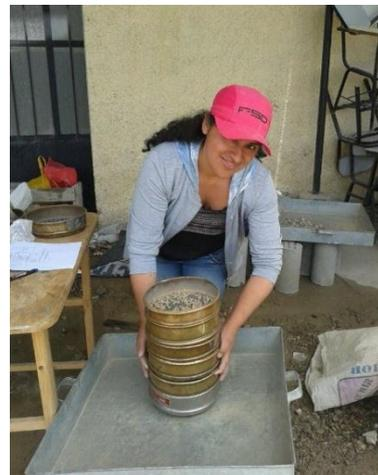
*Figura N° 38: ensayo de granulometría*
