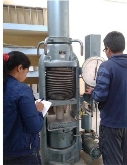
**Figura N° 63:** toma de lectura del deformimetro
