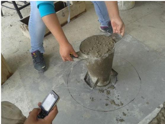
**Figura N° 46:** ensayo de asentamiento
