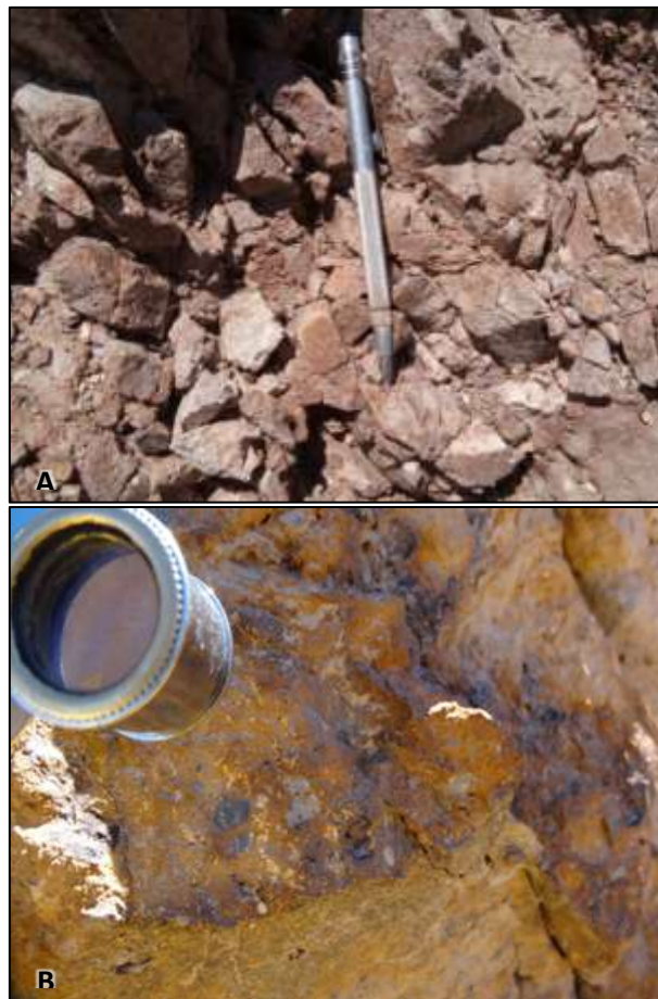
Foto 5: (A) Brecha hidrotermal alterada a sílice granular moderada con protolito andesítico. (B) Brecha hidrotermal con presencia de fragmentos poliméricos alterada a sílice granular compacta.
