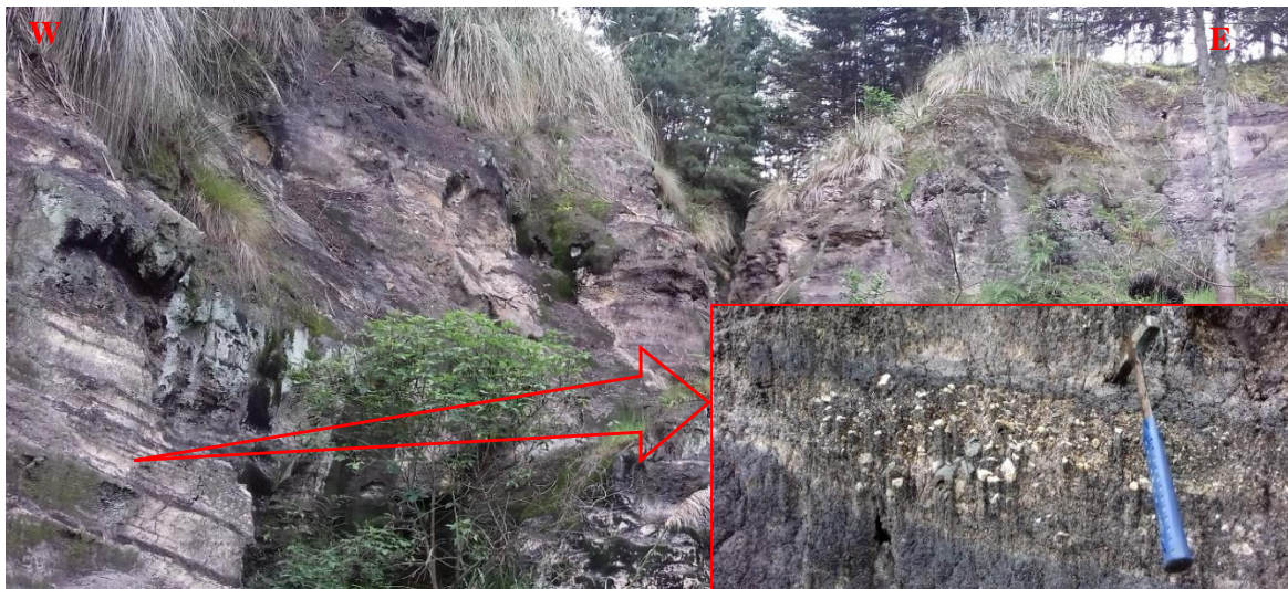
Figura 54: Ubicado en el río Porcón en el caserío de Hierba Buena; Estratificación de intercalación de clastos con materia orgánica con espesores aproximados de 5 - 10cm de materia orgánica con clastos de 30 - 50cm. de diámetro.
