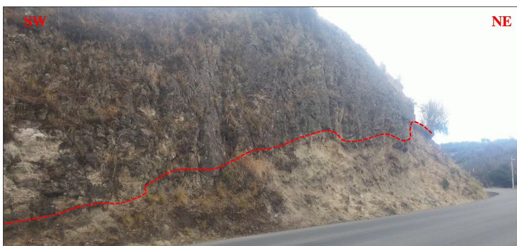
Figura 15: Dos secuencias volcánicas en contacto, en el corte de Carretera Cajamarca.-Bambamarca en el Margen Izquierdo: En la parte inferior se aprecia Depósito de bloques y Ceniza con gradación inversa de composición andesítica, de coloración grisácea. En la parte superior se evidencia Depósito de Lava con exfoliación esferoidal de composición andesítica con fracturamiento. Referencia Km. 19 +400.
