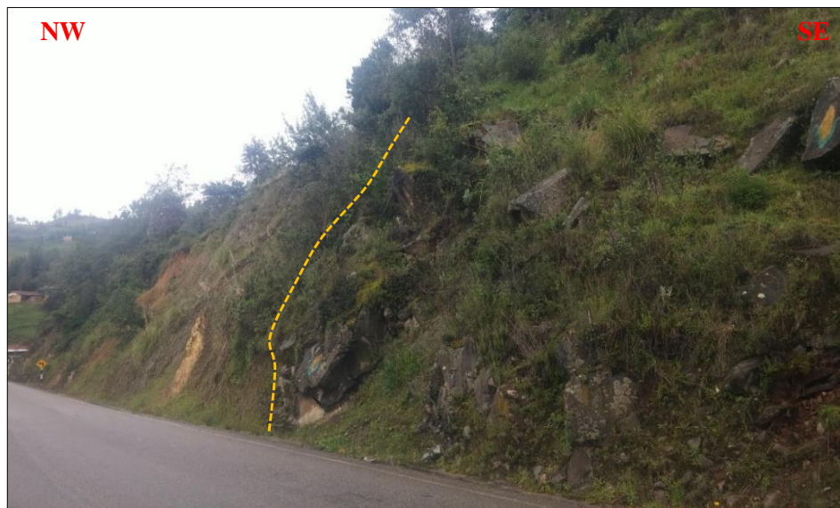
Figura 17: Se aprecia en contacto dos secuencias volcánicas: Secuencia volcánica coherente de coloración grisácea de composición andesítica y una secuencia volcánica piroclástica, de coloración pardo amarillo. Referencia Km 20 + 500.
