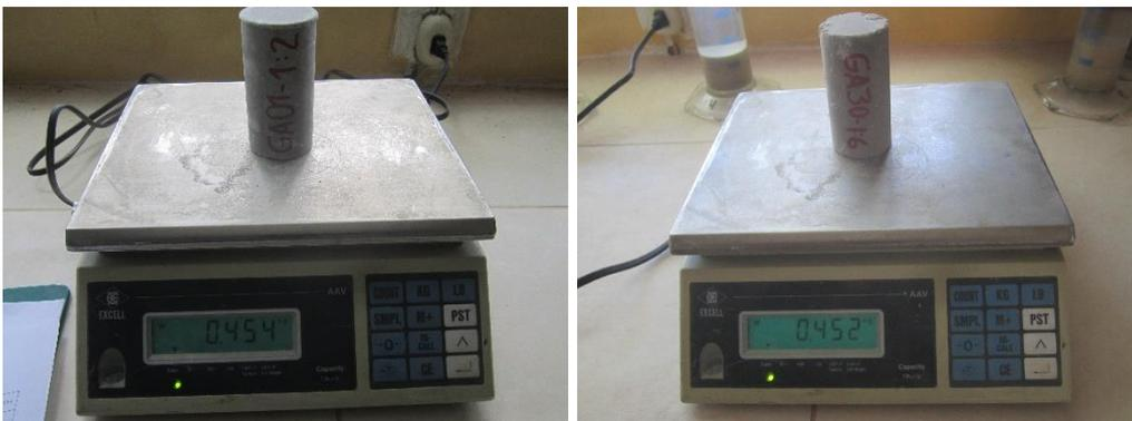
Imagen N°11. Fotografía de pesaje de los especímenes de la cantera "El Gavilán".
