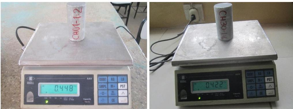
Imagen N°12. Fotografía de pesaje de los especímenes de la cantera "Río Chonta".
