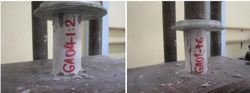
Imagen N°23. Fotografía de ensayo de resistencia a compresión de los especímenes de la cantera "El Gavilán".
