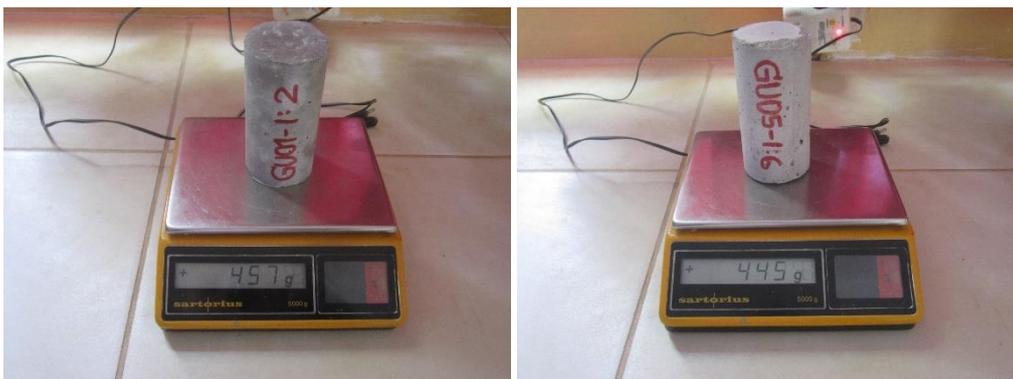
*Imagen N°18. Fotografía de pesaje de los especímenes de la cantera "El Guitarrero".*
