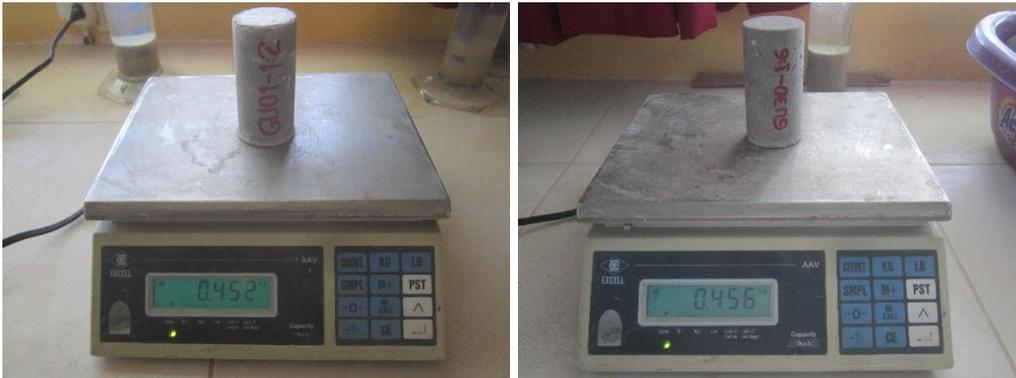
Imagen N°10. Fotografía de pesaje de los especímenes de la cantera "El Guitarrero".
