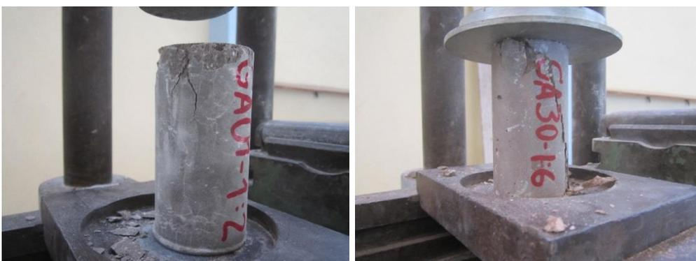
Imagen N°15. Fotografía de ensayo de resistencia a compresión de los especímenes de la cantera "El Gavilán".
