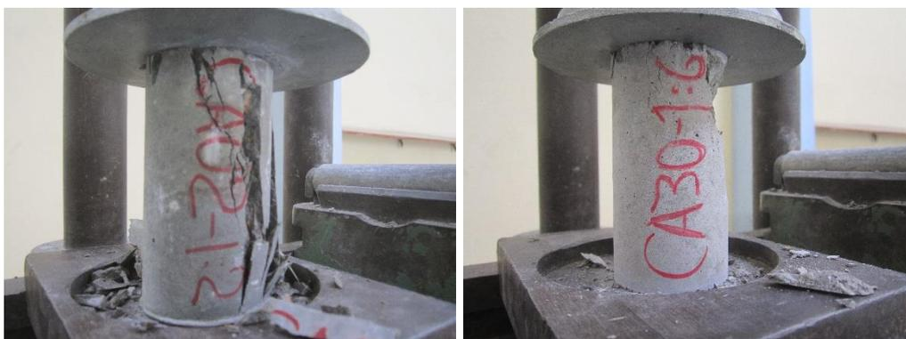
Imagen N°17. Fotografía de ensayo de resistencia a compresión de los especímenes de la cantera "Río Cajamarquino".
