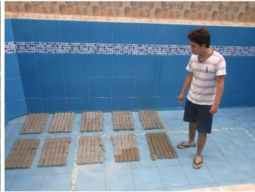
*Imagen N°7. Fotografía de la elaboración y curado de especímenes de mortero de la cantera “El Gavilán”.*
