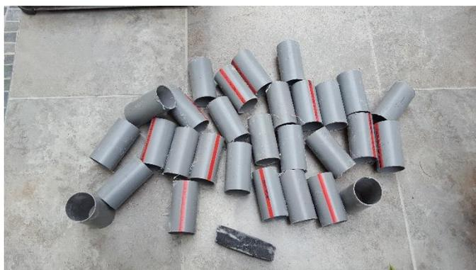
Figura N° 18. Moldes para la elaboración de especímenes de mortero.
