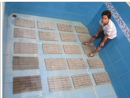
*Imagen N°9. Fotografía de la elaboración y curado de especímenes de mortero de la cantera “Río Cajamarquino”.*
