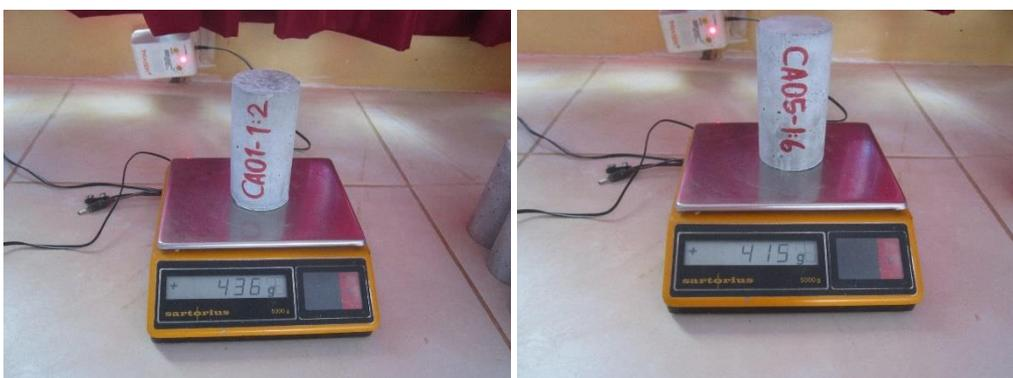
*Imagen N°21. Fotografía de pesaje de los especímenes de la cantera "Río Cajamarquino".*
