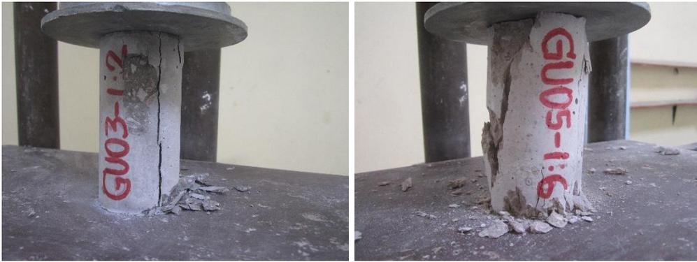
Imagen N°22. Fotografía de ensayo de resistencia a compresión de los especímenes de la cantera "El Guitarrero".
