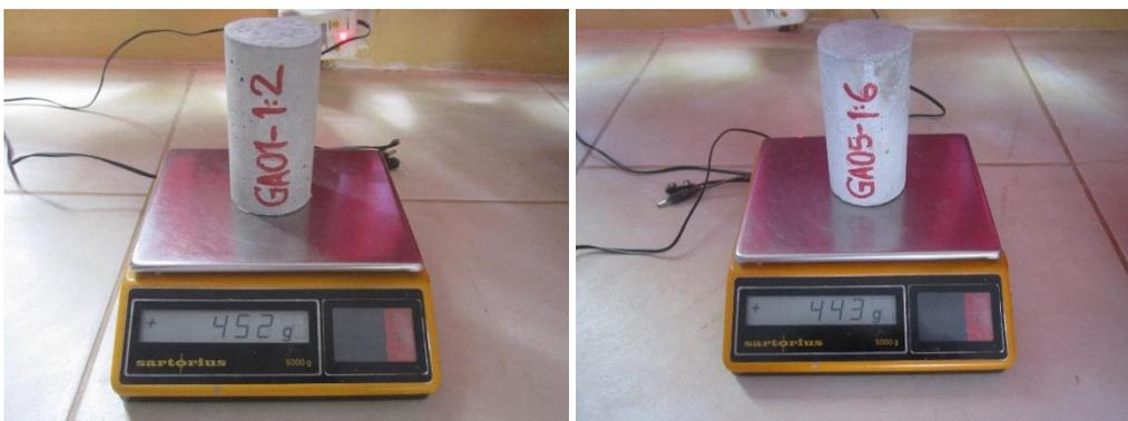
*Imagen N°19. Fotografía de pesaje de los especímenes de la cantera "El Gavilán".*
