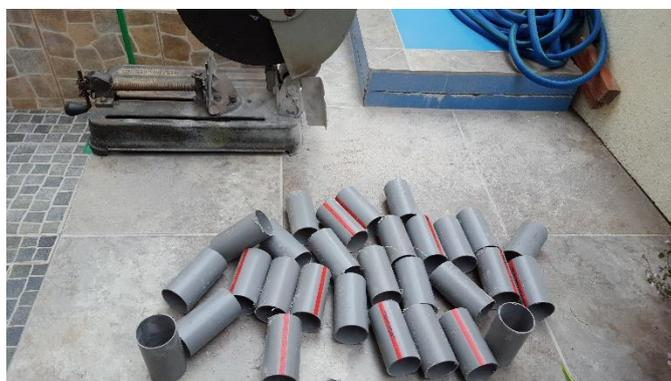
*Imagen N°3. Fotografía de los moldes para elaboración de especímenes de mortero.*
