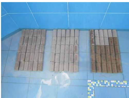
Imagen N°6. Fotografía de la elaboración y curado de especímenes de mortero de la cantera "El Guitarrero".
