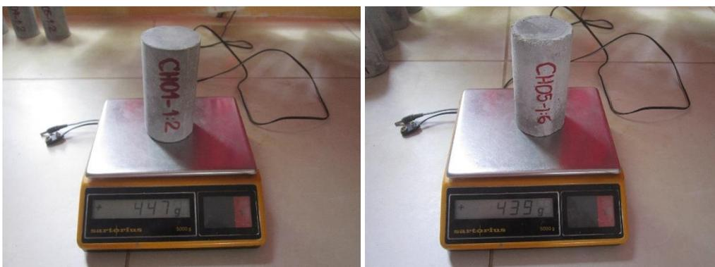
*Imagen N°20. Fotografía de pesaje de los especímenes de la cantera "Río Chonta".*
