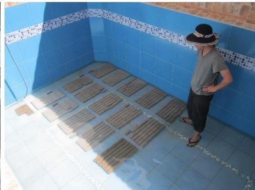
*Imagen N°8. Fotografía de la elaboración y curado de especímenes de mortero de la cantera “Río Chonta”.*
