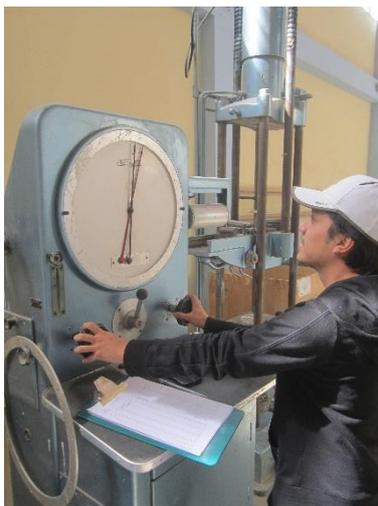
Figura N° 17. Máquina Universal de ensayo a compresión axial.
