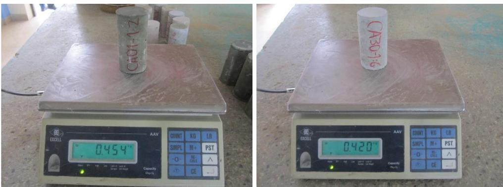
Imagen N°13. Fotografía de pesaje de los especímenes de la cantera "Río Cajamarquino".
