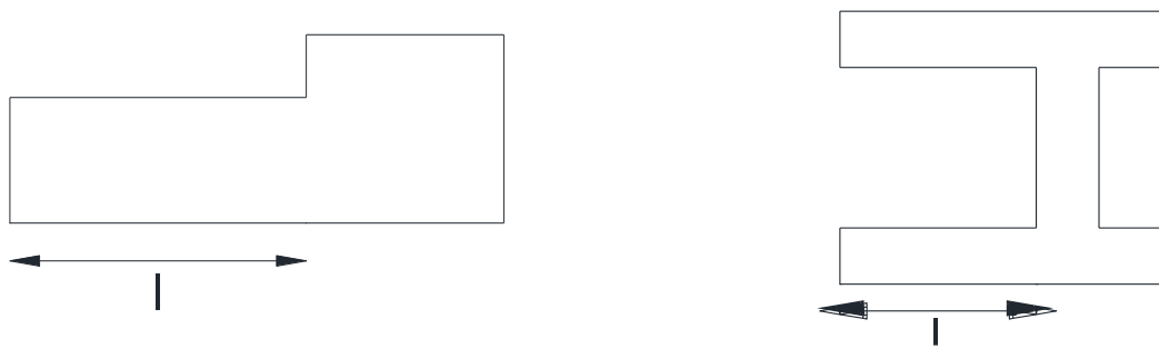
Figura 2.8. Longitud que se considera en las plantas tipo L, T, U y similares
