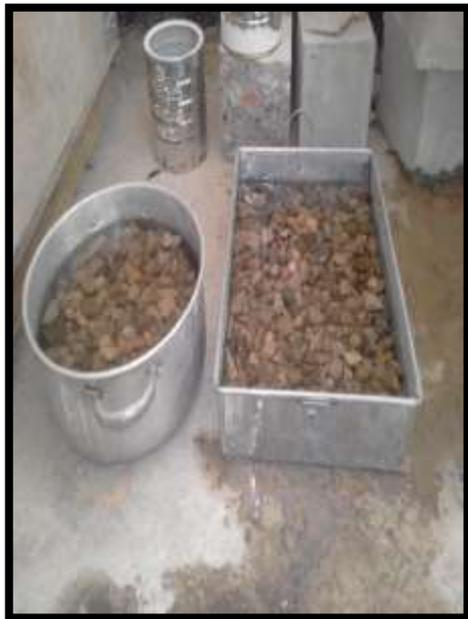
**FOTO N°3:** Agregado grueso sumergido en agua por 24 horas para el cálculo del peso específico.
