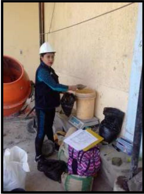
**FOTO N°13:** Obtención del peso de los materiales para la elaboración de la mezcla para probetas de concreto simple ( $f'c = 175 \text{ kg/cm}^2$ )
