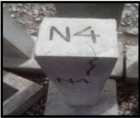
**FIGURA 34: Falla de columna encamisada.**
