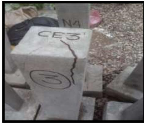
**FIGURA 35: Falla desde el núcleo de columna encamisada (comportamiento monolítico)**
