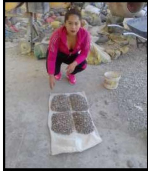
**FOTO N°2:** Reducción del agregado grueso con la práctica de la norma ASTM C702-98(2003), realizando el cuarteo de muestras.
