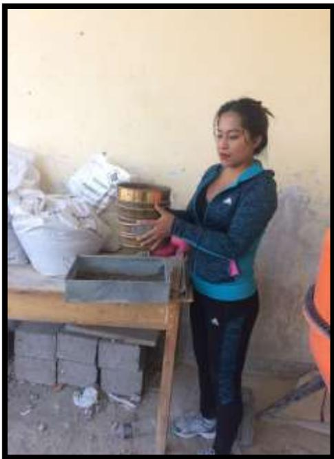
**FOTO N°6:** Ensayo de Granulometría del agregado grueso, mediante el tamizado de acuerdo a la norma ASTM C136/C136M-05 y a su análoga la NTP 400.012.
