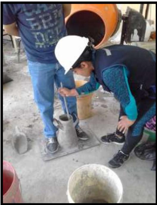
**FOTO N°15:** Medición de asentamiento o slump mediante el ensayo del Cono de Abrams.
