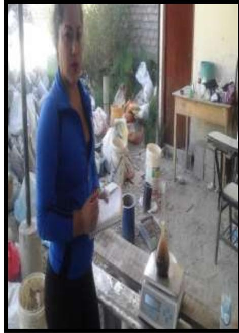
**FOTO N°10:** Cálculo del Peso Específico Aparente del agregado fino, según la NTP 400.022 y su análoga la norma ASTM C 128.
