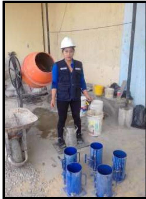
**FOTO N°16:** Llenado de probetas cilíndricas.
