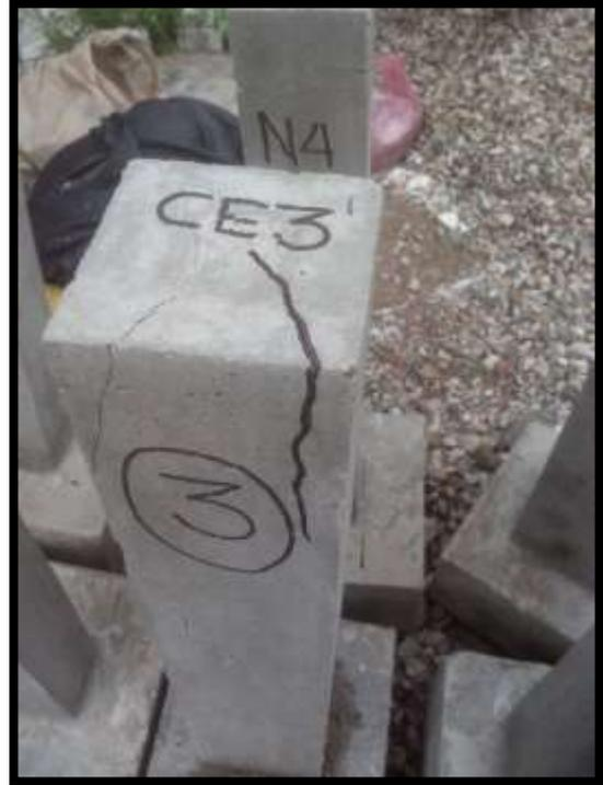
**FOTO N°47:** Falla de la columneta encamisada después del ensayo a compresión.
