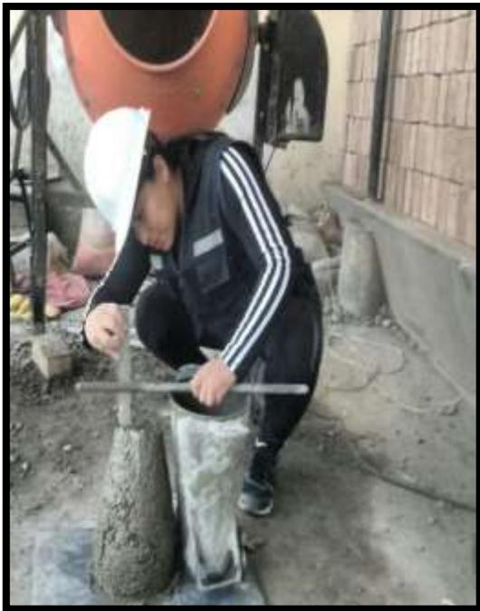
**FOTO N°32:** Preparación de mezcla para columnetas núcleo con concreto  $f'c = 175$  kg/cm<sup>2</sup>. Ensayo del cono de Abrams para medir el asentamiento o slump.
