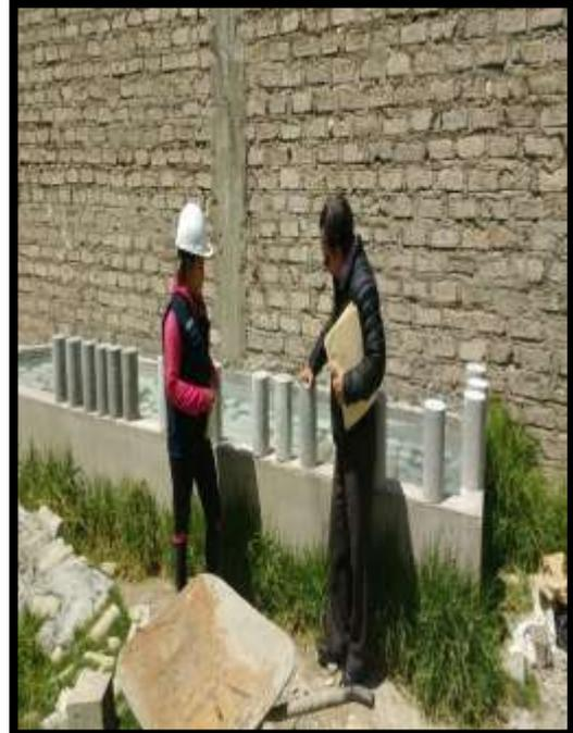
**Foto N°19:** Retiro de probetas de la poza de curado para su posterior ensayo a compresión, bajo la supervisión del asesor.
