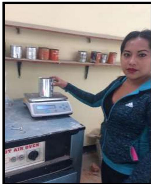
**FOTO N°12:** Cálculo del contenido de humedad según la norma ASTM C566-97(2004) o su análoga la norma NTP 339.185.
