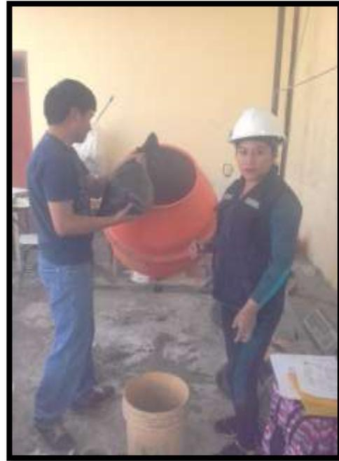
**FOTO N°14:** Elaboración de la mezcla para probetas de concreto simple ( $f'c = 175 \text{ kg/cm}^2$ )
