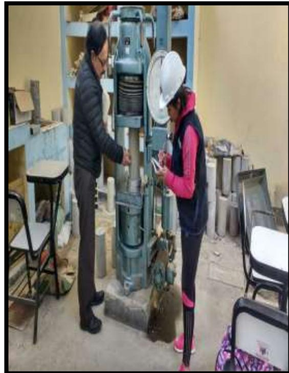
**FOTO N°20 Y 21:** Ensayo a compresión de probetas de concreto simple ( $f'c=175 \text{ kg/cm}^2$ )
