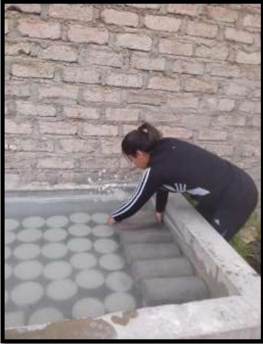
**Foto N°18:** Introducción de probetas en el agua para su respectivo curado, poza de curado UNC.
