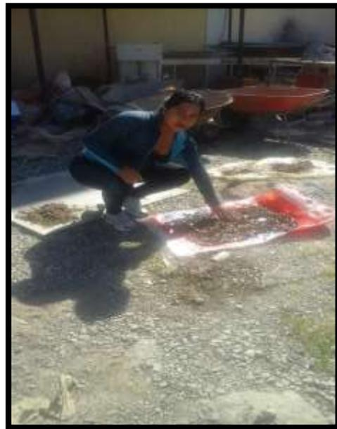
**FOTO N°4:** Secado al aire del agregado grueso, para la obtención del peso específico saturado superficialmente seco, según la norma NTP 400.021 y su análoga la norma ASTM C 127.
