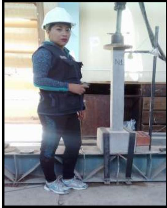
**FOTO N°35:** Ensayo a compresión de las columnetas núcleo, a los 28 días de edad.
