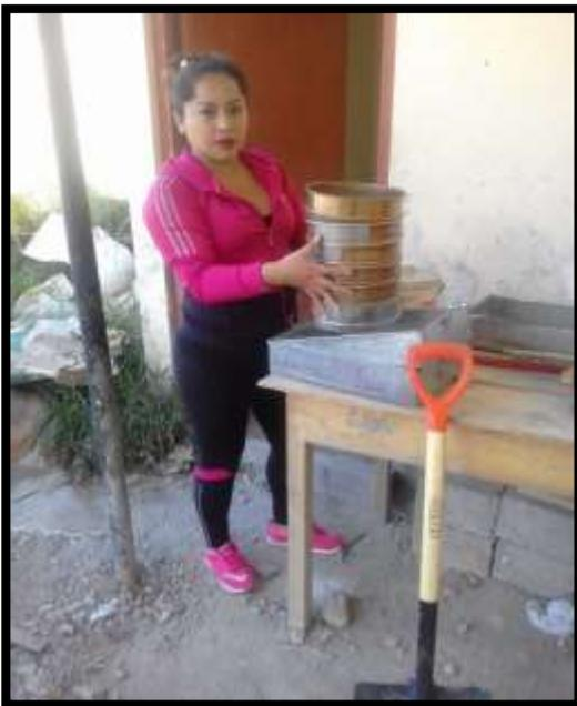
**FOTO N°11:** Ensayo de Granulometría del agregado fino, mediante el tamizado de acuerdo a la norma ASTM C136/C136M-05 y a su análoga la NTP 400.012
