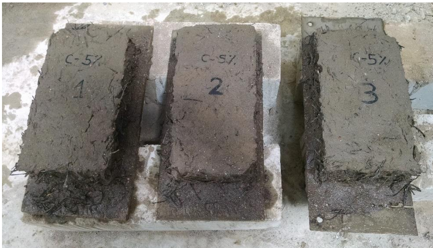
Figura 23. Bloques de adobe con adición de caucho, luego de ser sometidos al ensayo de Saturación Total
