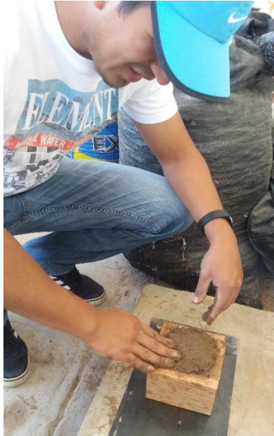
Figura 10. Colocación de la mezcla en adobera cúbica.
