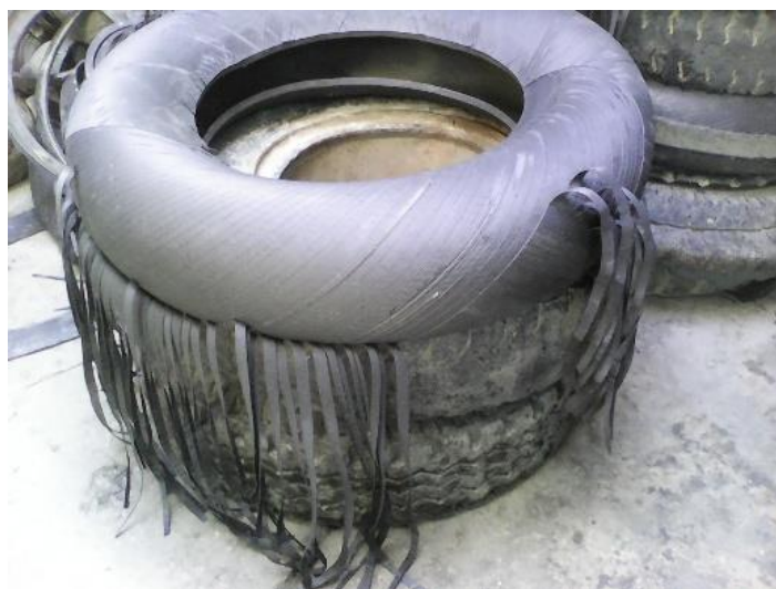
Figura 6. Obtención de tiras de caucho de un neumático usado.
