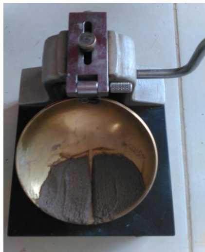
Figura 3. Copa de Casagrande con muestra de suelo, ensayo LL.
