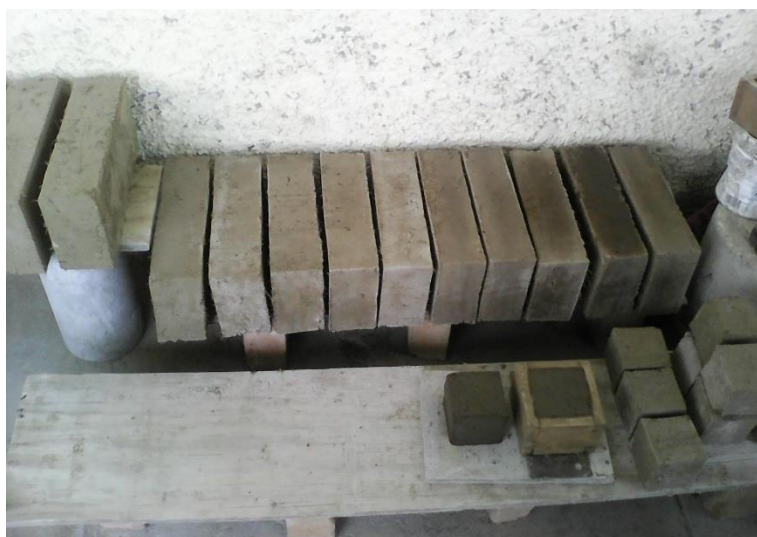
Figura 15. Almacenamiento de los bloques de adobe.
