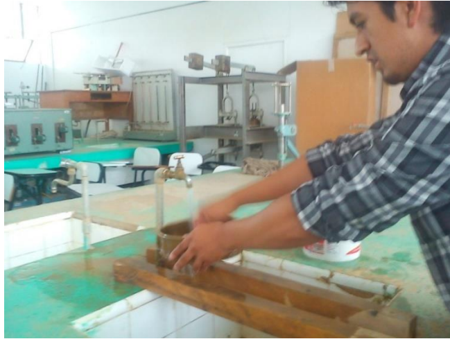
Figura 1. Ensayo de Granulometría por método de lavado.
