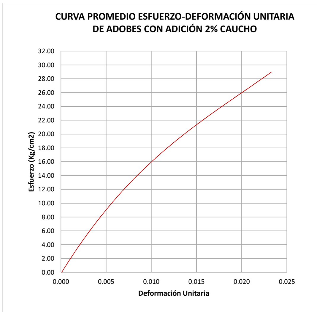
Gráfico 9. Curva Promedio Esfuerzo-Deformación Unitaria de Adobes con Adición de 2% Caucho
