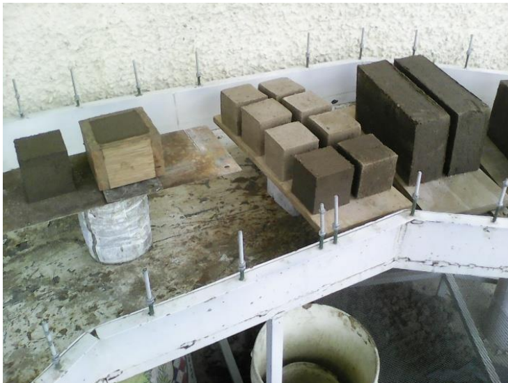
Figura 14. Bloques de adobe en el proceso de secado.
