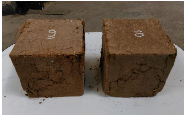
Figura 17. Bloques de adobe luego de ser sometidos al ensayo de compresión.
