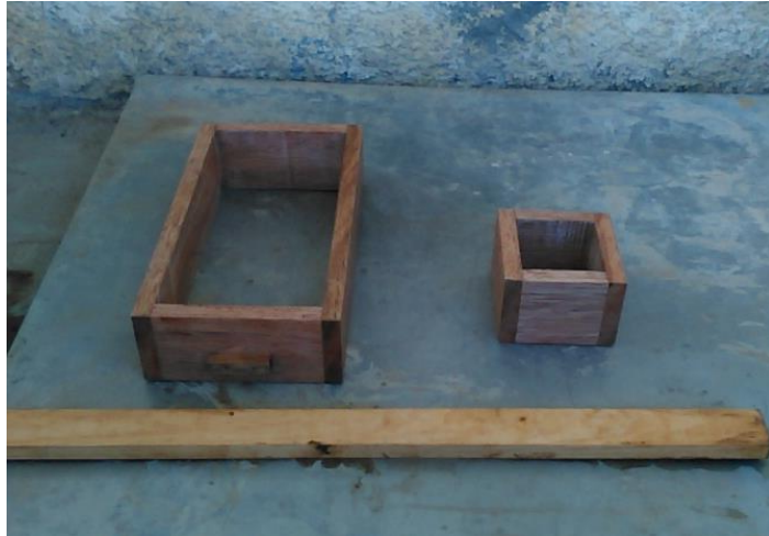
Figura 4. Adoberas y regla de madera para elaboración de los adobes.
