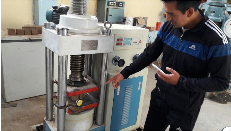
Figura 16. Ejecución del ensayo a compresión de los bloques de adobe.
