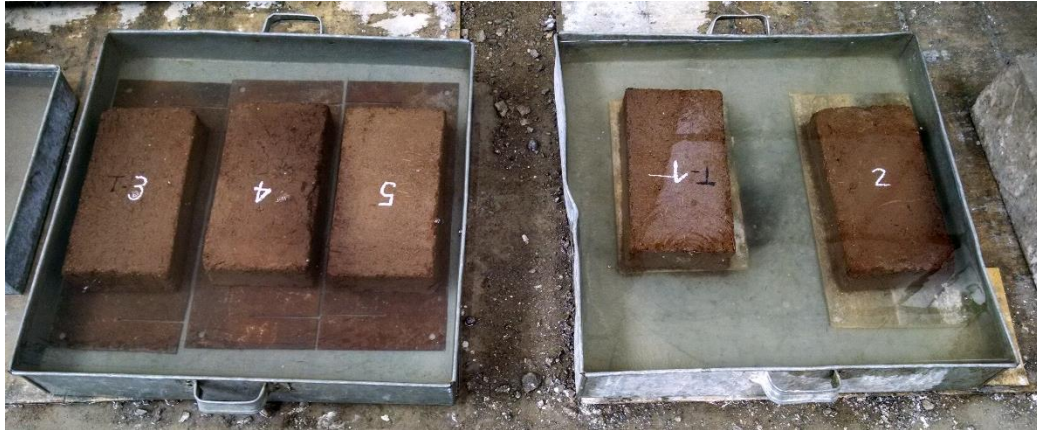
Figura 22. Bloques de adobe tradicionales sumergidos en agua para el ensayo de Saturación Total.
