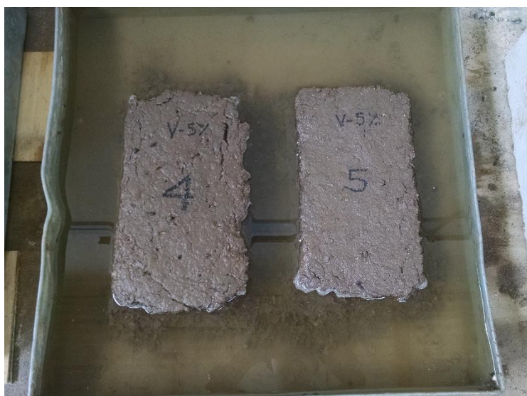
Figura 24. Bloques de adobe con adición de viruta, luego de transcurridas las 24 horas de saturación.
