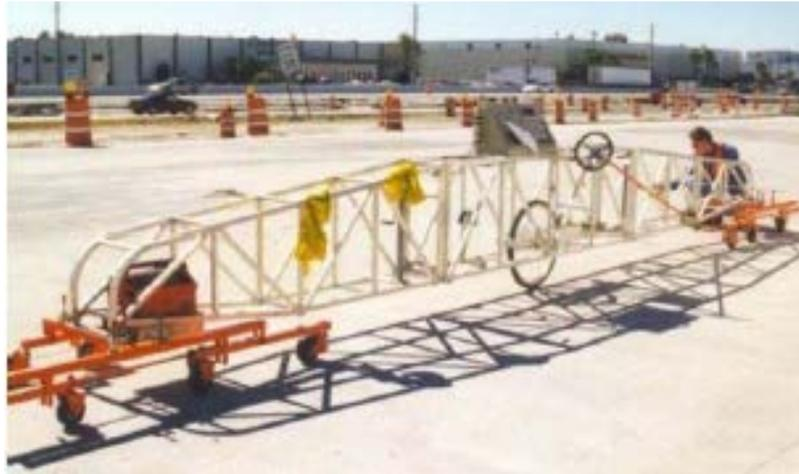
**Figura 2.12.** Perfilómetro estático (Nava,2007)
