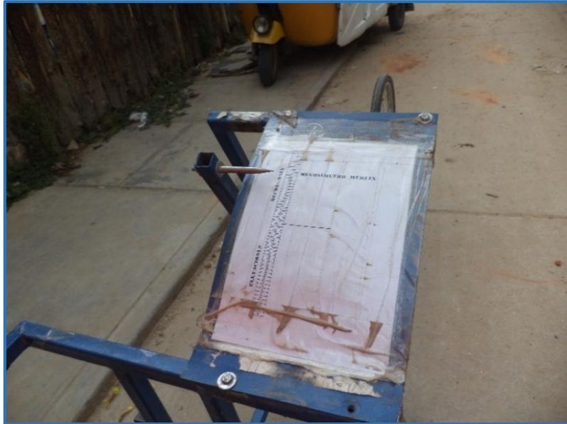
**Figura 2.18.** Tablero de Equipo Merlin en campo
