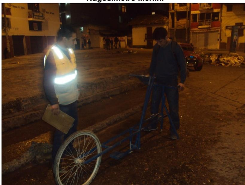
**Fotografía N°02.- PROGRESIVA 0+020 Tomada de Datos con el Rugosímetro Merlin**
