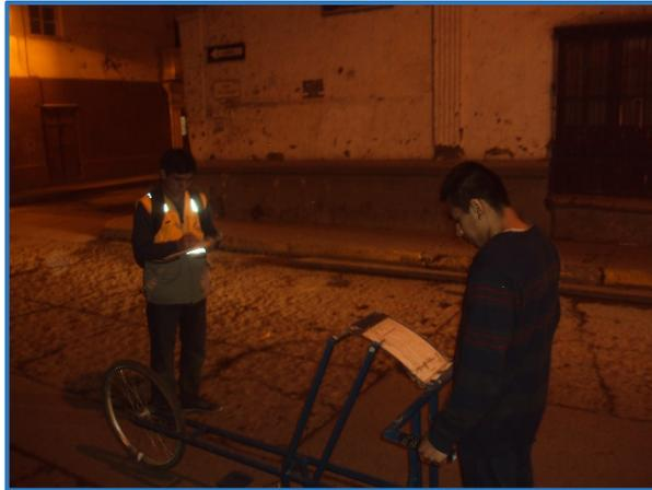
**Figura. 3.13.** Manejo del Rugosímetro
