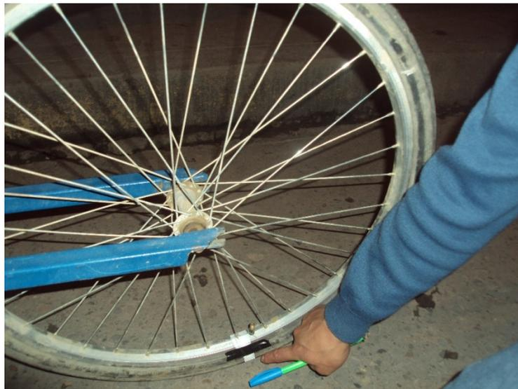
**Fotografía N°06.- Intervalo representativo como longitud promedio del Rugosímetro LC = 1.80 m**
