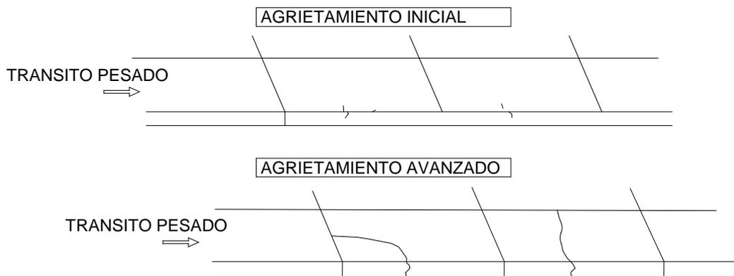
**Figura 2.4** Patrón de agrietamiento
