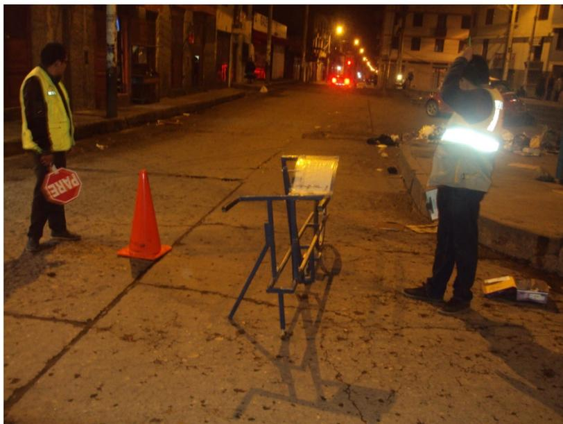
**Fotografía N°01. PROGRESIVA 0+000.00 Inicio de la toma de datos de campo con el Rugosímetro Merlin.**
