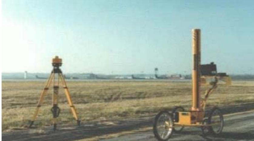
**Figura 2.11.** Sistema de adquisición de datos con nivel y mira en pavimentos (Nava,2007)
