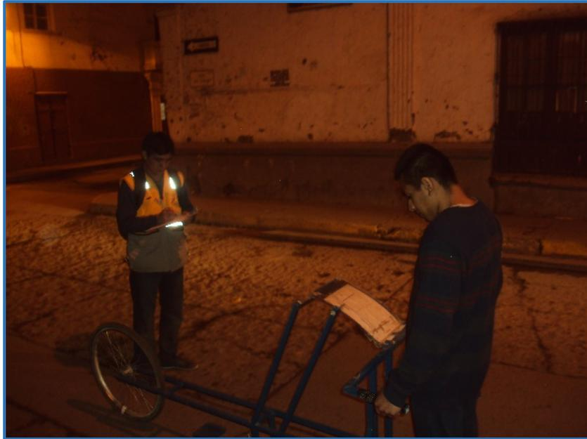
**Figura. 2.20.** Manejo del Rugosímetro
