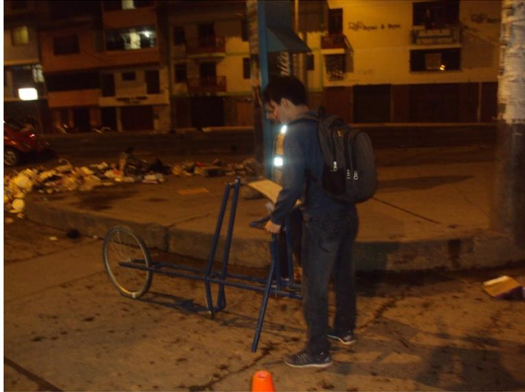
Fotografía N°03.- Operador con el equipo Rugosímetro Merlin
