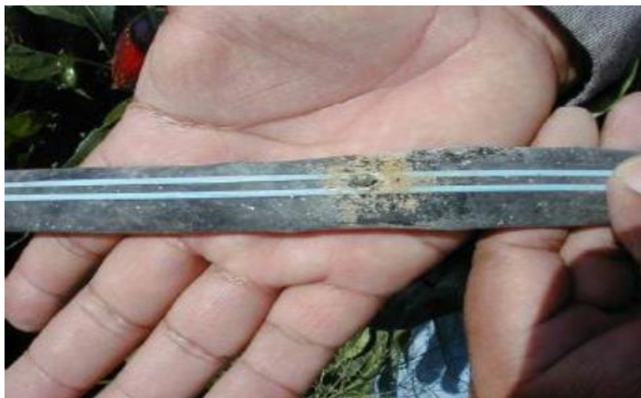
Foto 7. Obstrucción de gotero por acumulación de arcillas en suspensión.
