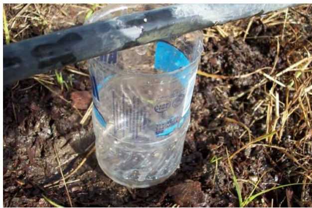
Foto 2. Aforo del gotero de la cinta "B", a 2d/3.
