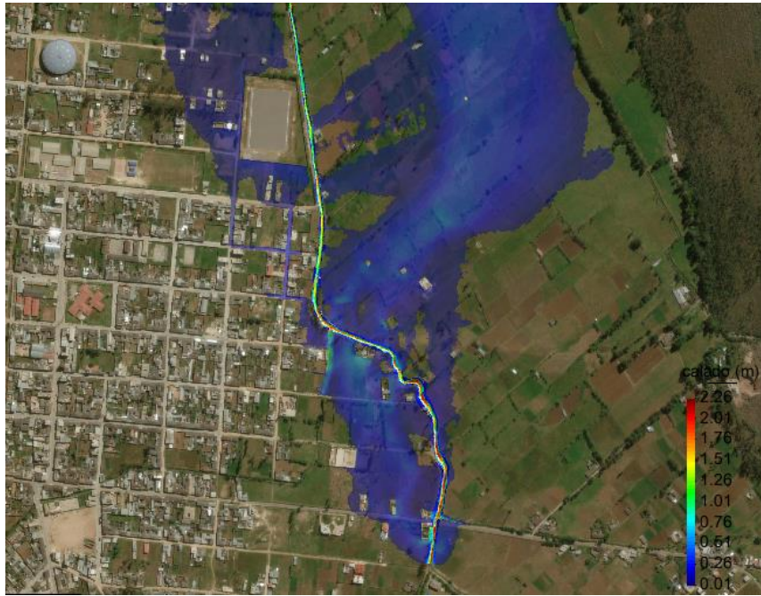
Figura 27: Tirantes de agua para un caudal de 71 m 3 /s y riesgo de falla de 30%
