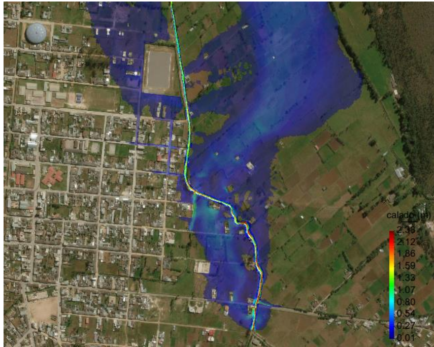
Figura 33: Tirantes de agua para un caudal de 88.4 m 3 /s y riesgo de falla de 5%
