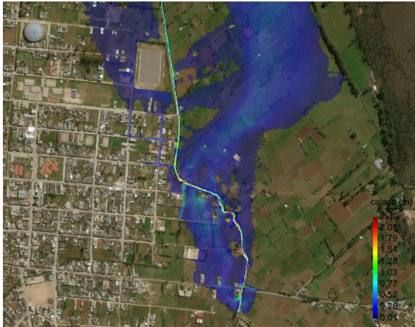
Figura 31: Tirantes de agua para un caudal de 77.6 m 3 /s y riesgo de falla de 15%
