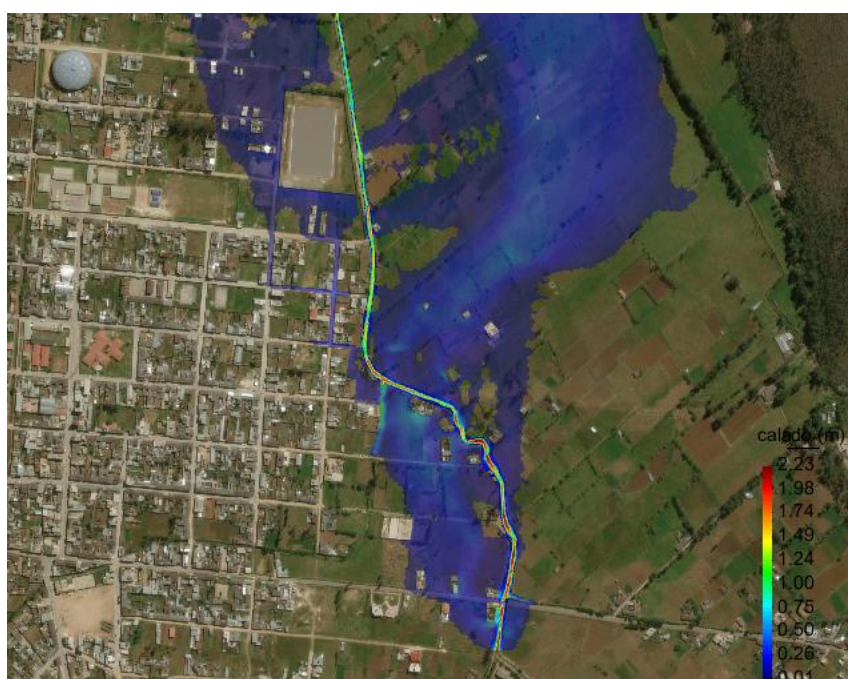
Figura 26: Tirantes de agua para un caudal de 68.2 m 3 /s y riesgo de falla de 40%
