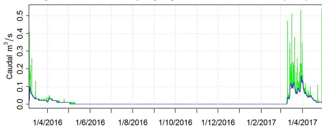
Figura 62. En esta figura se presenta el caudal total en color verde y el caudal base en color azul, para la estación Majadapampa con el método de Lyne y Hollick.
