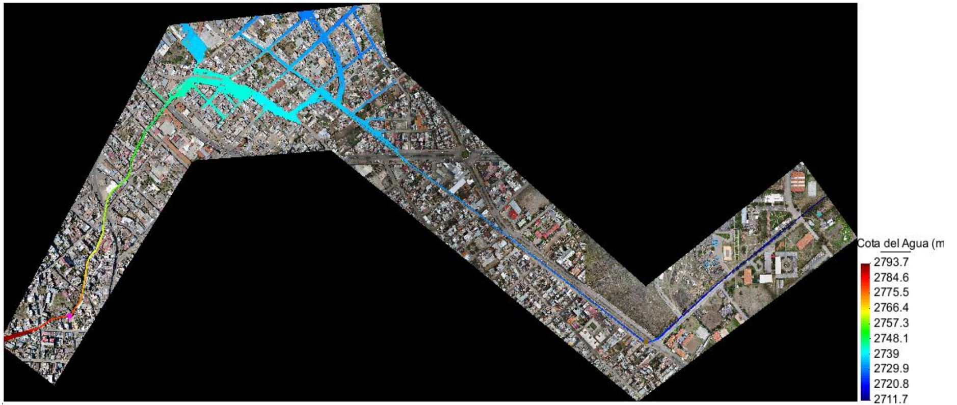
Figura 65: Mapa de Cotas de Agua producto de la inundación en la zona de estudio al finalizar el modelamiento
