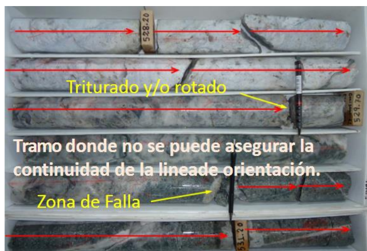
Fotografía N° 01: Orientación de testigos en Perforaciones.
