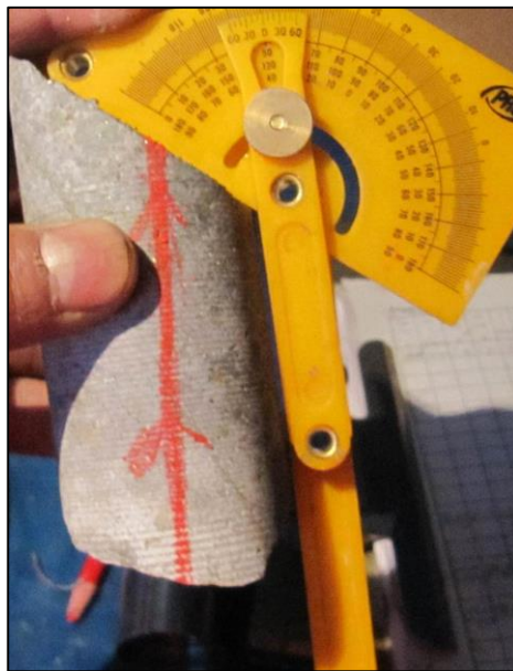
Fotografía N° 02: Medición del Ángulo Alfa.
