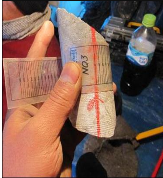
Fotografía N°03: Medición del Ángulo Beta.
