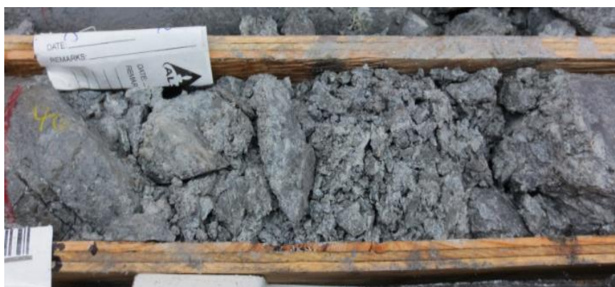
Foto N° 08: Muestra de Fallamiento de extensión de 400 mm, en perforación orientada del proyecto Cañariaco
