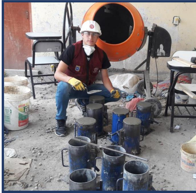
**Figura 44:** Sacado de los especímenes del molde.
