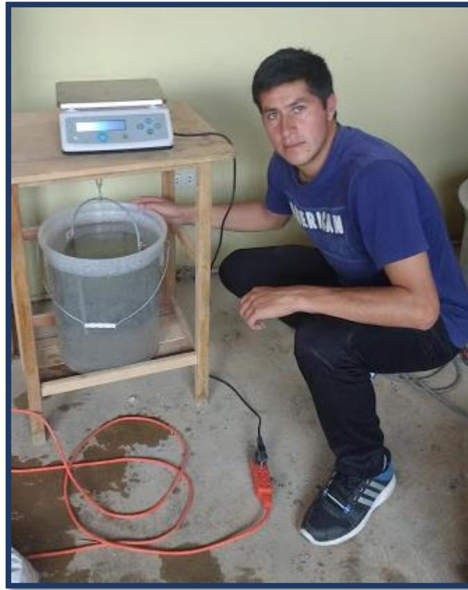
**Figura 34:** Fabricación de la máquina de curado acelerado, método B de la NTP 339.213.
