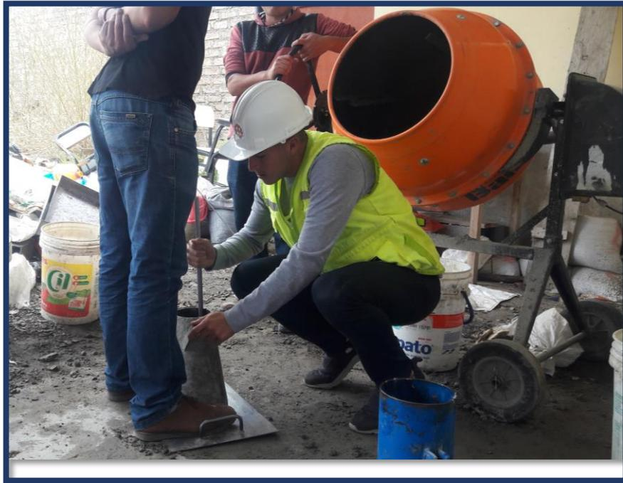
**Figura 42:** Ensayo de Slump de la mezcla de concreto.
