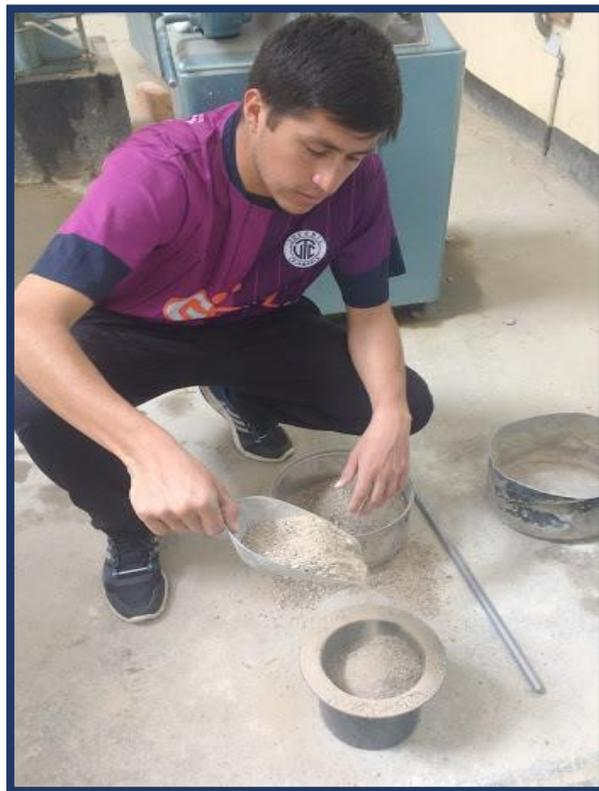
**Figura 33:** Ensayo de peso específico del agregado grueso.
