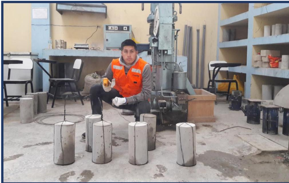
**Figura 53:** Rotura de espécimen de concreto, ensayo a compresión axial.
