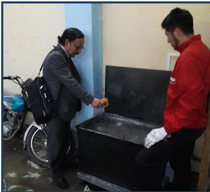
**Figura 51:** Con el pirómetro calculamos la temperatura del espécimen al momento de sacarla de la máquina de curado acelerado.
