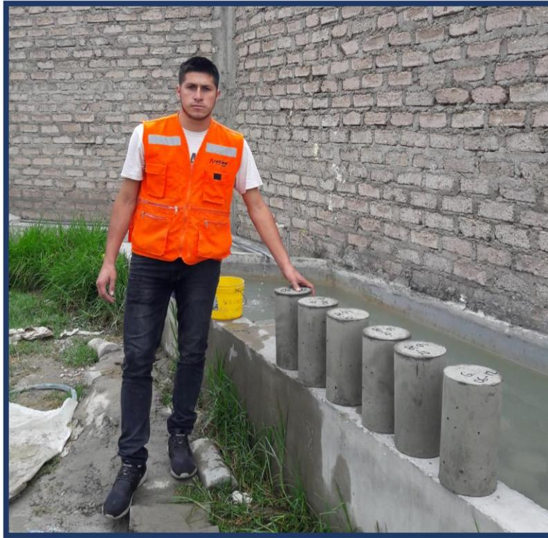
**Figura 46:** Especímenes acondicionados con alambre, para ser curados por el método B de la NTP 339.213
