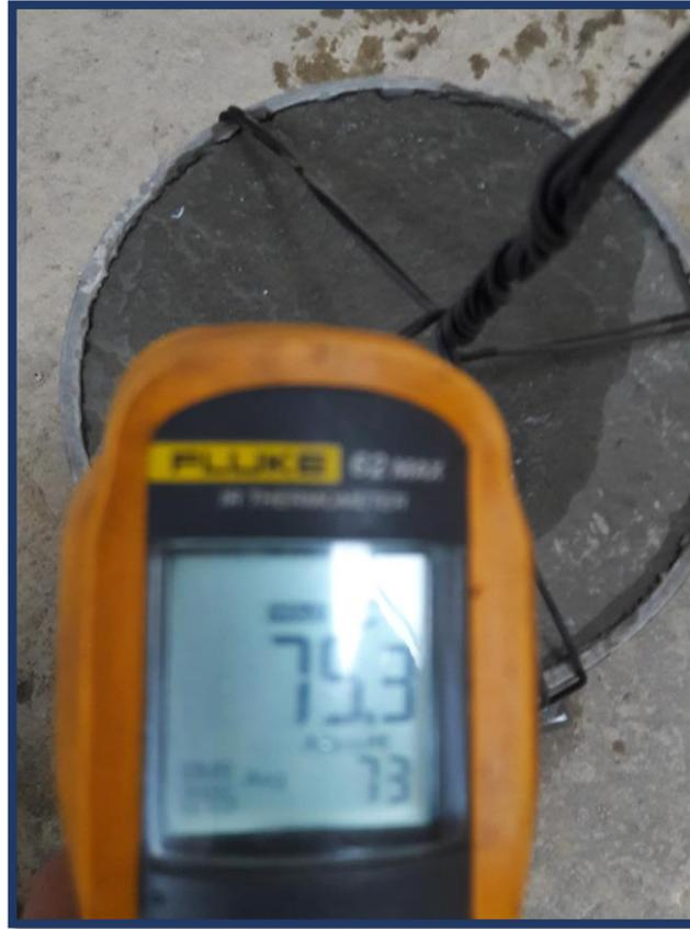
**Figura 52:** Especímenes luego de haber sido sacados de la máquina de curado acelerado del método B de la NTP 339.213.
