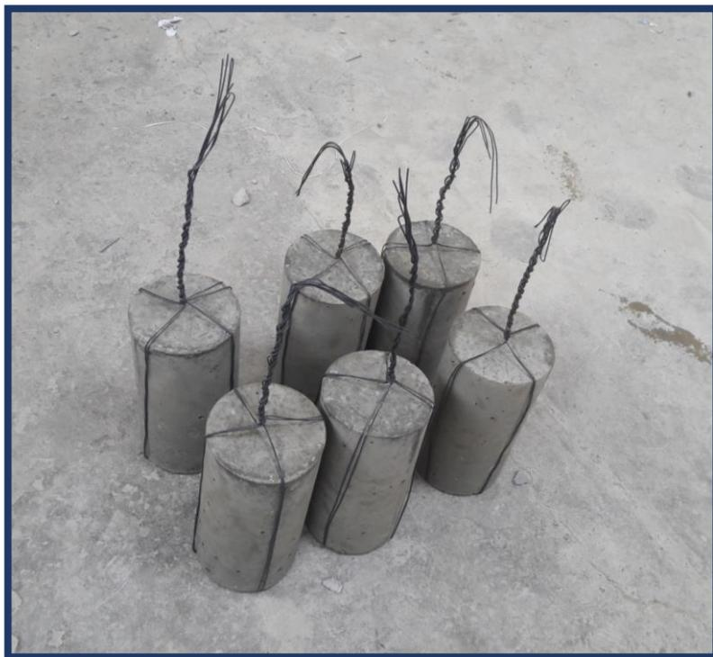
**Figura 47:** Instrucción de los especímenes a la máquina de curado acelerado, cuando el agua se encuentra hirviendo.
