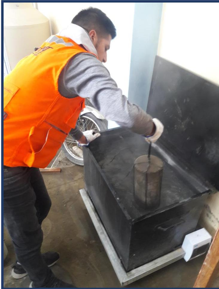
**Figura 48:** Especímenes sometidos al curado acelerado con agua hirviendo.
