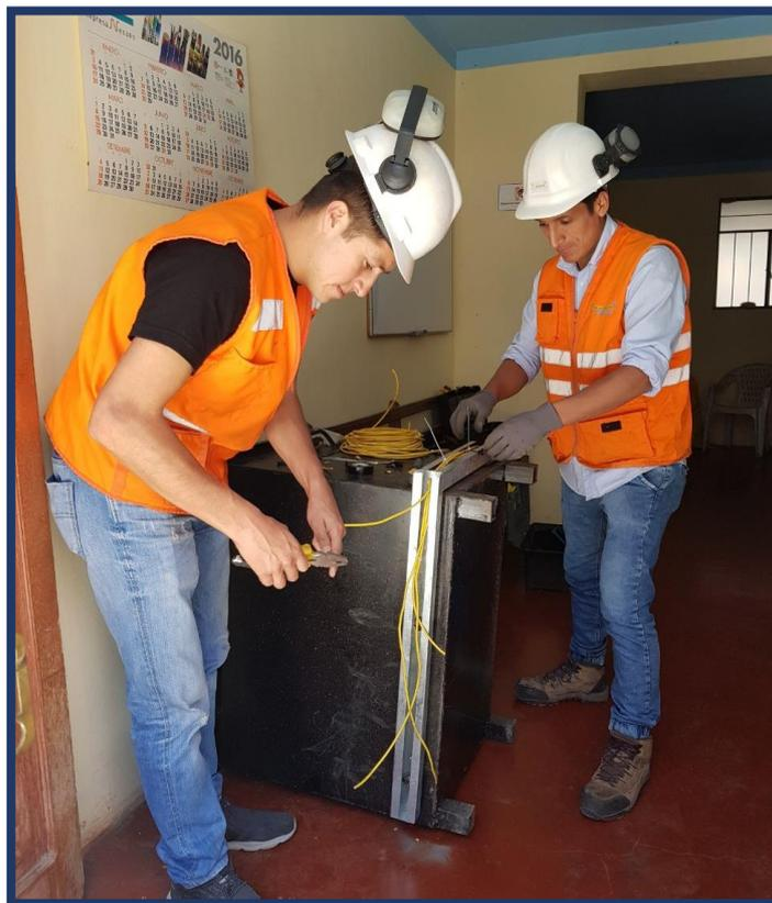
**Figura 37:** Instalación de la máquina de curado acelerado, método B de la NTP 339.213, en el laboratorio Carlos Esparza de la Facultad de Ingeniería.
