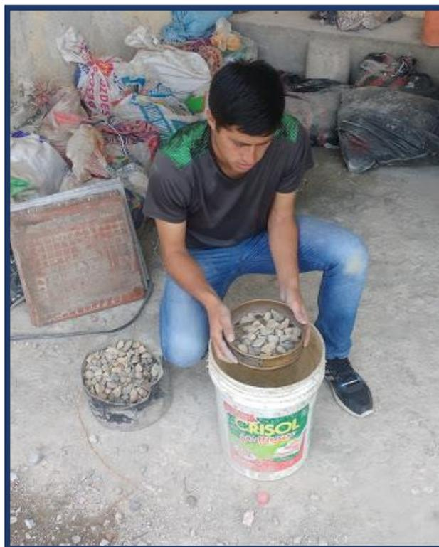
**Figura 31:** Ensayo de peso unitario compactado del agregado fino.
