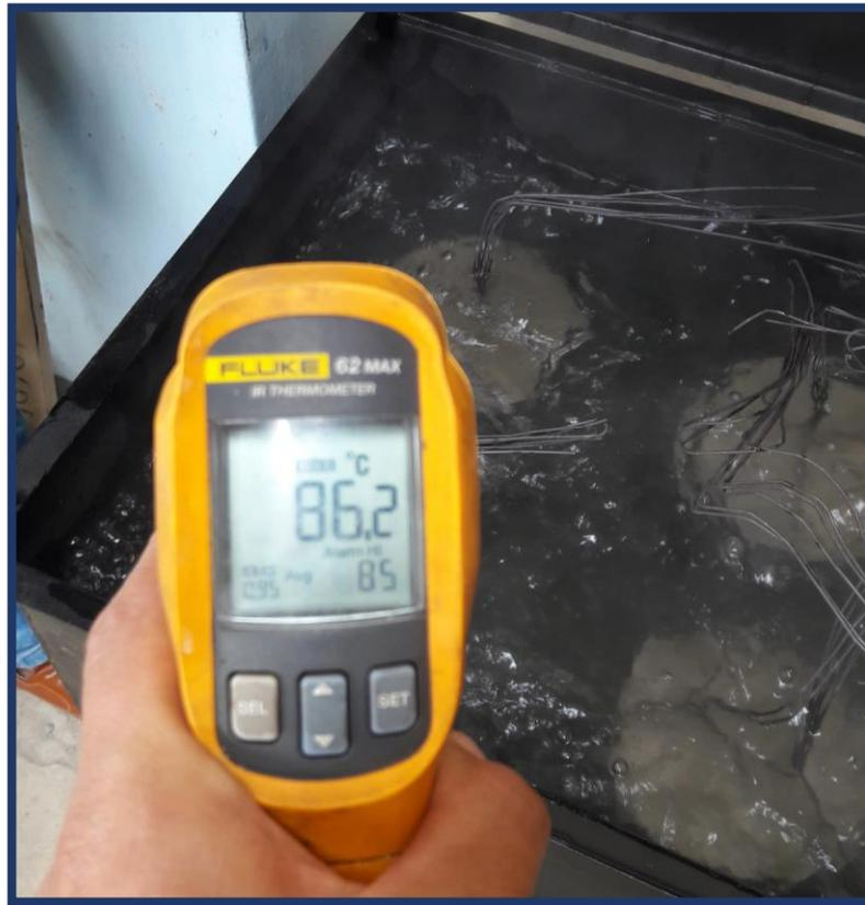
**Figura 50:** Mcs. Héctor Pérez, comprobando la temperatura en el ensayo de curado acelerado.
