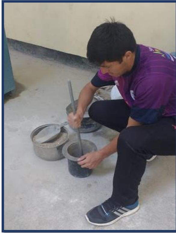
**Figura 32:** Ensayo de peso unitario suelto del agregado fino.
