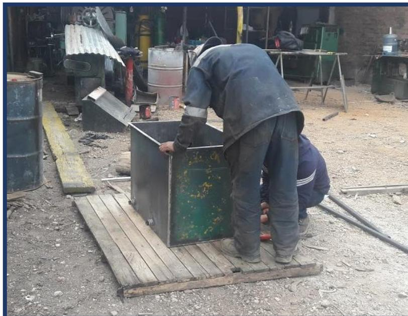
**Figura 35:** Fabricación de la máquina de curado acelerado, método B de la NTP 339.213.
