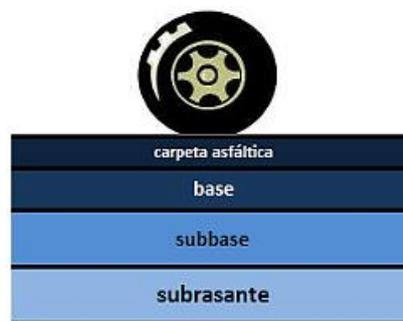
Esquema típico del paquete estructural de un pavimento flexible.
