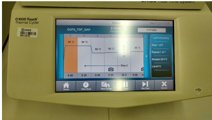
Figura 17. Ciclos de la reacción en cadena de polimerasa en tiempo real indicando temperaturas de cada fase.
