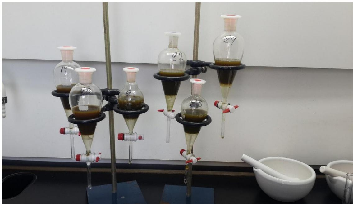
FIGURA 12: Extracción de la muestra con éter
