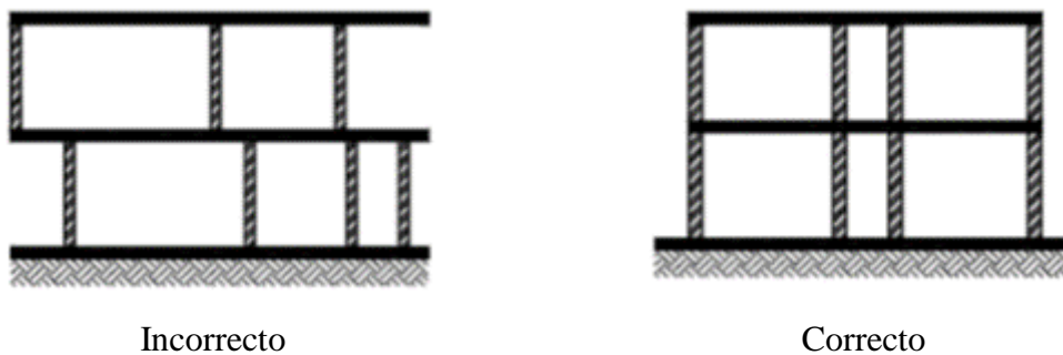
Figura 15. Continuidad de muros para transmisión de cargas.
