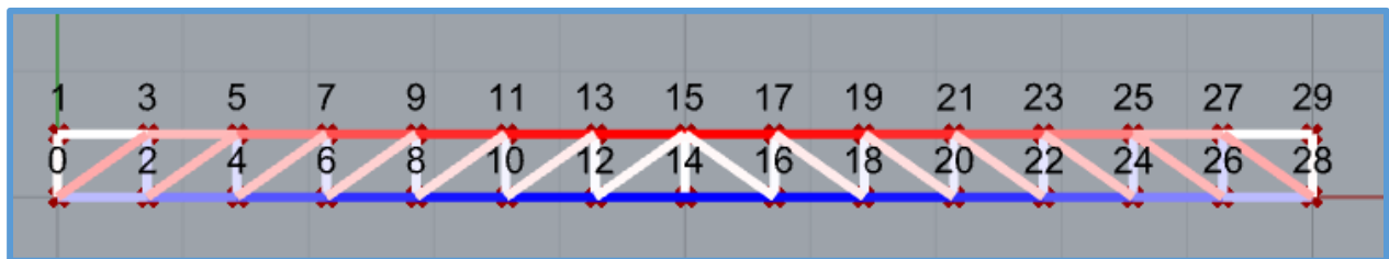
Figura 3.14. Armadura plana tipo Howe con código gráfico del análisis estructural - ejemplo N°1.
