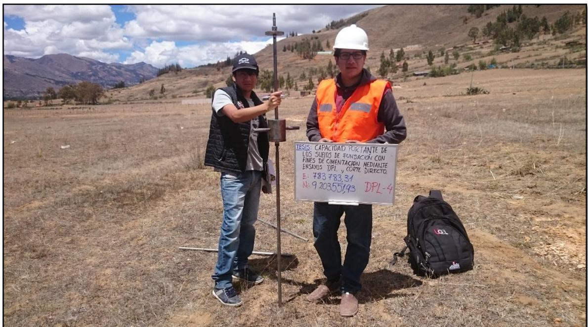
**Fotografía 12:** Ensayo de Penetración Dinámica Ligera 4. (DPL-4).
