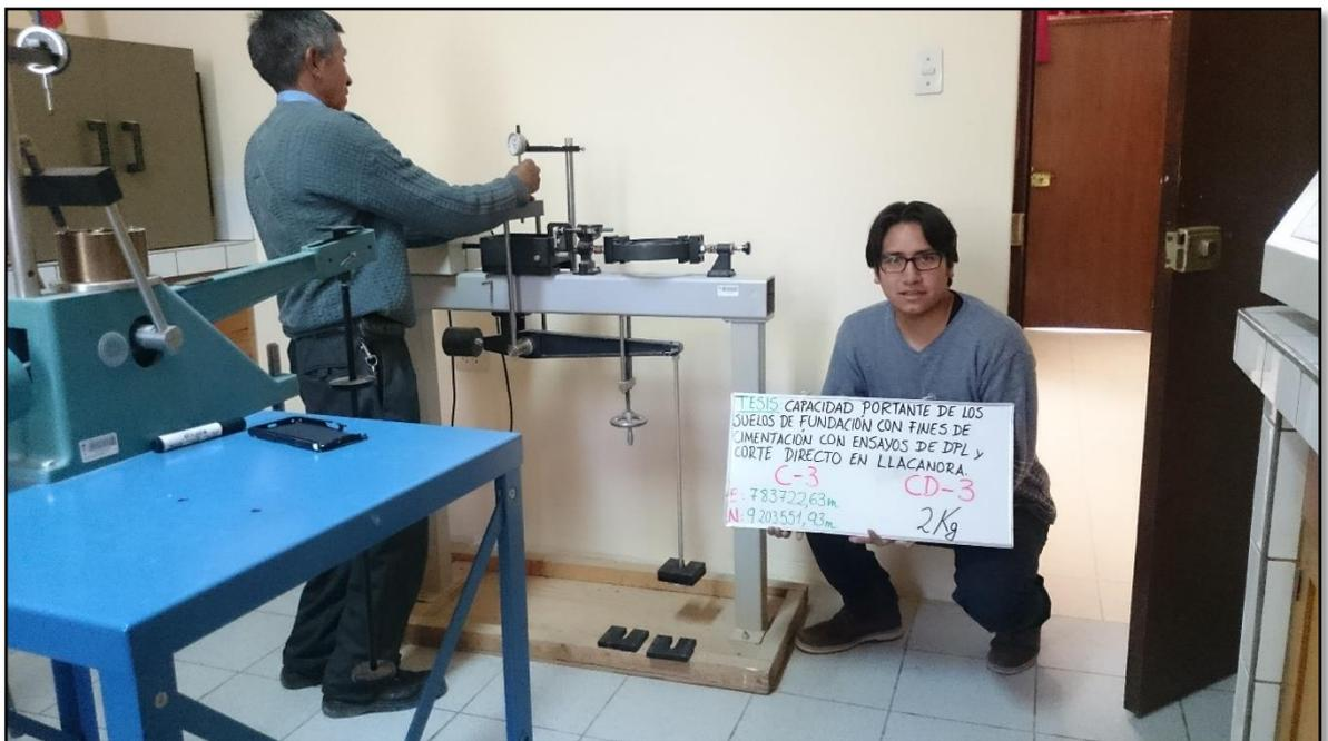
**Fotografía 24:** Ensayo de Corte directo N°03. (CD-3)
