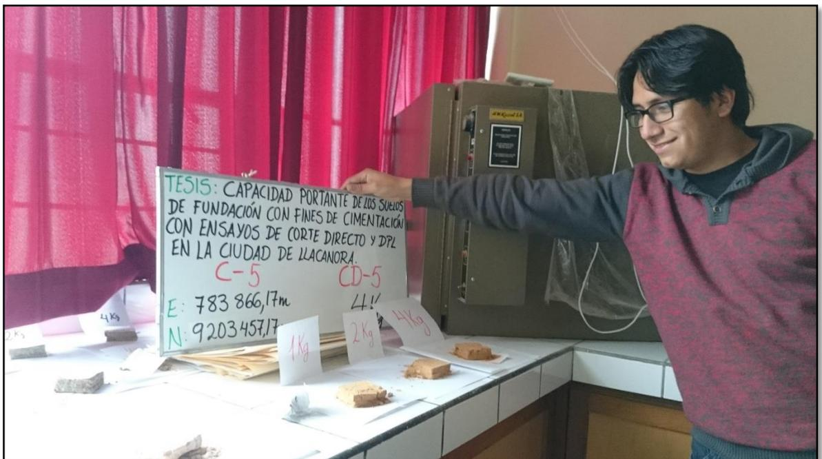
. **Fotografía 26:** Muestras después de Ensayo de Corte directo N°05. (CD-5)
