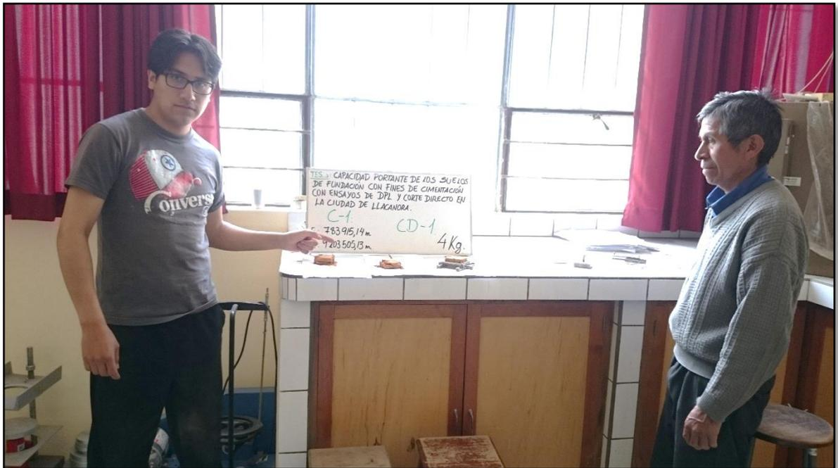
**Fotografía 22:** Muestras de Corte directo N°01 después de ensayo.
