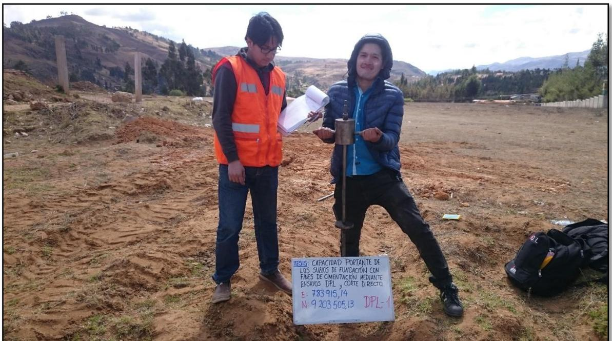
**Fotografía 06:** Ensayo de Penetración Dinámica Ligera 1. DPL-1.
