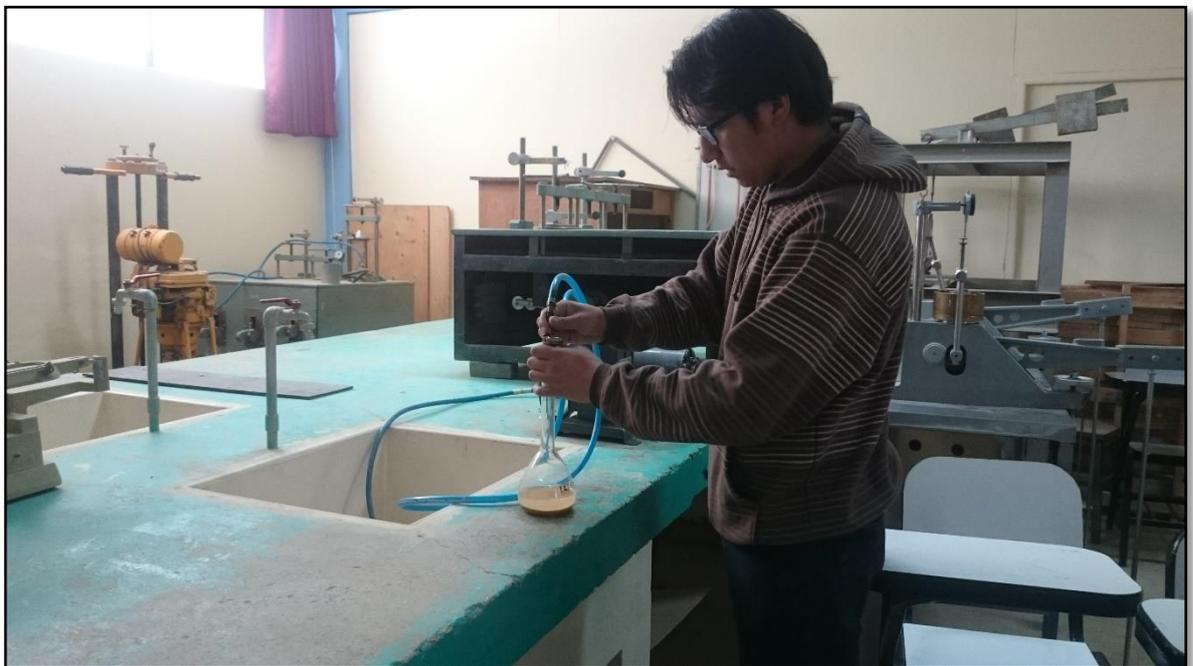
. **Fotografía 34:** Usando bomba de vacíos para determinar peso específico.
