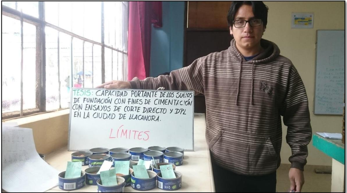
Fotografía 37: Taras que contienen las muestras usadas en límite líquido y límite plástico.
